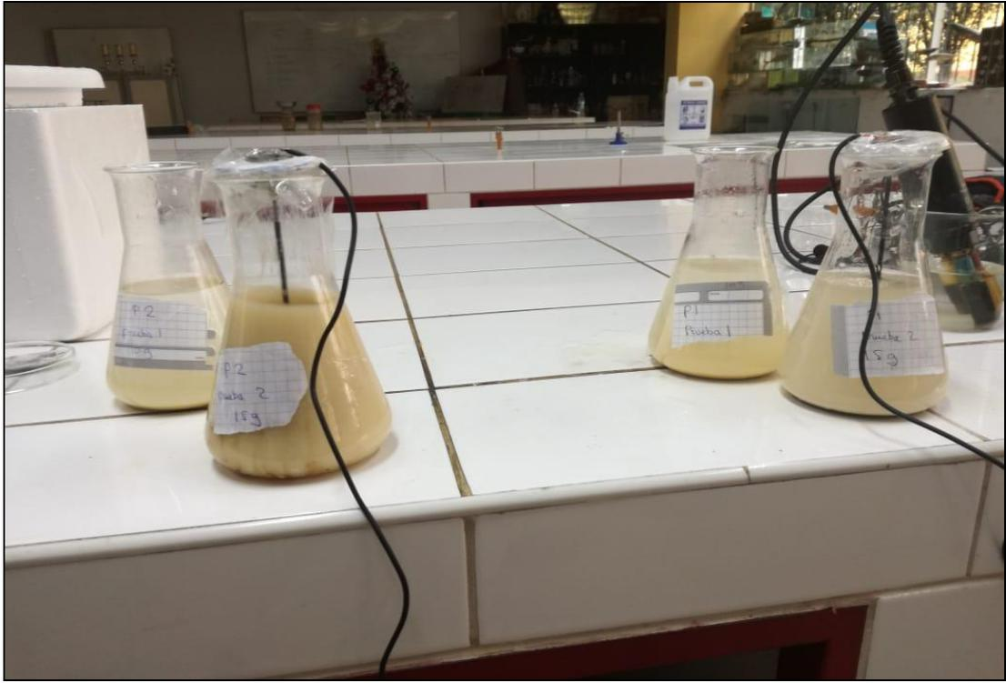
4. Finalizado el proceso de disolver las muestras con la dolomita se dejó reposando para la precipitación de los sólidos durante 6 horas, para posterior realizar la medición de los parámetros físicos como el pH final y Conductividad tal como se puede observar en la imagen N° 13.
