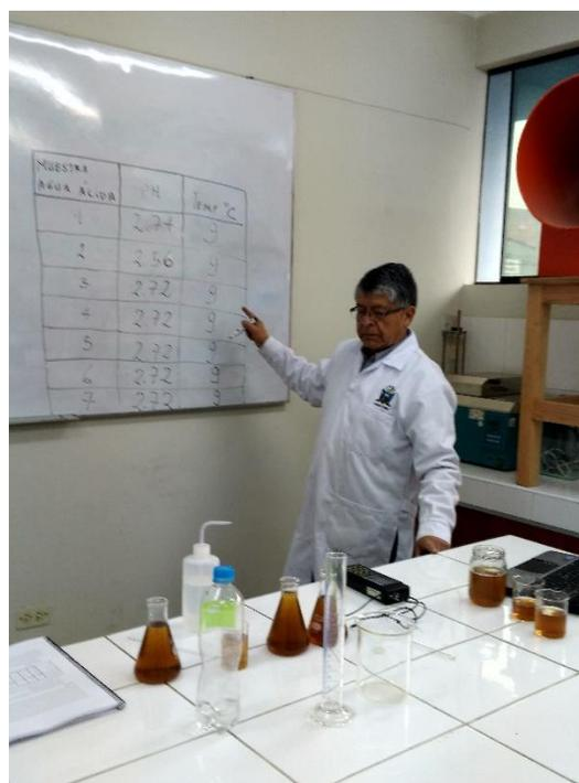
Figura 04 y 05. Determinación del PH de las aguas ácidas del depósito de relaves Quiulacocha.
