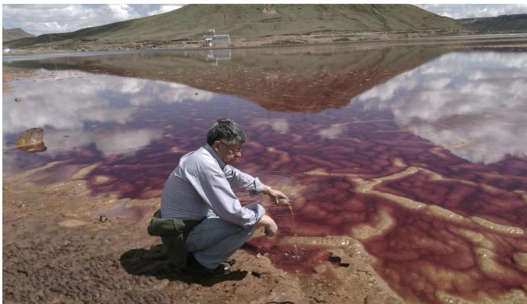
Figura 03. Toma de muestras de agua ácida del depósito de relaves de Quiulacocha.
