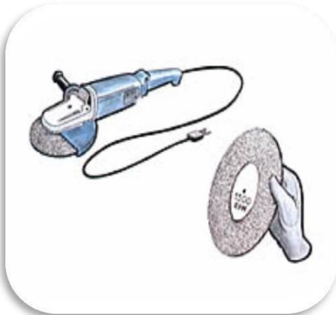
El esmeril angular es una herramienta eléctrica de gran uso en las faenas en construcción. Se emplea para cortar o desbastar distintos tipos de materiales, por medio de la rotación de un disco abrasivo, por ejemplo: perfiles de acero, cerámicos, baldosas, hormigón, etc.
