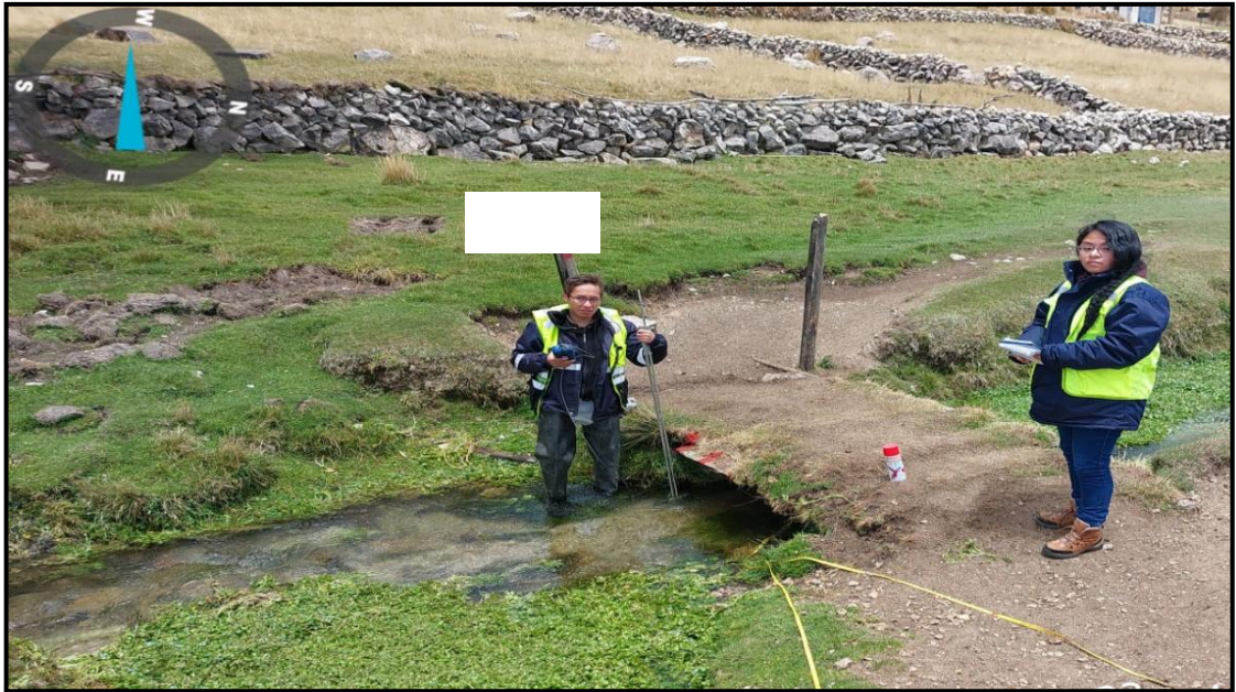
Imagen 12. Vista del uso de correntómetro para la medición de caudales
