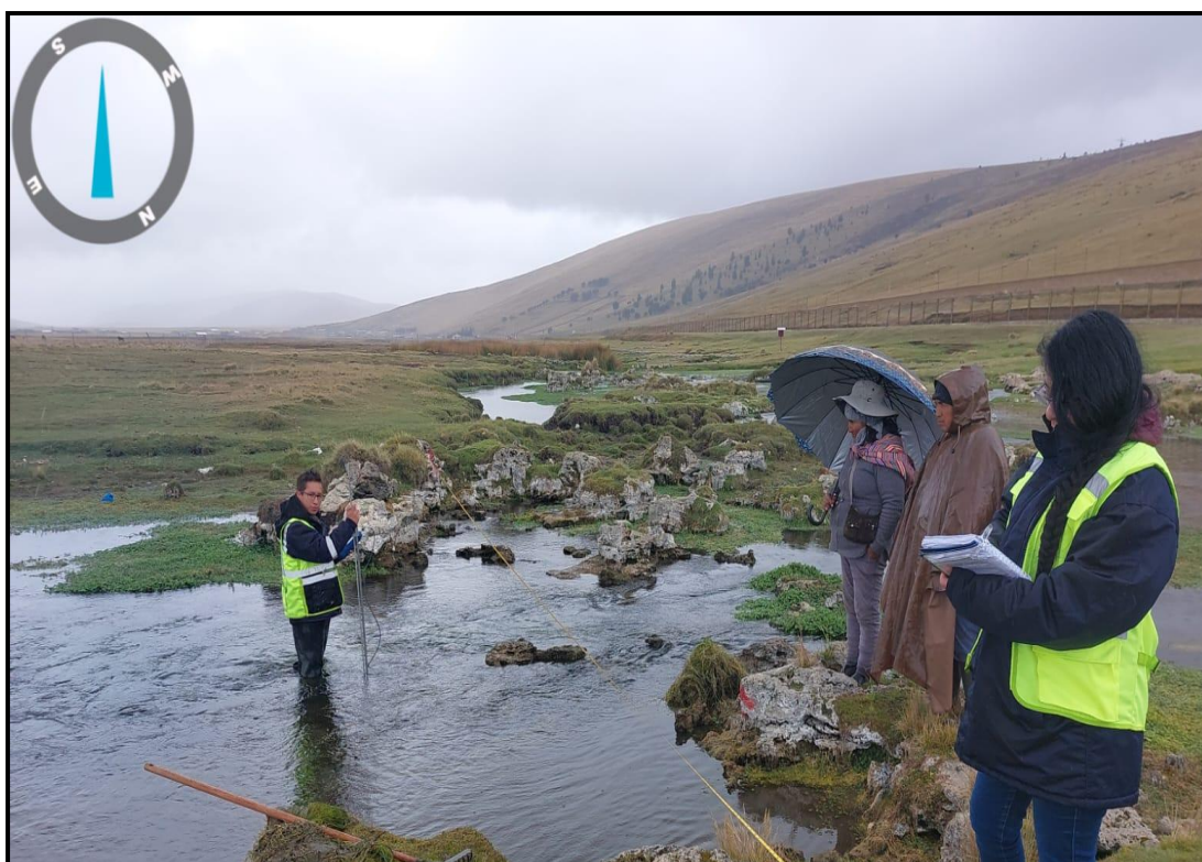
Imagen 14. Vista del uso de wincha y correntómetro en la medición de caudales
