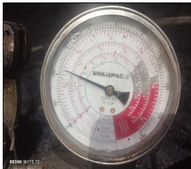
Figura 4. Corresponde a un manómetro hidráulico ENERPAC, instrumento utilizado para medir la presión hidráulica generada por la bomba durante la ejecución de un ensayo de extracción (Pull Test) en pernos de sostenimiento, como los Split Set, Swellex o pernos cementados
