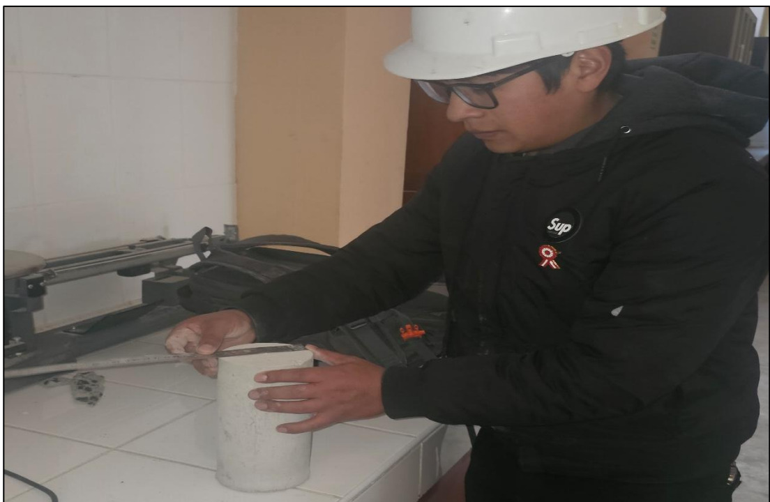
Fotografía 22. Medida del diámetro de la probeta.
