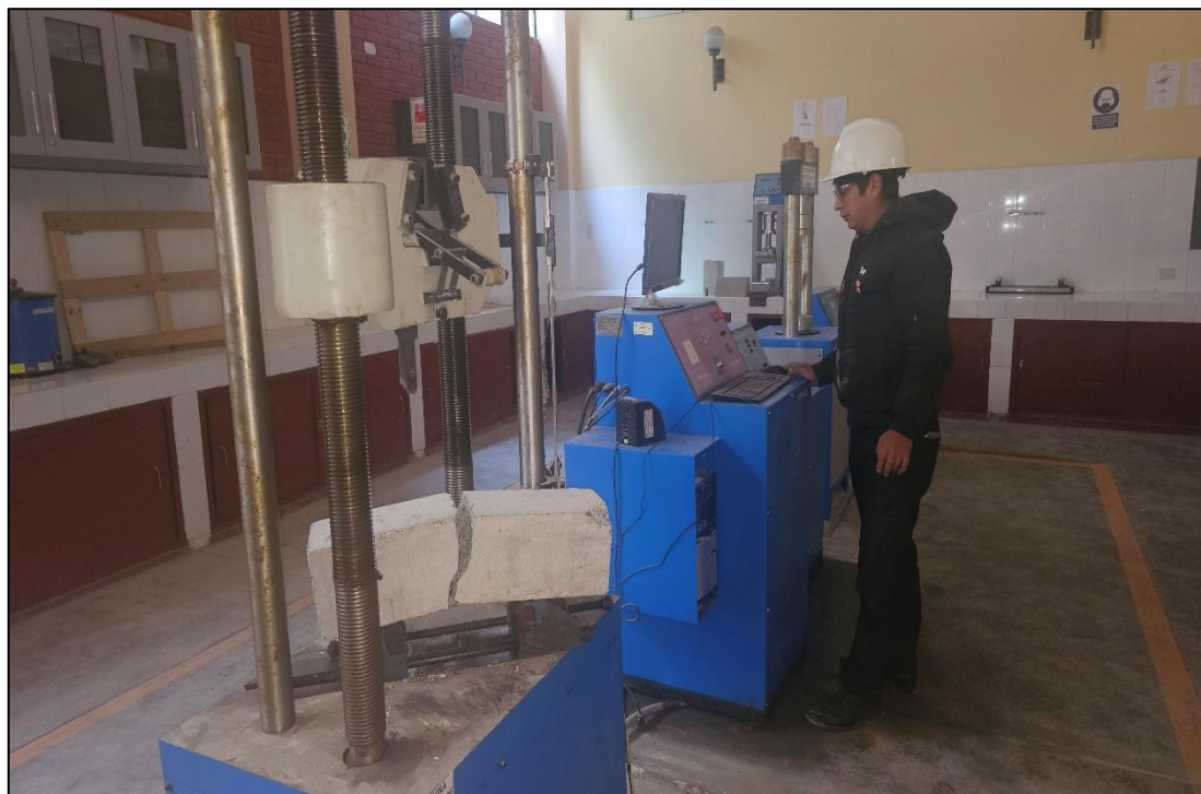
Fotografía 28. Ensayo de resistencia a la flexión (módulo de rotura).
