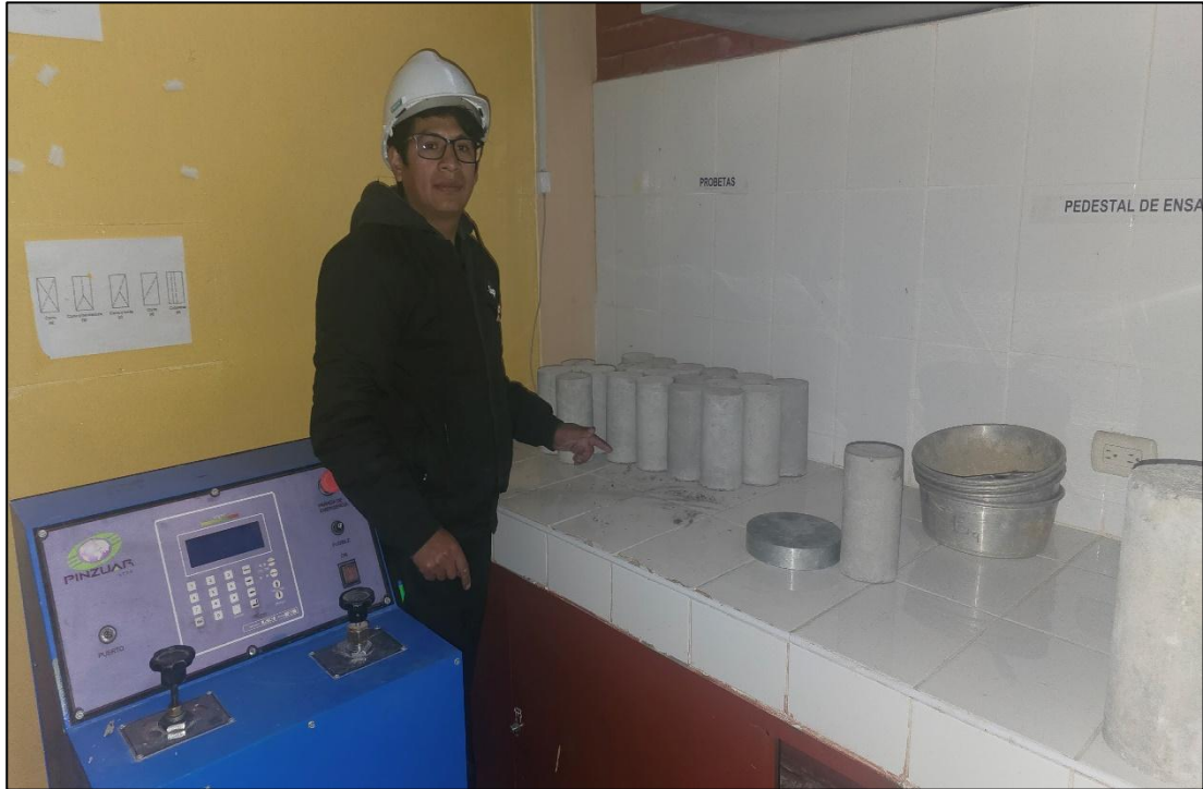
Fotografía 19. Probetas patron y patrones con soluciones salinas curadas.
