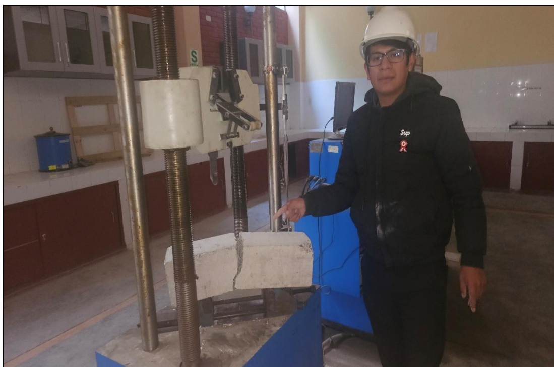
Fotografía 29. Rotura de viga, en el ensayo de flexión (módulo de rotura).
