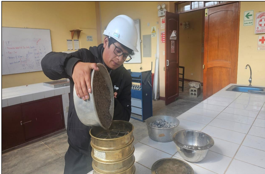
Fotografía 3. Inicio del ensayo granulométrico del agregado fino para el módulo de finura.
