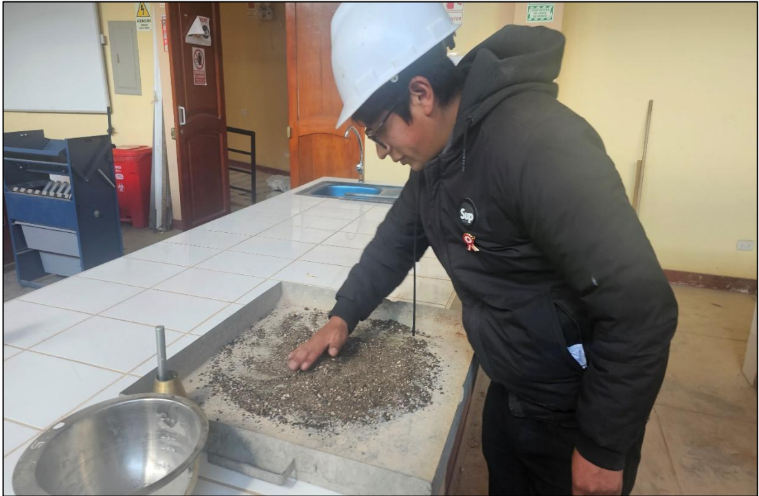
Fotografía 9. Ensayo de Absorción del agregado fino.
