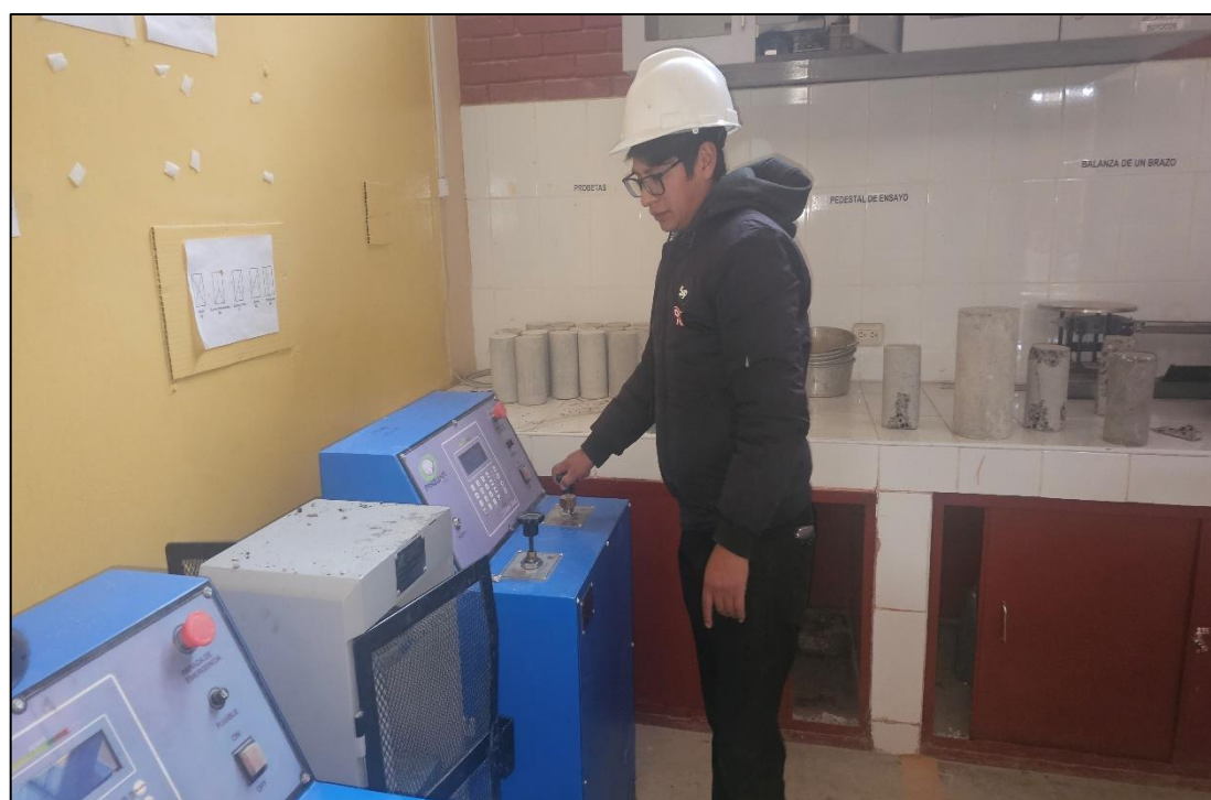
Fotografía 24. Ensayo de resistencia a compresión.
