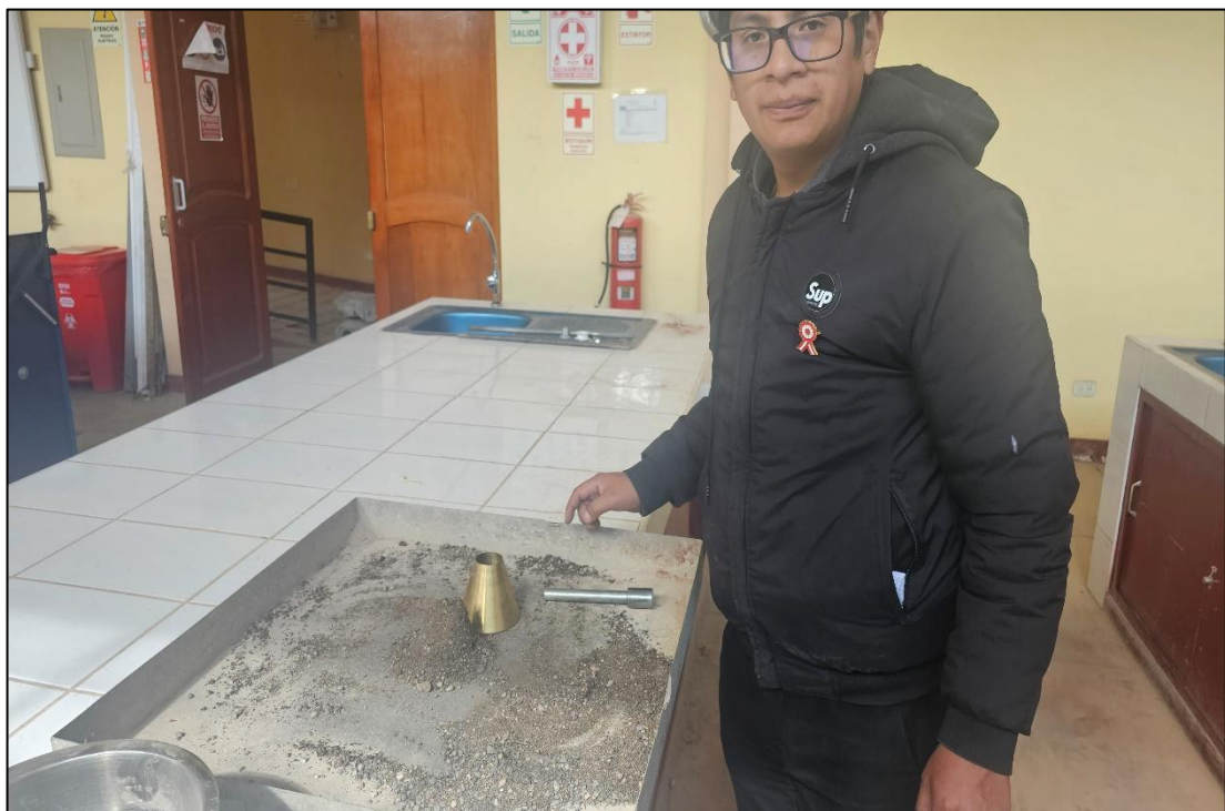
Fotografía 12. Resultados de los ensayos de Absorción de los agregados finos para el diseño de mezcla.
