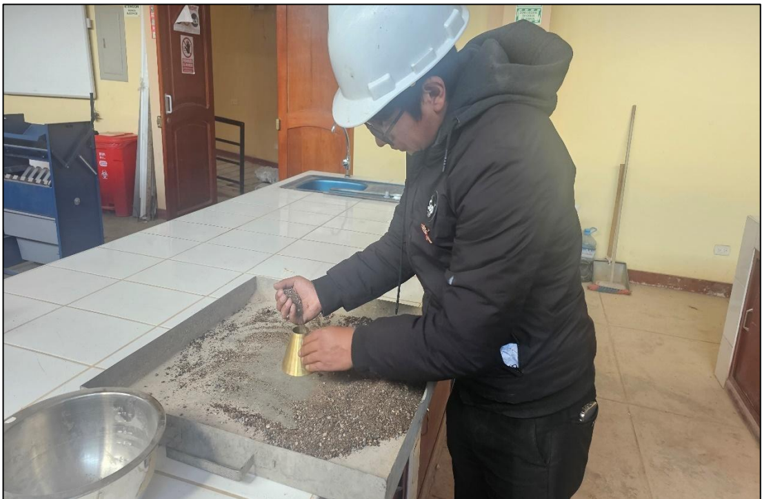
Fotografía 10. Realización del ensayo de absorción del agregado fino con el cono.
