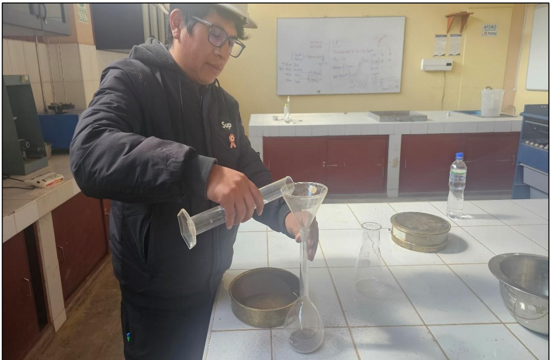
Fotografía 8. Ensayo del peso específico del agregado fino.
