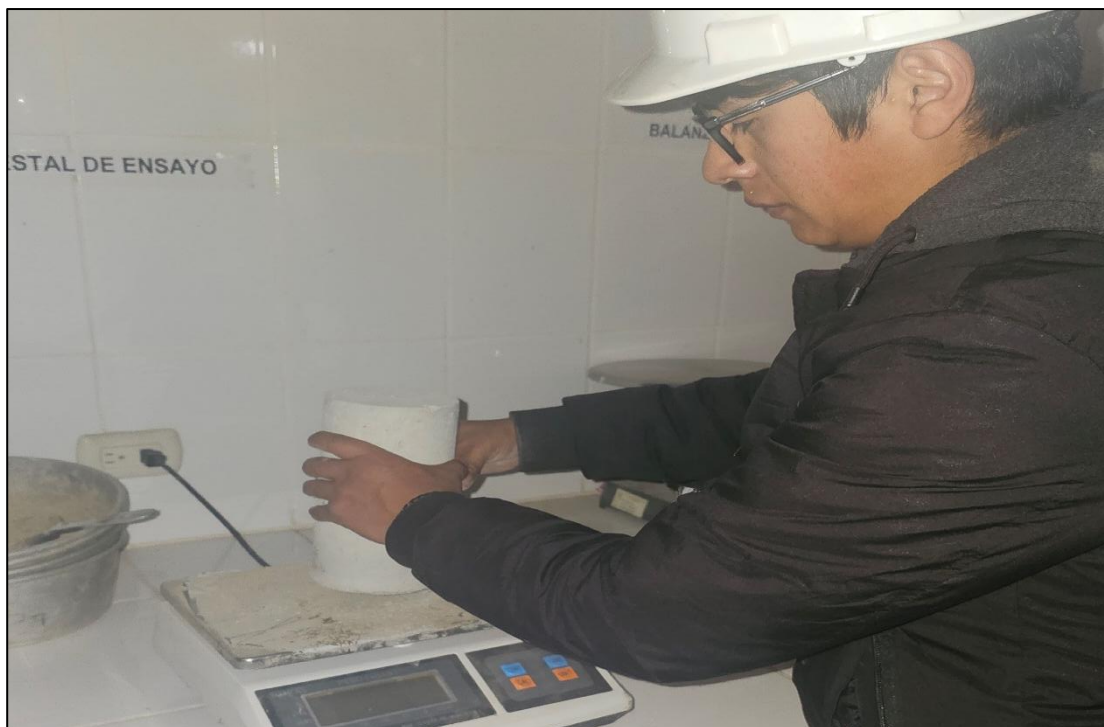
Fotografía 20. Peso de las probetas para el peso unitario.
