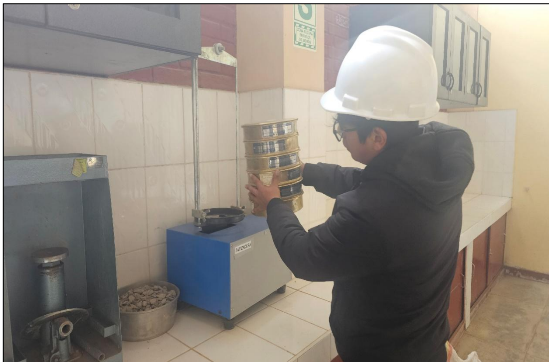
Fotografía 4. Ubicación de los tamices en la tamizadora para el ensayo de granulometría.
