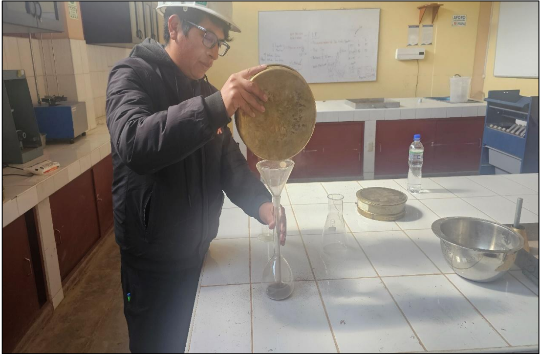
Fotografía 7. Ensayo del peso específico del agregado fino.
