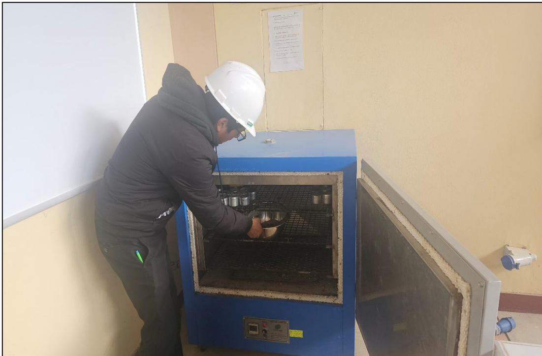
Fotografía 2. Colocación de los agregados en el horno, para su respectivo secado por 24 horas.
