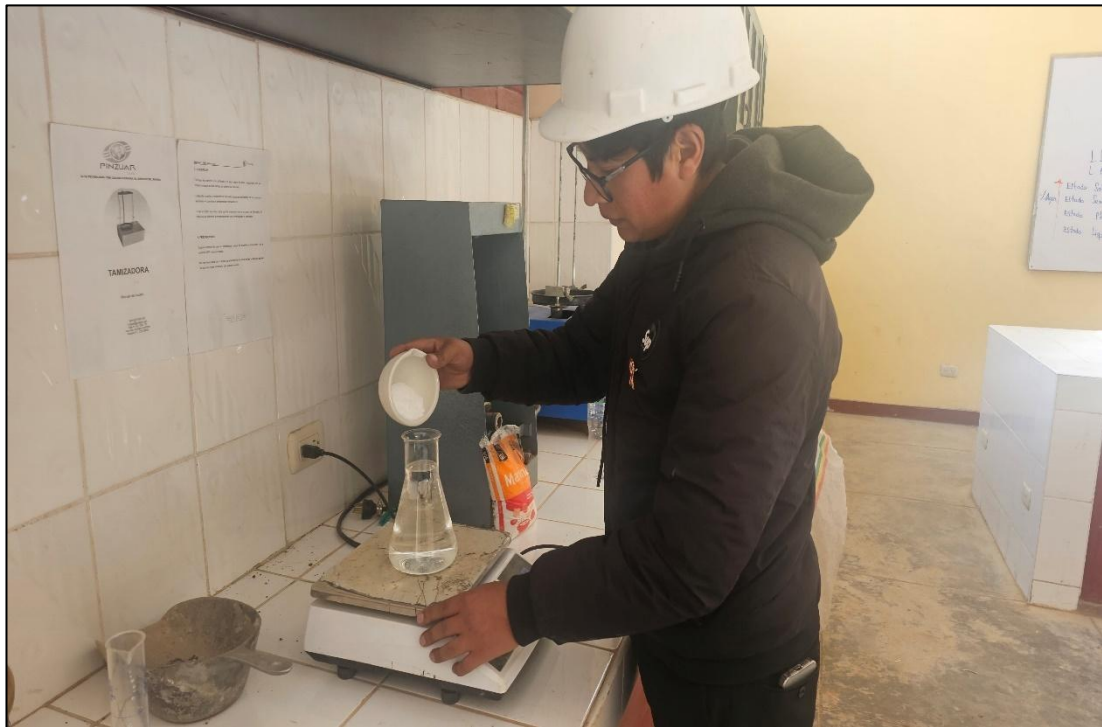
Fotografía 16. Combinación de agua y Cloruro de Sodio (Sal de mesa) para la solución salina.
