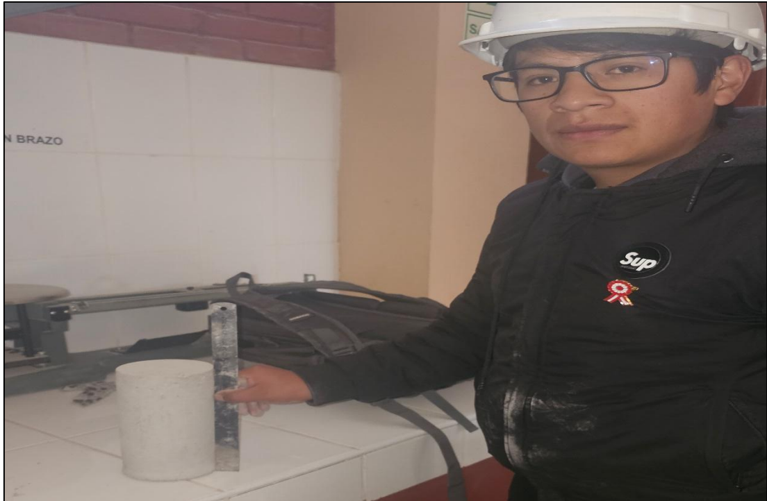
Fotografía 21. Medida de la altura de las probetas.
