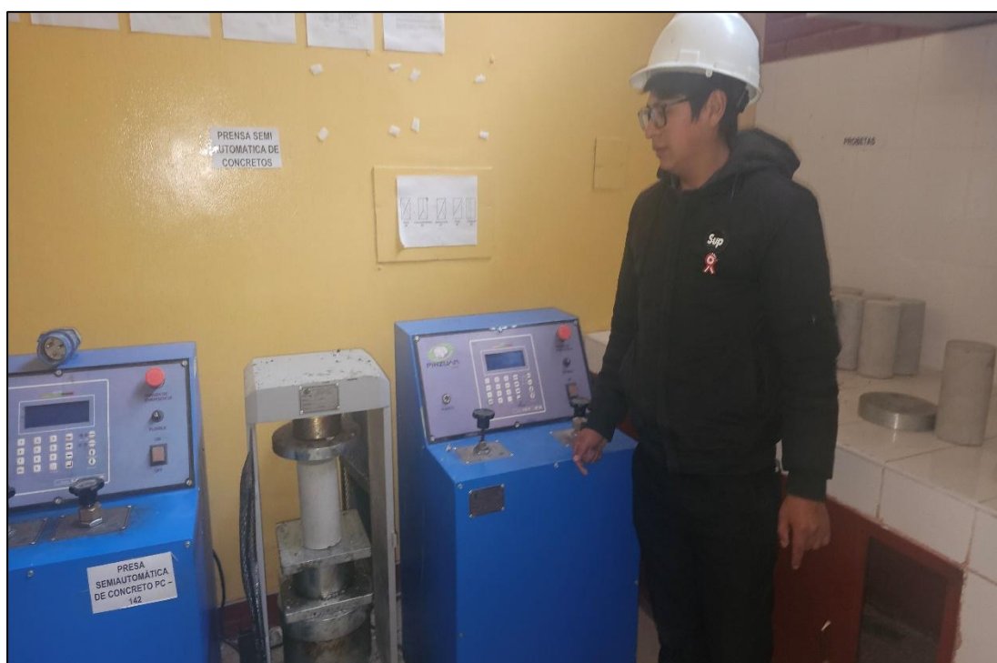
Fotografía 23. Preparación de la probeta para el ensayo a compresión.
