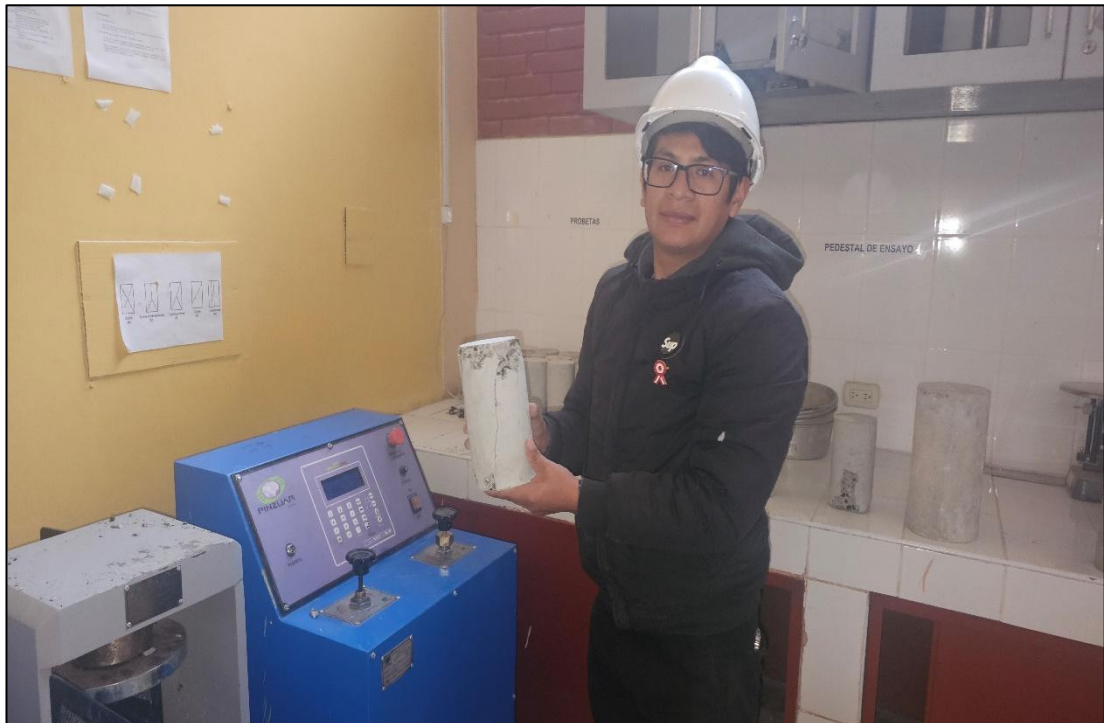
Fotografía 26. Corte en Y de una de las probetas.
