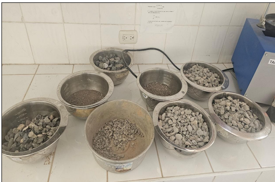
Fotografía 6. Se inicia el ensayo del peso específico y absorción del agregado fino.
