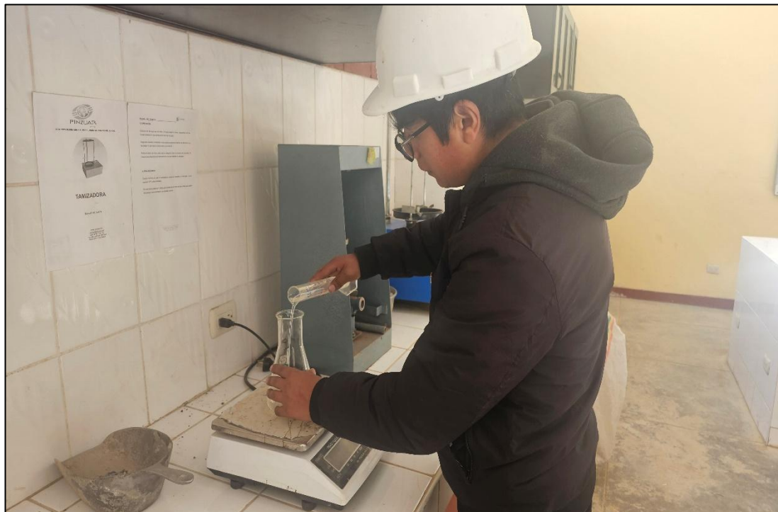
Fotografía 14 Peso del agua para la combinación con el Cloruro de Sodio (Sal de mesa).
