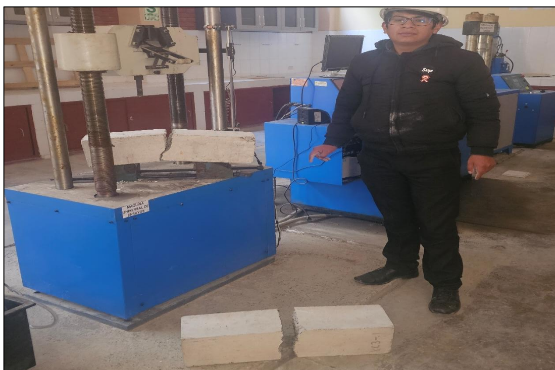
Fotografía 30. Resultados del ensayo de la resistencia a la flexión (módulo de rotura).
