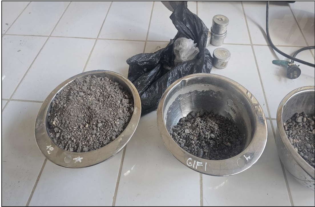
Fotografía 1. Cuarteo de los agregados para realizar los ensayos correspondientes.
