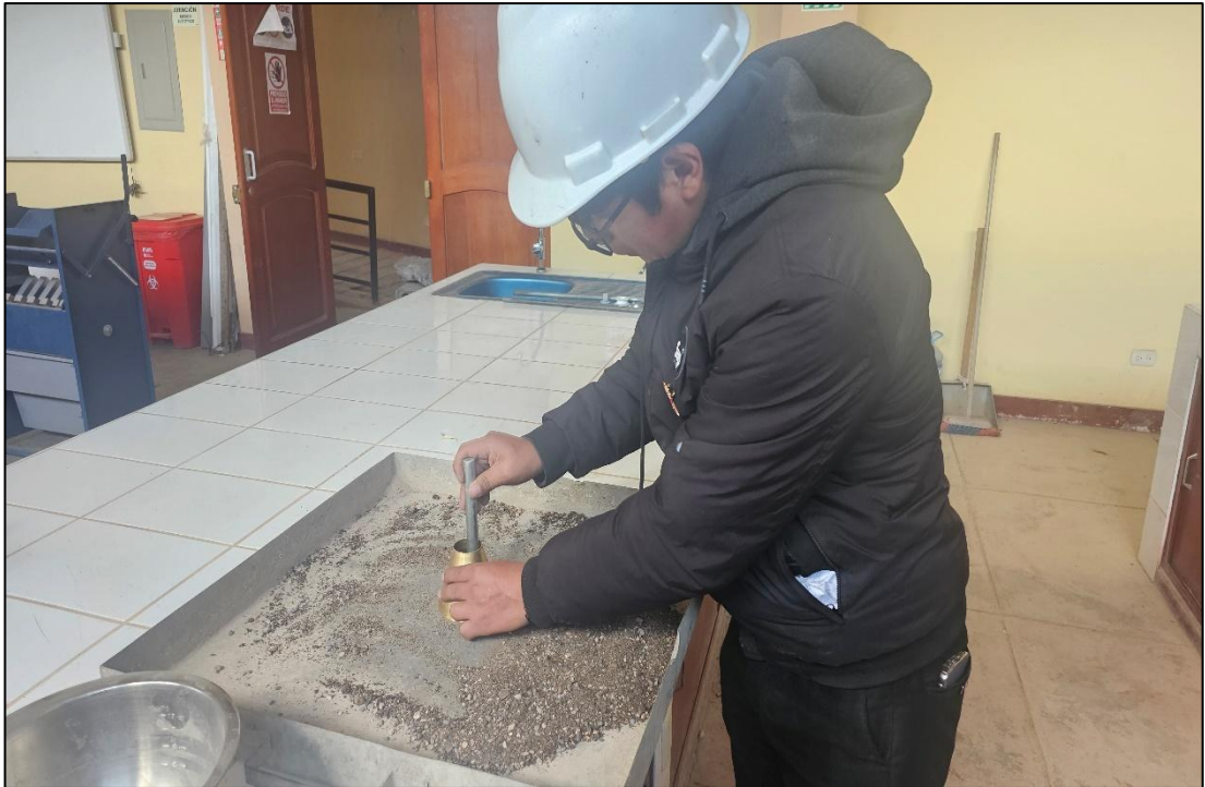
Fotografía 11. Ensayo de absorción del agregado fino, realizando los respectivos golpes en el cono.
