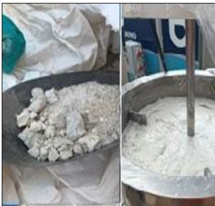
Figura 4. Preparación de lechada de cal al 15%
