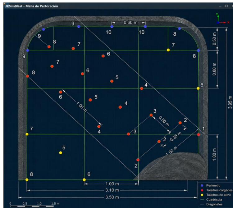
Figura 24. Malla de perforación y voladura diferenciada diseñada en Jk Simblas
