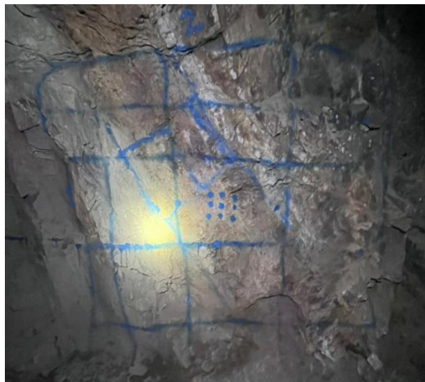
Figura 22. Malla de perforacion en campo
