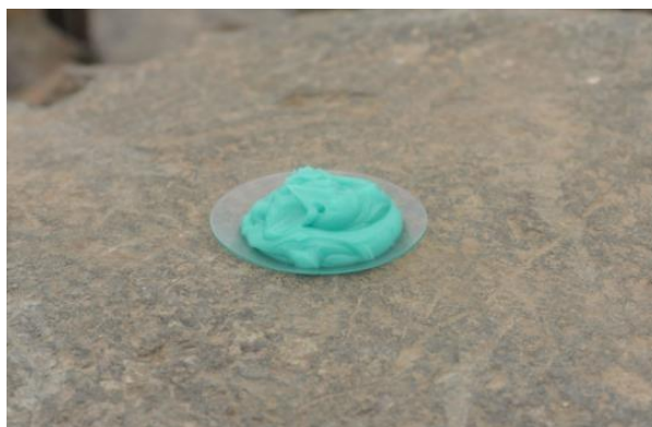
Figura 18. Emulsión gasificable – SAN G Apu
