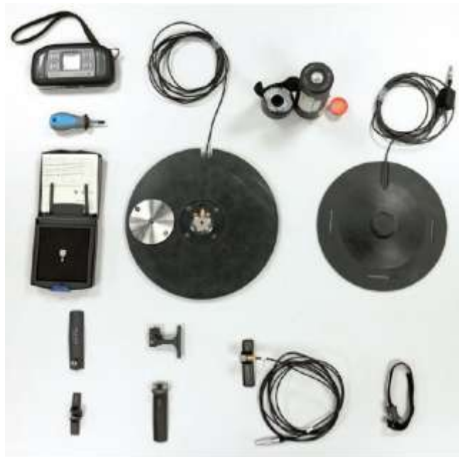
Figura 6. Ejemplo de vibrómetro con sus accesorios
