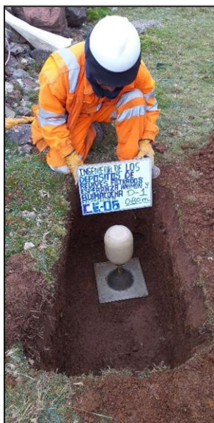
Foto N°12: Ensayos de densidad con cono de arena en la calicata CE-06
