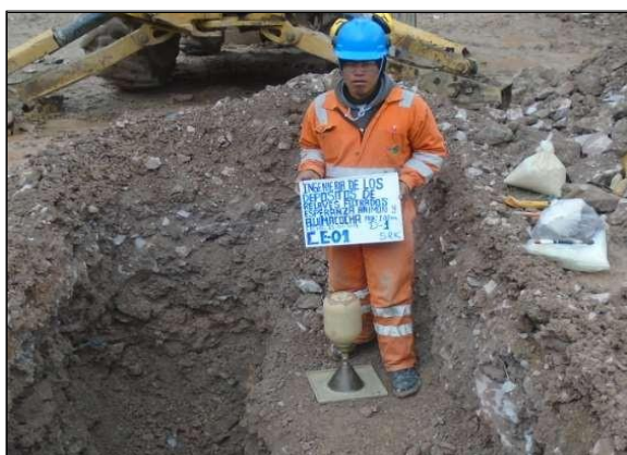
Foto N°02: Ensayos de densidad con cono de arena en la calicata CE-01
