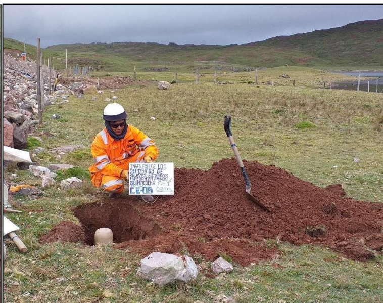
Foto N°12: Ensayos de densidad con cono de arena en la calicata CE-06
