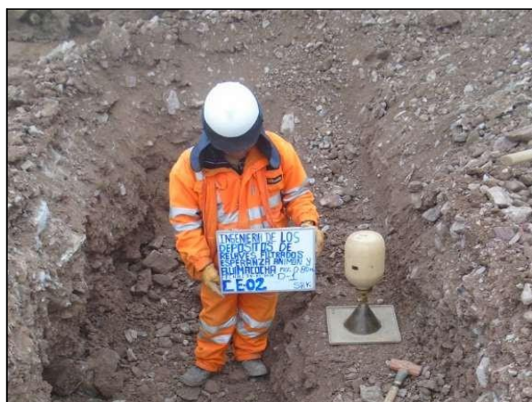
Foto N°04: Ensayos de densidad con cono de arena en la calicata CE-02
