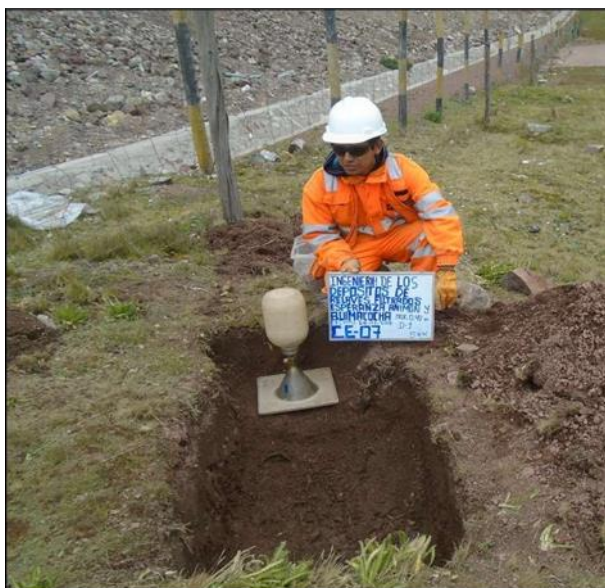
Foto N°14: Ensayos de densidad con cono de arena en la calicata CE-07 En la imagen se observa la densidad D-1 (prof. 0.40 m)
