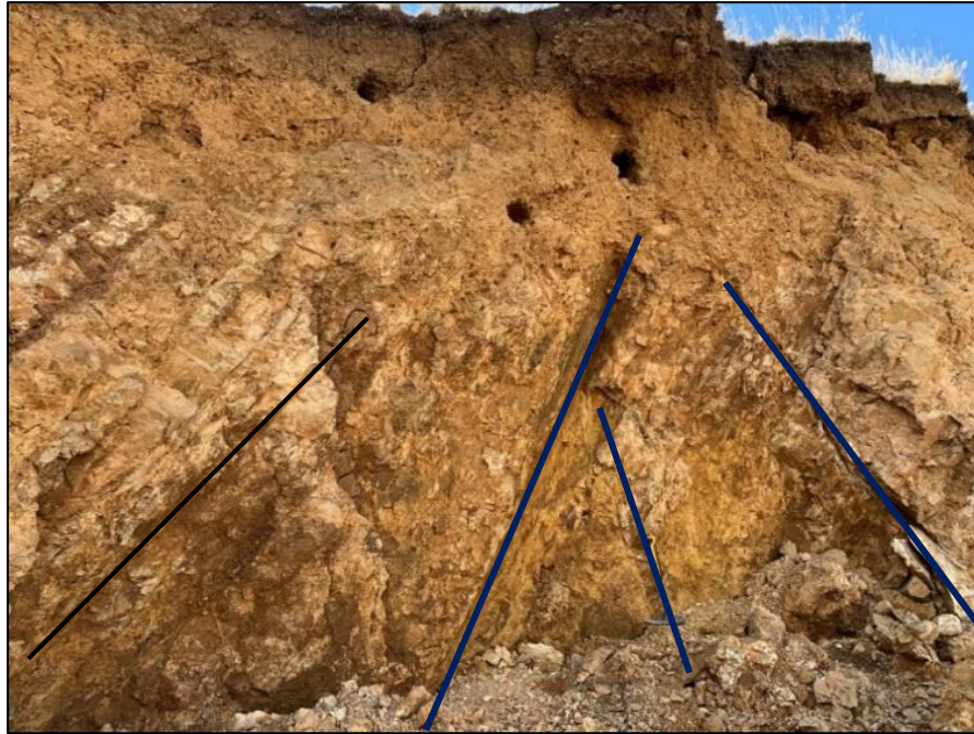
Fotografía 13: Km. 28+880. Zona de falla en corte de carretera, en calizas del Grupo Pucará, con los principales planos de falla (azul) paralelos al plano de estratificación (negro).
