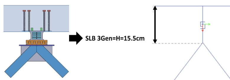
Figura 47. Modelo Nlink del disipador Shear Link.
