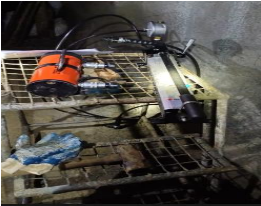
Figura 27 Gata de contraplacado de capacidad de 20 TM.
