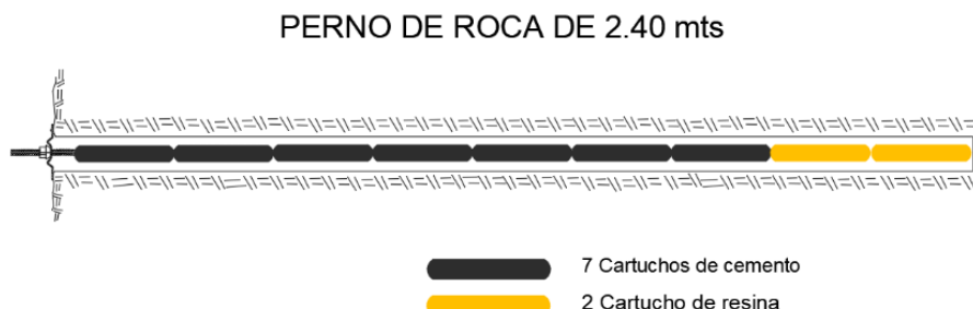
Figura N°3, Distribución de cartuchos cemento y resina para pernos de 2.40 m.
