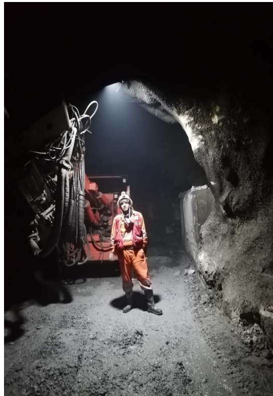
Figura 60. Apertura del Slot con Jumbo Hidráulico de 2 brazos
