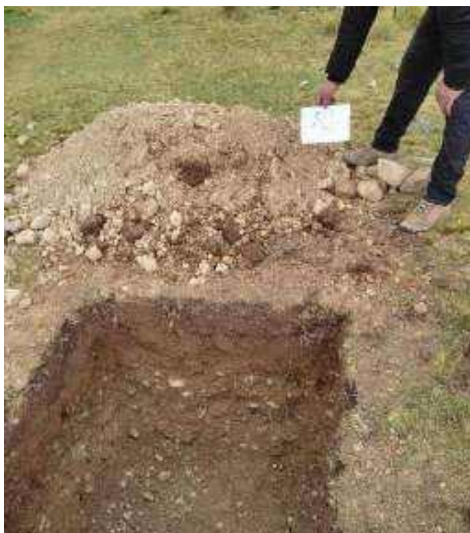
Foto 25. Vista panorámica de la exploración a base de calicata C-09
