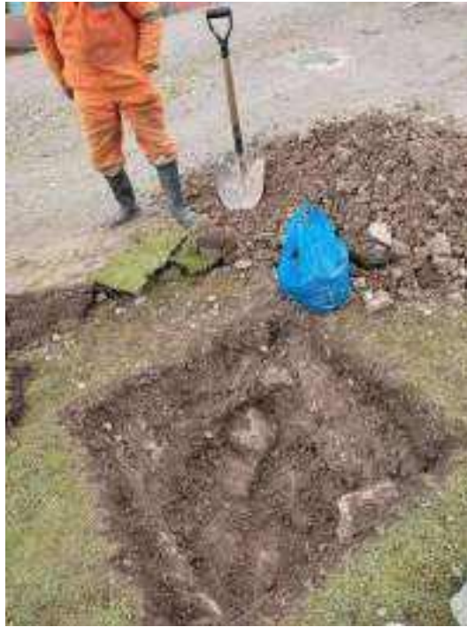
Foto 2. Calicata N°01, excavación a 0.50 m de profundidad a partir ahí se encuentra roca suelta y clastos anguloso de diámetro 10"
