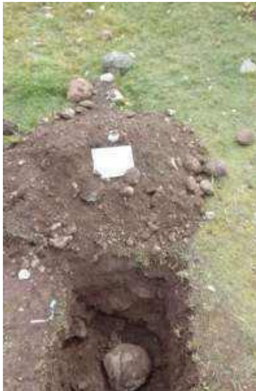
Foto 3. Vista de la exploración del suelo a base de calicatas C-01
