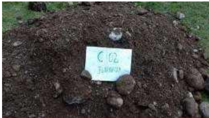
Foto 5. Calicata N° 02, excavación a 1.20 m de profundidad a partir de ahí se encuentra material roca suelta y cantos rodados de tamaño menor a 12"
