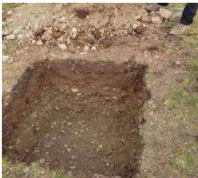
Foto 26. Calicata N° 09, excavación a 1.20 m de profundidad, a partir de ahí se tiene material cantos rodado con grava limosa de alta compacidad
