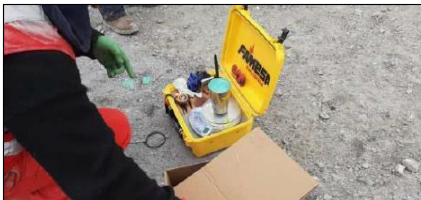
Figura 19. Comprobación de densidades en el TSG
