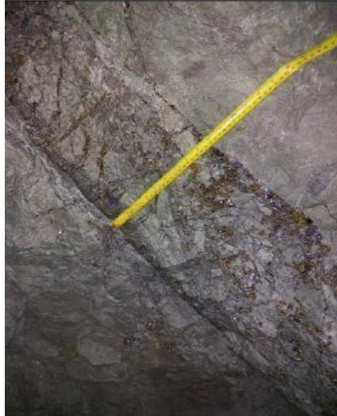
Figura 12. Veta Tensional, textura brechada, matriz rellena por sulfuros masivos, Sph-Gn
