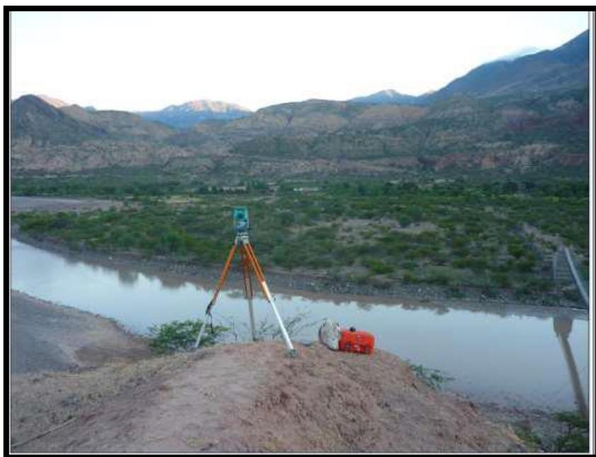
ANEXO N° 01: Instrumentos de recolección de datos (Estación Total utilizado en el levantamiento topográfico).
