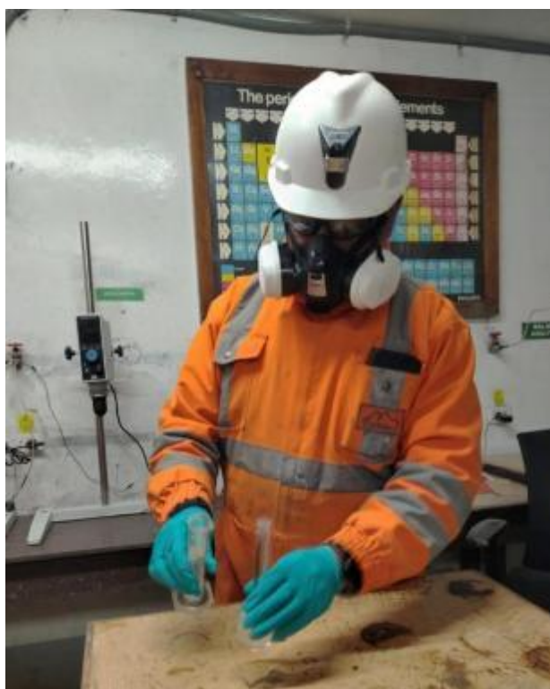
Ilustración 2 Preparación del ácido de Caro
