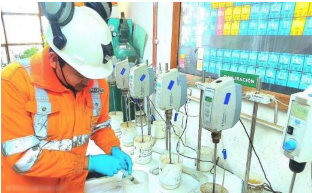
Ilustración 4 Pruebas experimentales de degradación del cianuro
