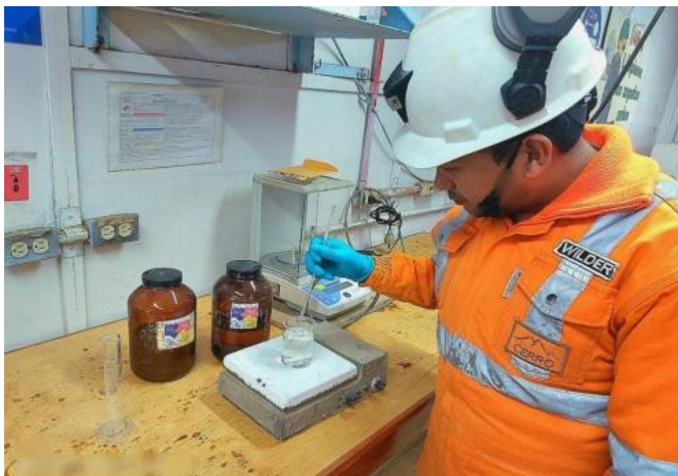
Ilustración 1 Preparación del ácido de Caro
