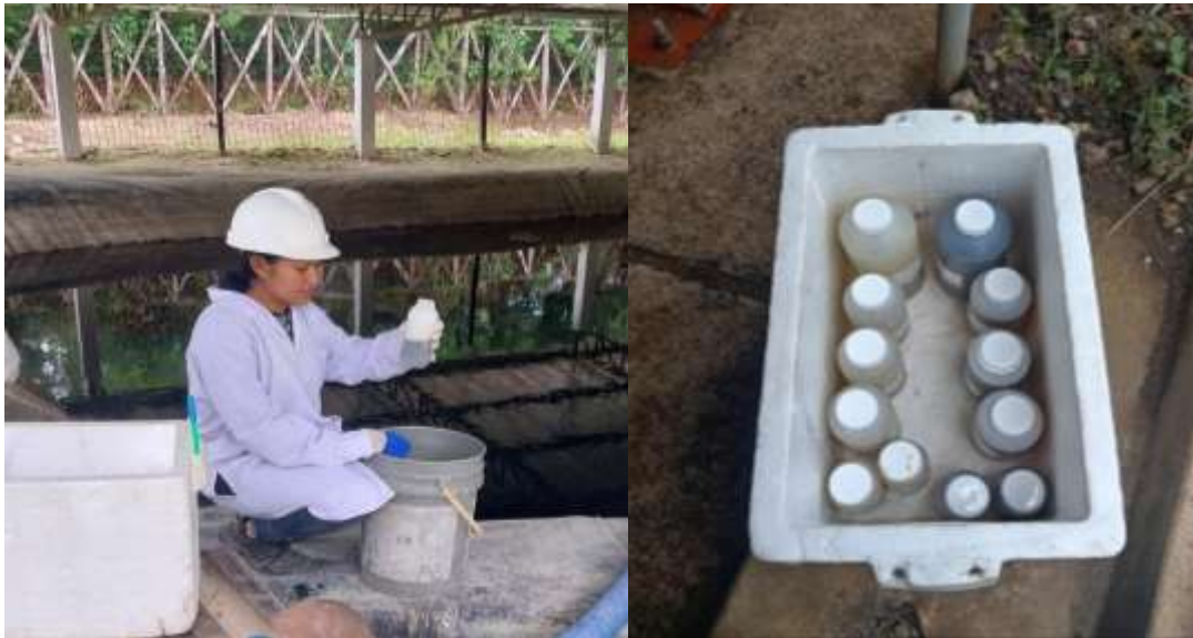
Foto E7. Muestreo de metales totales y parámetros químicos
