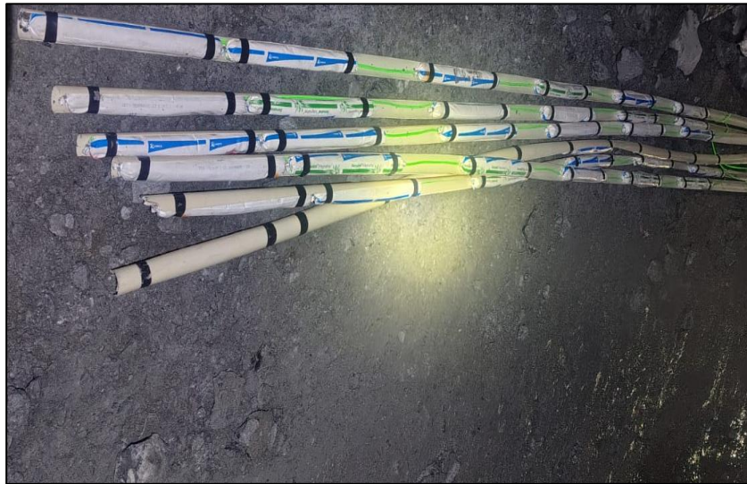
Armado de las cañas para controlar la corona de la labor.
