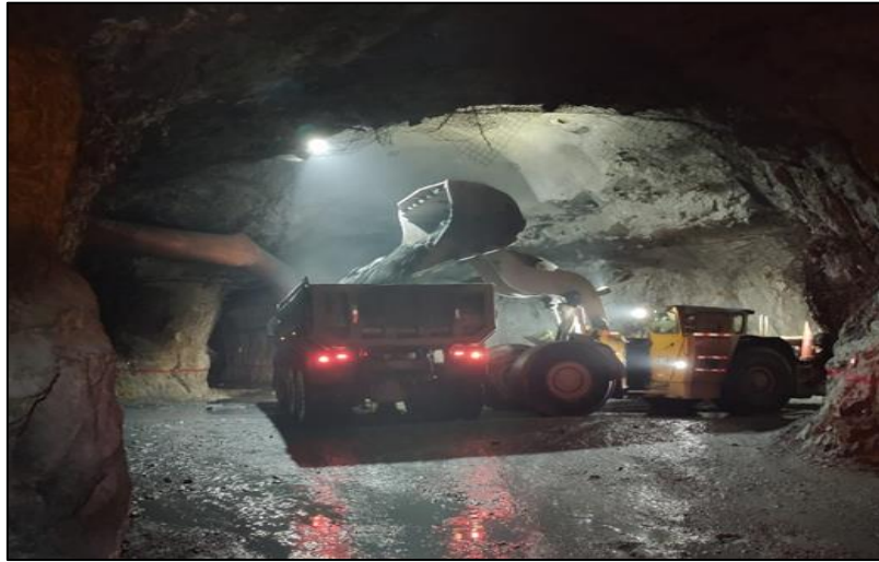
Figura 36 Limpieza y acarreo en la Unidad Minera el Porvenir.
