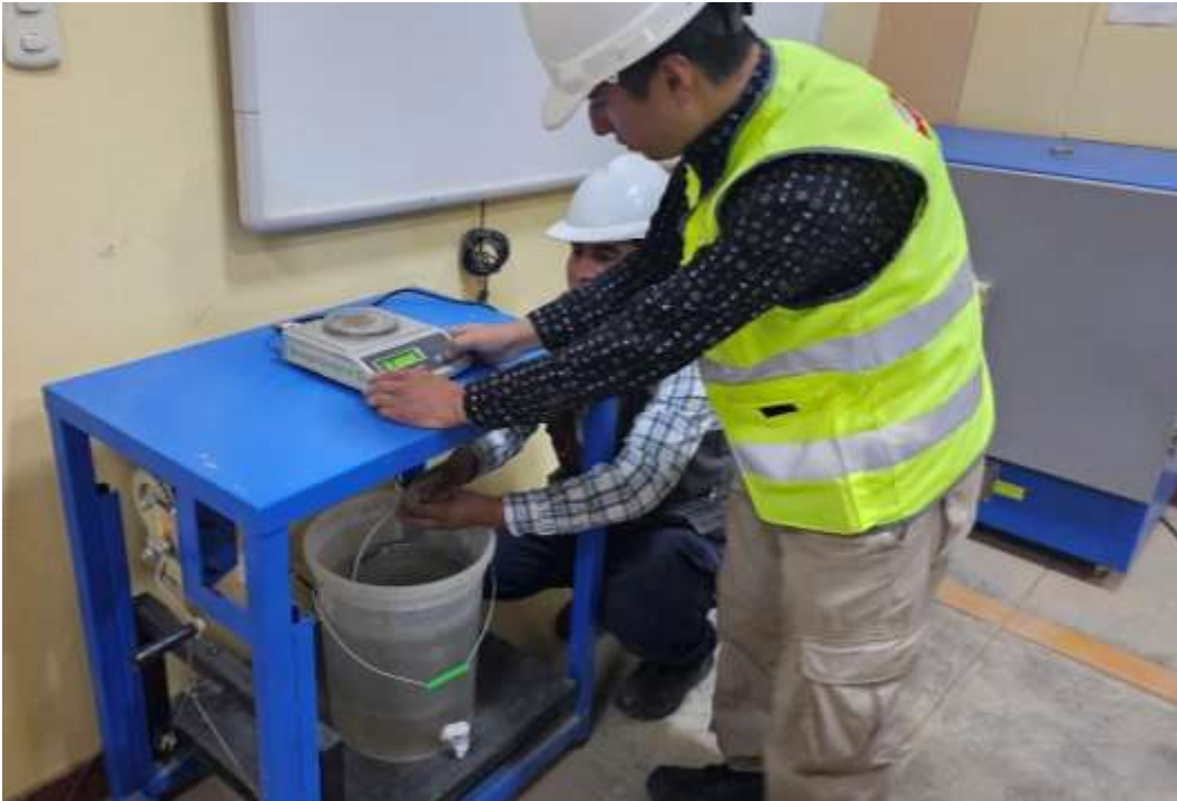
Fotografía 24. Realizamos el ensayo del peso específico y absorción del agregado grueso de la cantera Cochamarca con las respectivas normas técnicas vigentes.
