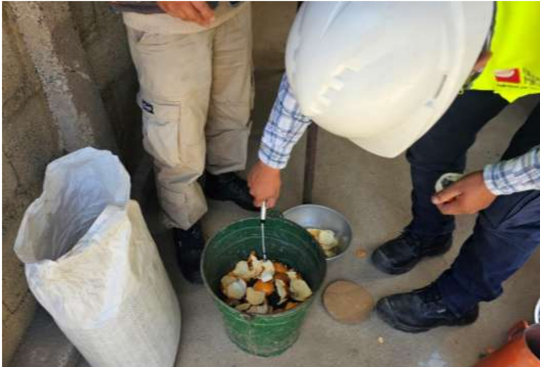
Fotografía 5. Se realiza el proceso de calcinación de las cáscaras de granadilla y convertirlo en cenizas para ser utilizado para los diseños de mezclas experimentales para esta investigación.
