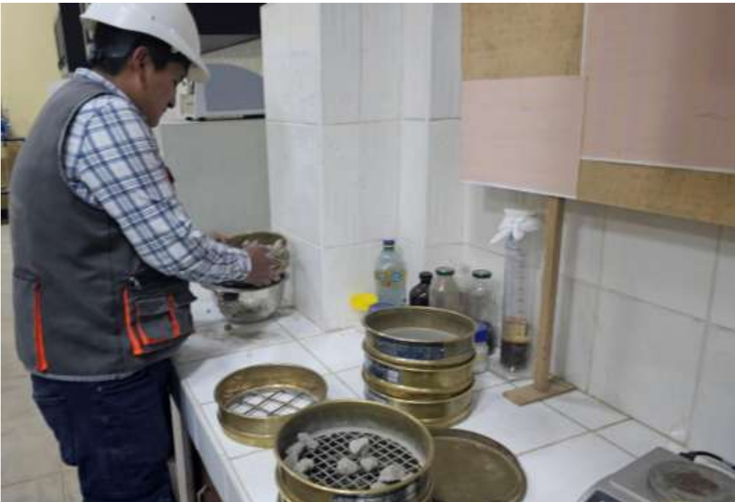
Fotografía 14. Se pesa cada agregado retenido en cada tamiz para obtener el módulo de finura del agregado grueso.
