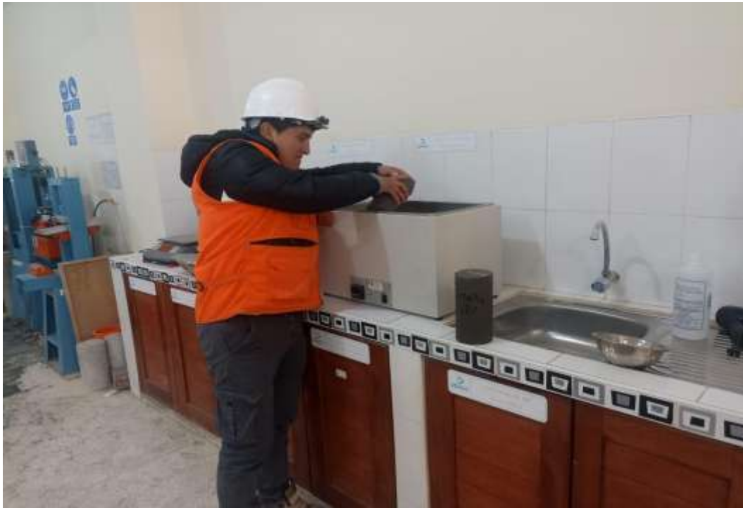
Fotografía 59. La imagen presenta la etapa de inmersión de las probetas de concreto, realizada como parte del ensayo de absorción de agua para la evaluación de la durabilidad del material.
