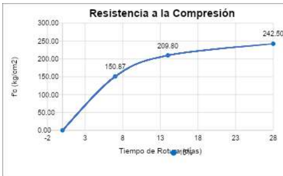
Figura 25. Curva de resistencia 210 kg/cm 2 del concreto experimental (patrón 15%)
