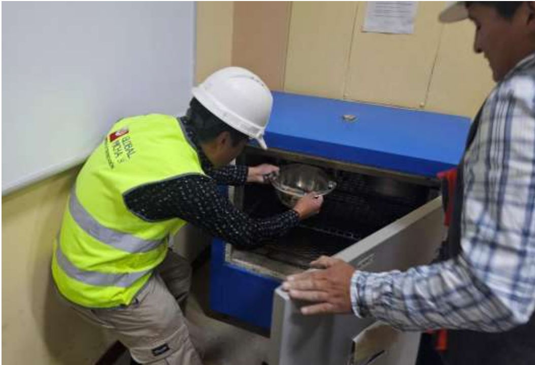
Fotografía 7. Se realiza el secado en el horno por 24 horas aproximadamente de los agregados grueso y finos extraídos de la cantera Cochamarca para realizar los ensayos correspondientes de acuerdo a norma.
