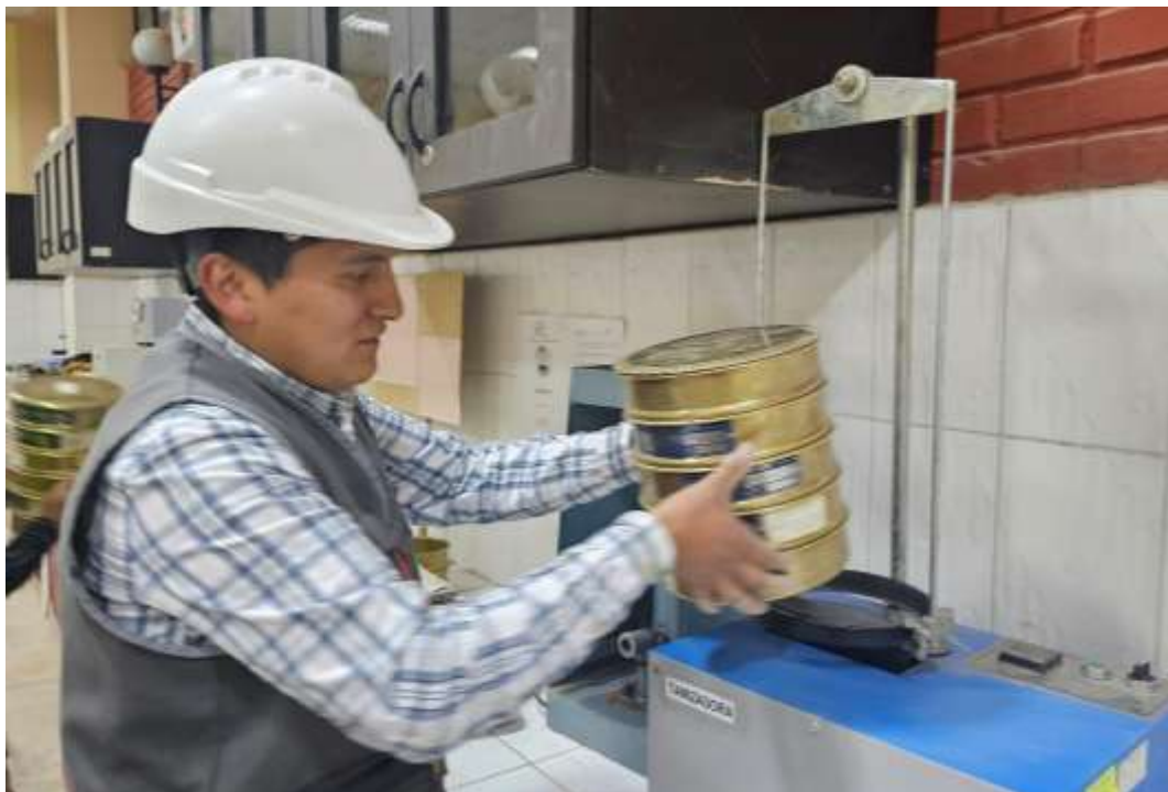
Fotografía 12. Tamizamos el agregado grueso para obtener las cantidades de agregados por tamiz para el ensayo de granulometría y obtener el módulo de finura.
