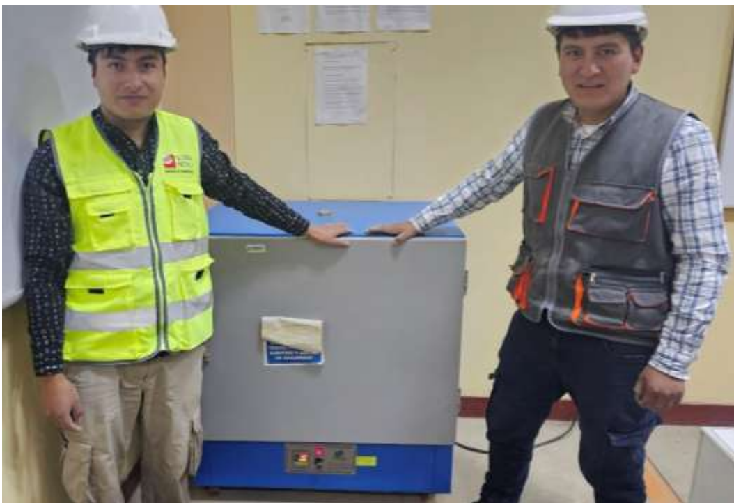
Fotografía 8. Se realiza el secado en el horno por 24 horas aproximadamente de los agregados grueso y finos extraídos de la cantera Cochamarca para realizar los ensayos correspondientes de acuerdo a norma.
