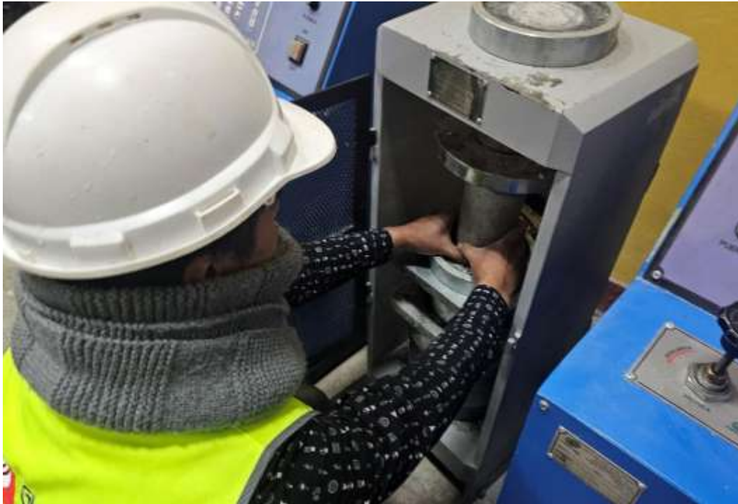
Fotografía 51. Preparamos las probetas generales y experimentales para realizar los ensayos de compresión y tracción y así obtener la resistencia de cada probeta.
