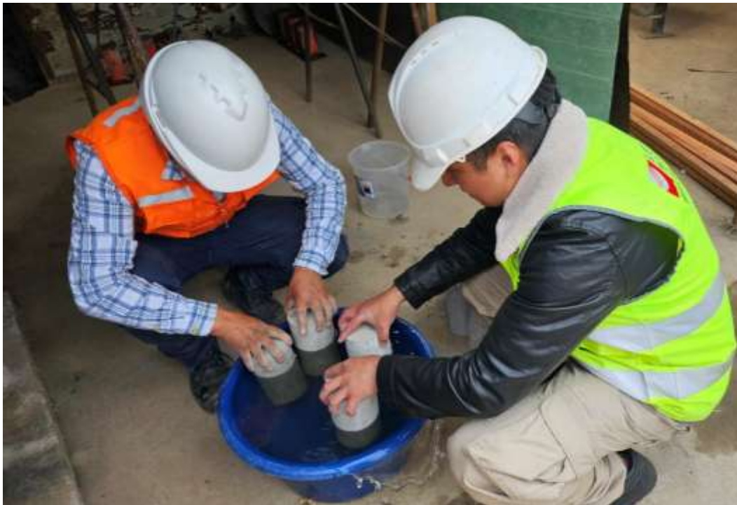
Fotografía 48. Sumergimos las probetas del concreto natural y experimental en agua graduada para su respectivo curado, para posteriormente realizar los ensayos de compresión, tracción y flexión.
