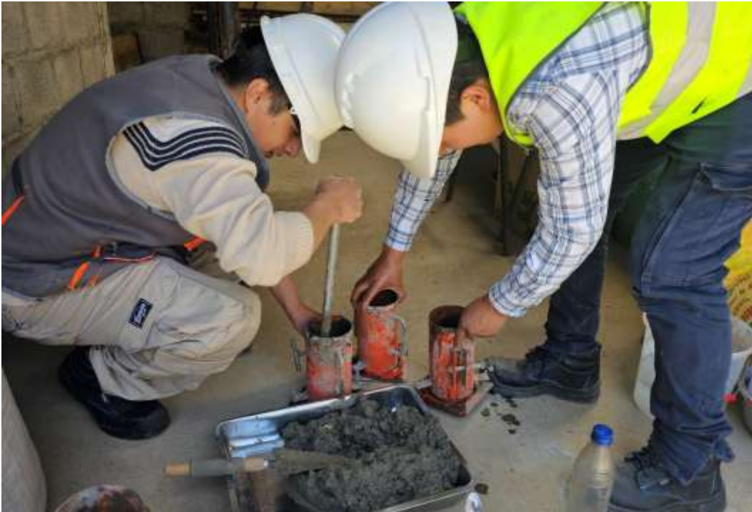
Fotografía 37. Empezamos a llenar los moldes de 10 cm x 20 cm con el concreto general mezclado para obtener probetas y hacer posteriormente los ensayos de compresión, tracción y flexión.
