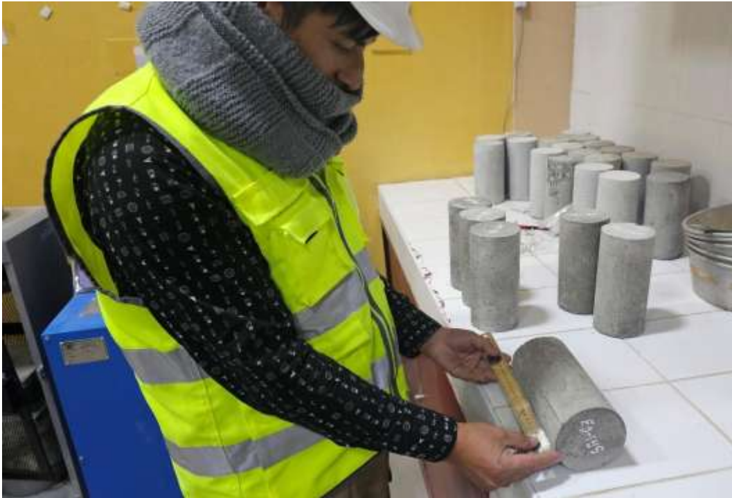
Fotografía 49. Empezamos a medir cada probeta, tanto su altura y su diámetro para hallar el peso unitario.
