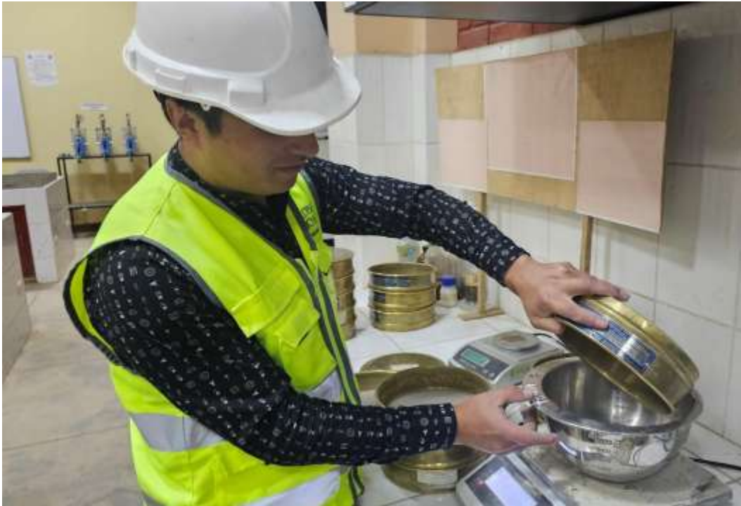
Fotografía 13. Se pesa cada agregado retenido en cada tamiz para obtener el módulo de finura del agregado fino.
