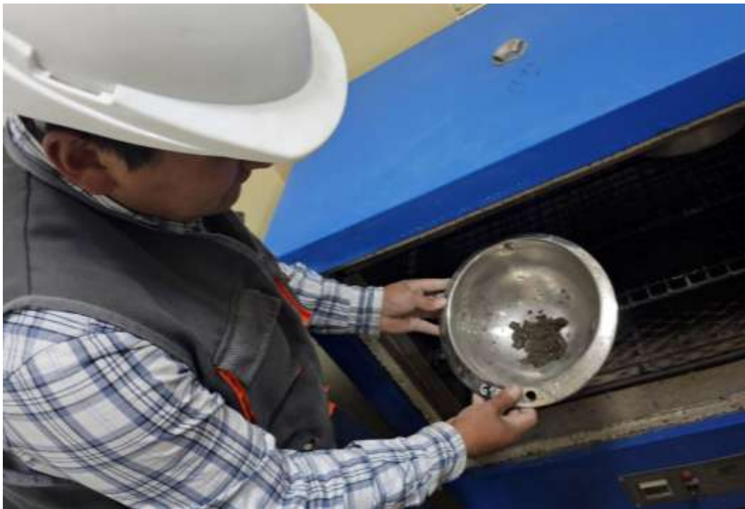
Fotografía 22. Resultados del ensayo del peso específico y absorción del agregado fino de la cantera Cochamarca con las respectivas normas técnicas vigentes.
