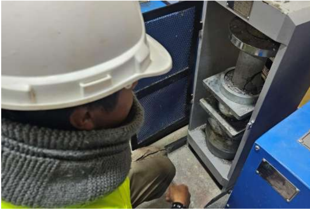
Fotografía 53. Obtenemos los resultados de los ensayos de resistencia a la compresión y tracción de cada probeta.
