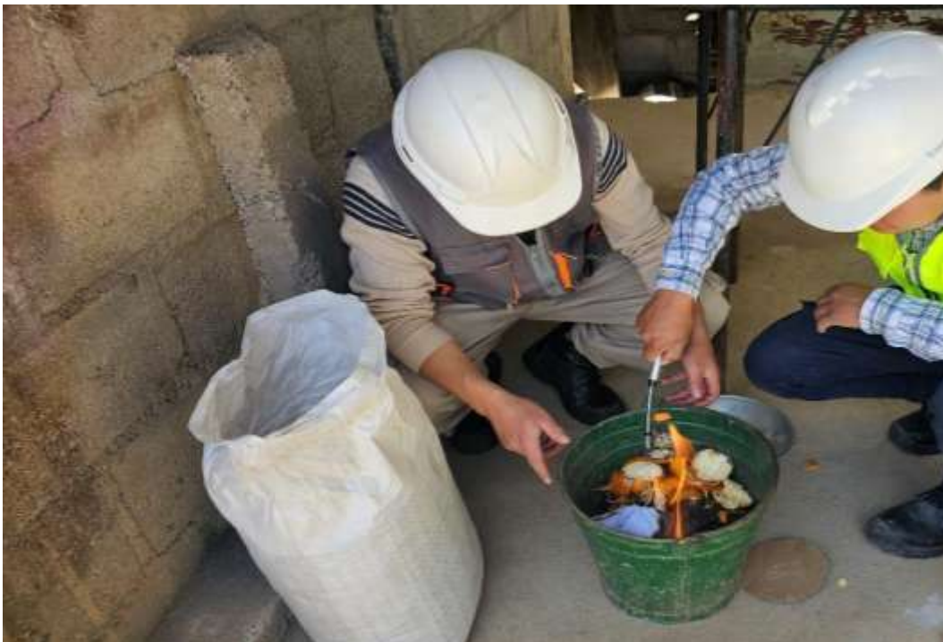
Fotografía 6. Se realiza el proceso de calcinación de las cáscaras de granadilla y convertirlo en cenizas para ser utilizado para los diseños de mezclas experimentales para esta investigación.
