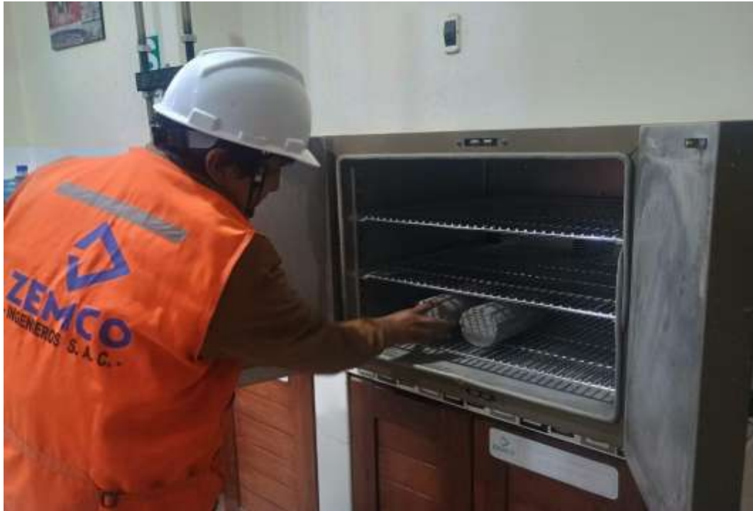
Fotografía 61. En la imagen se observa el proceso de secado de las probetas de concreto en horno, etapa necesaria para la determinación de la masa seca y el cálculo del porcentaje de absorción de agua en el ensayo de durabilidad.
