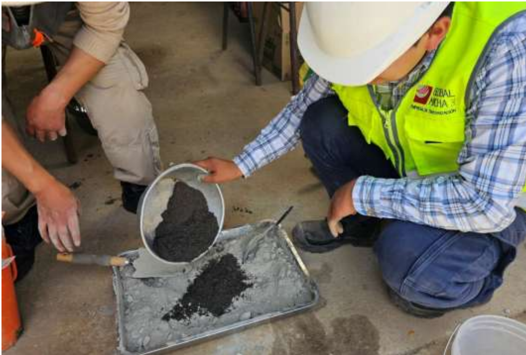
Fotografía 42. Realizamos la mezcla del concreto experimental reemplazando una proporción del cemento por la ceniza de cáscara de granadilla (10%, 12.5% y 15%), para comparar con el diseño patron.
