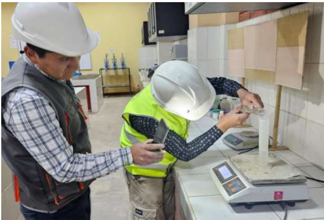
Fotografía 18. Resultados del ensayo del peso específico y absorción del agregado fino de la cantera Cochamarca con las respectivas normas técnicas vigentes.
