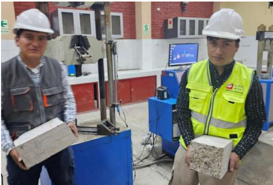
Fotografía 56. Obtenemos los resultados de la rotura de vigas para hallar el módulo de rotura por el ensayo de resistencia a la flexión del concreto general y experimental para esta investigación.
