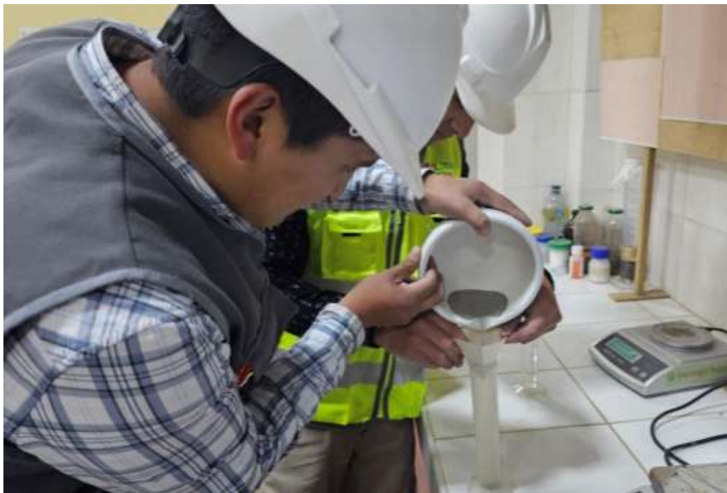
Fotografía 20. Realizamos el ensayo del peso específico y absorción del agregado fino de la cantera Cochamarca con las respectivas normas técnicas vigentes.
