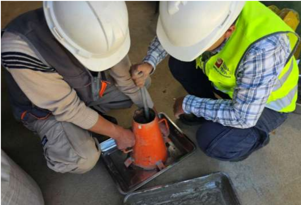
Fotografía 35. Empezamos a realizar el ensayo de asentamiento para obtener el Slump del patron general de la mezcla de diseño correspondiente. Se realiza los 25 golpes por capa según las normas vigentes.
