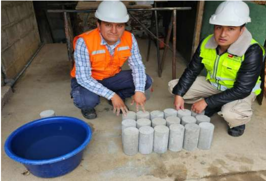
Fotografía 47. Después de 24 horas de secado de las probetas de concreto, realizamos el curado de probetas de concreto.
