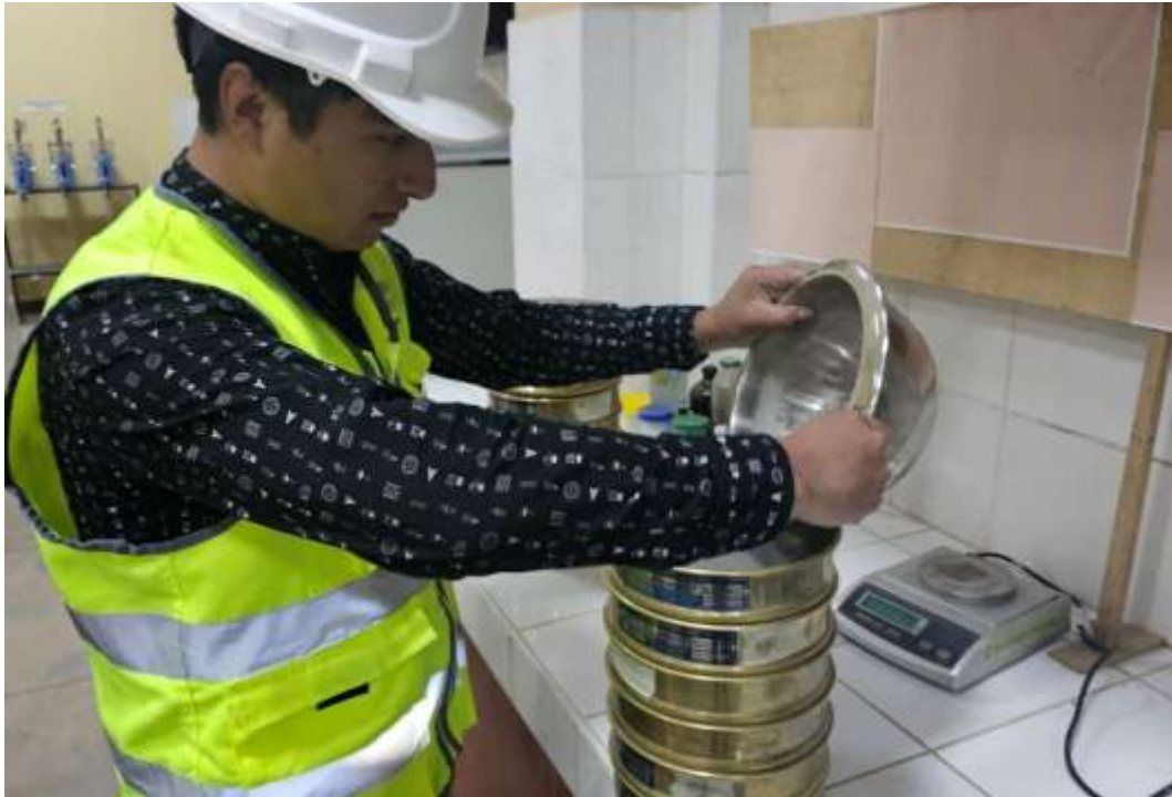
Fotografía 9. Se empieza a realizar el ensayo de granulometría según las normas técnicas vigentes para el agregado fino después del cuarteo correspondiente.
