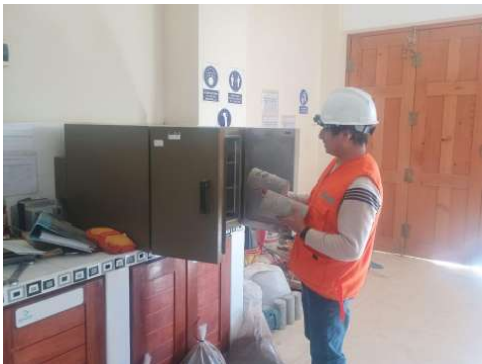
Fotografía 62. En la imagen se observa el retiro de las probetas de concreto del horno de secado, una vez alcanzada la masa constante, etapa necesaria para el cálculo del porcentaje de absorción de agua en el ensayo de durabilidad.
