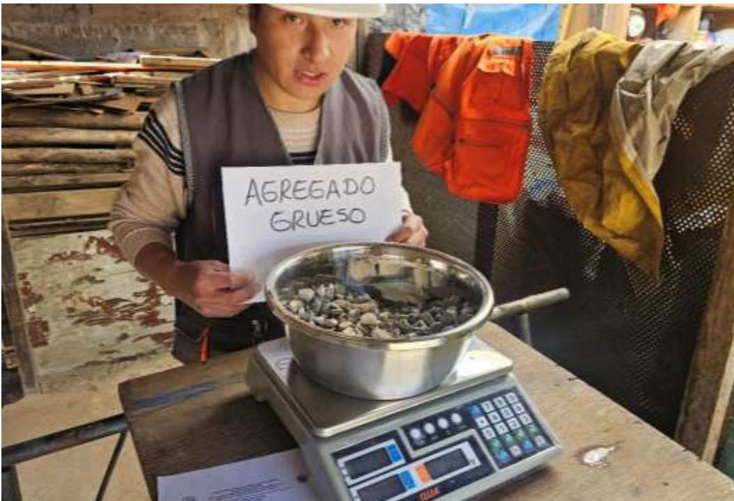
Fotografía 28. Empezamos a pesar cada material; agregado fino, agregado grueso, cemento, agua y para el concreto experimental pesamos la ceniza de cáscara de granadilla.
