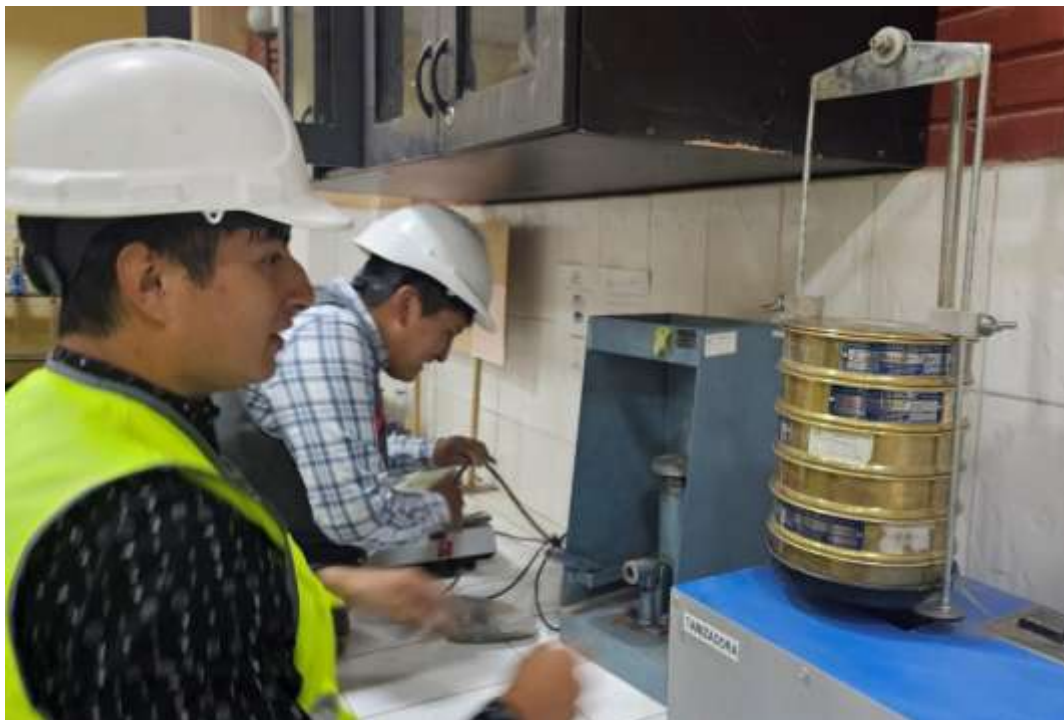
Fotografía 10. Tamizamos el agregado fino para obtener las cantidades de agregados por tamiz para el ensayo de granulometría y obtener el módulo de finura.
