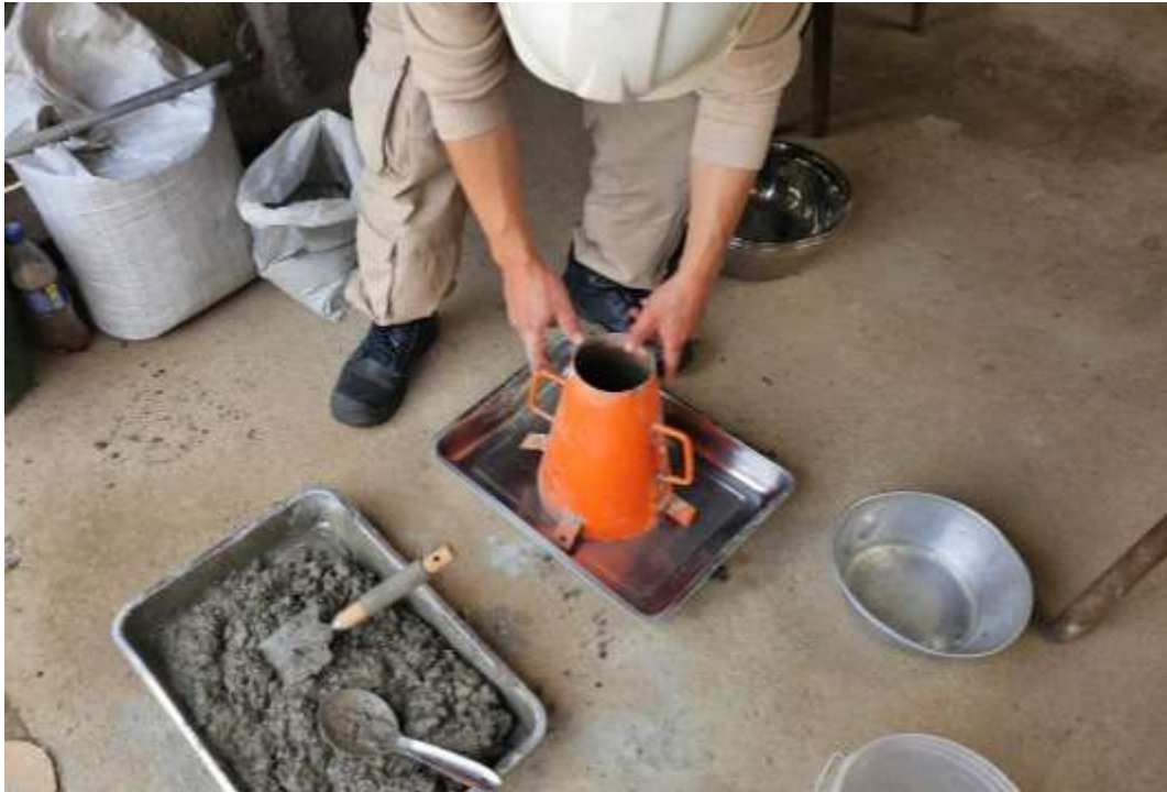
Fotografía 43. Realizamos el ensayo del cono de abrams para obtener el asentamiento (Slump) del concreto experimental.
