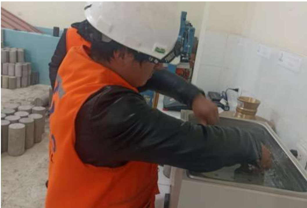
Fotografía 58. En la imagen se muestra el proceso de inmersión y manipulación de las probetas de concreto durante el ensayo de absorción de agua, como parte de la evaluación de la durabilidad.
