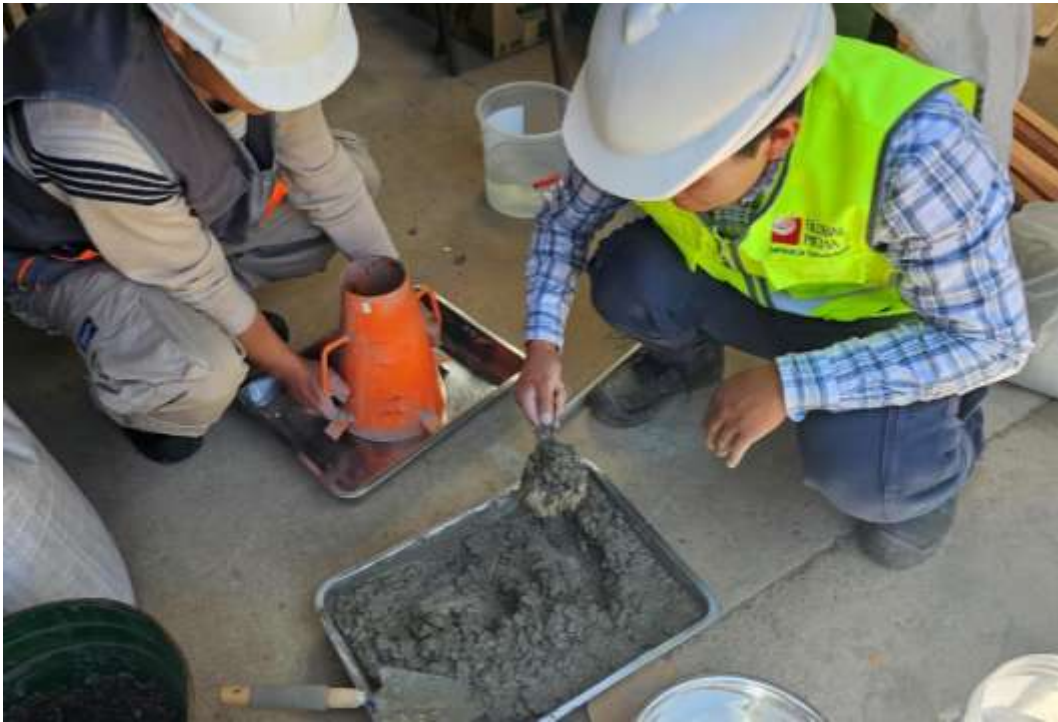
Fotografía 34. Empezamos a realizar el ensayo de asentamiento para obtener el Slump del patron general de la mezcla de diseño correspondiente.
