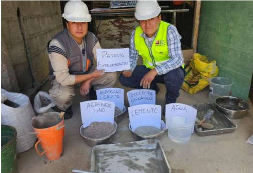
Fotografía 41. Después de obtener los resultados de las propiedades físicas de cada agregado empezamos a realizar los diseños de mezcla del concreto natural y experimental por lo tanto realizamos la mezcla del concreto experimental, aumentando ceniza de cáscara de granadillas.
