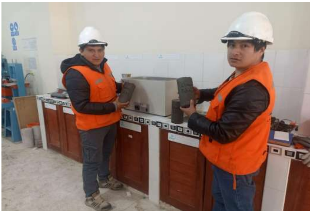
Fotografía 60. En la imagen se observa el retiro de las probetas de concreto del equipo de secado, procedimiento necesario para la determinación de la absorción de agua en el ensayo de durabilidad.
