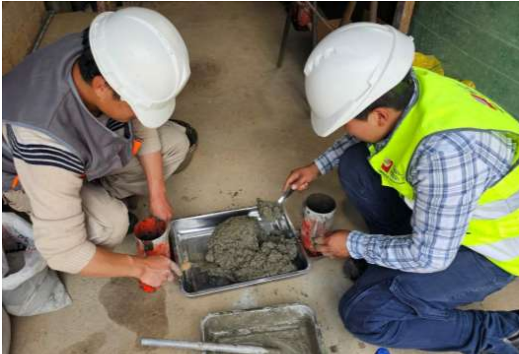
Fotografía 45. Empezamos a llenar los moldes de 10 cm x 20 cm con el concreto experimental mezclado para obtener probetas y hacer posteriormente los ensayos de compresión, tracción y flexión.
