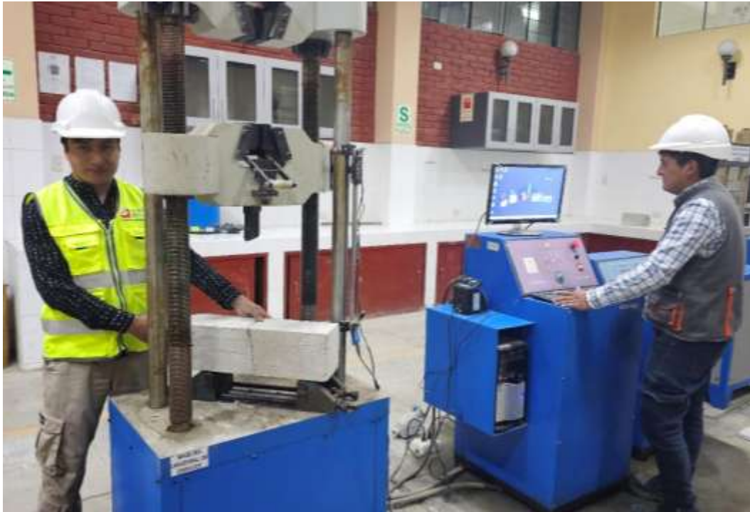
Fotografía 55. Realizamos el ensayo de resistencia a la flexión de las vigas generales y experimentales.
