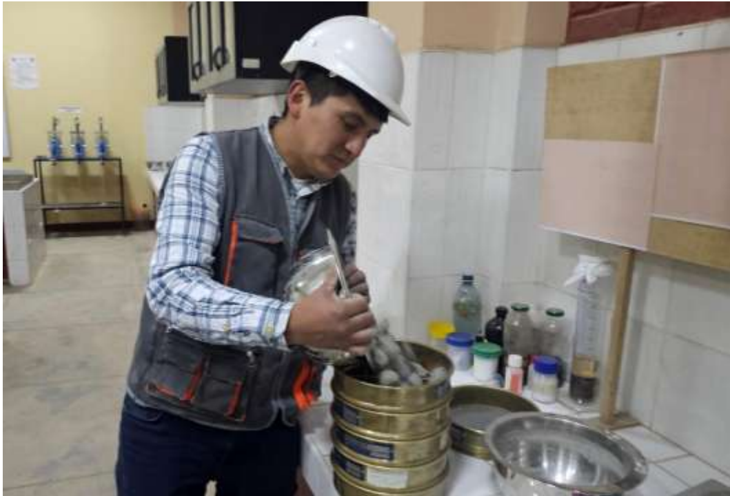
Fotografía 11. Realizamos el ensayo de granulometría según las normas técnicas vigentes para el agregado grueso después del cuarteo correspondiente.
