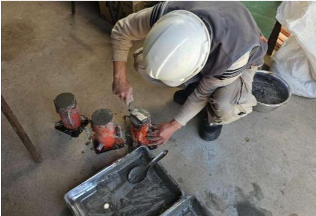
Fotografía 39. Empezamos a llenar los moldes de 10 cm x 20 cm con el concreto general mezclado para obtener probetas y hacer posteriormente los ensayos de compresión, tracción y flexión.
