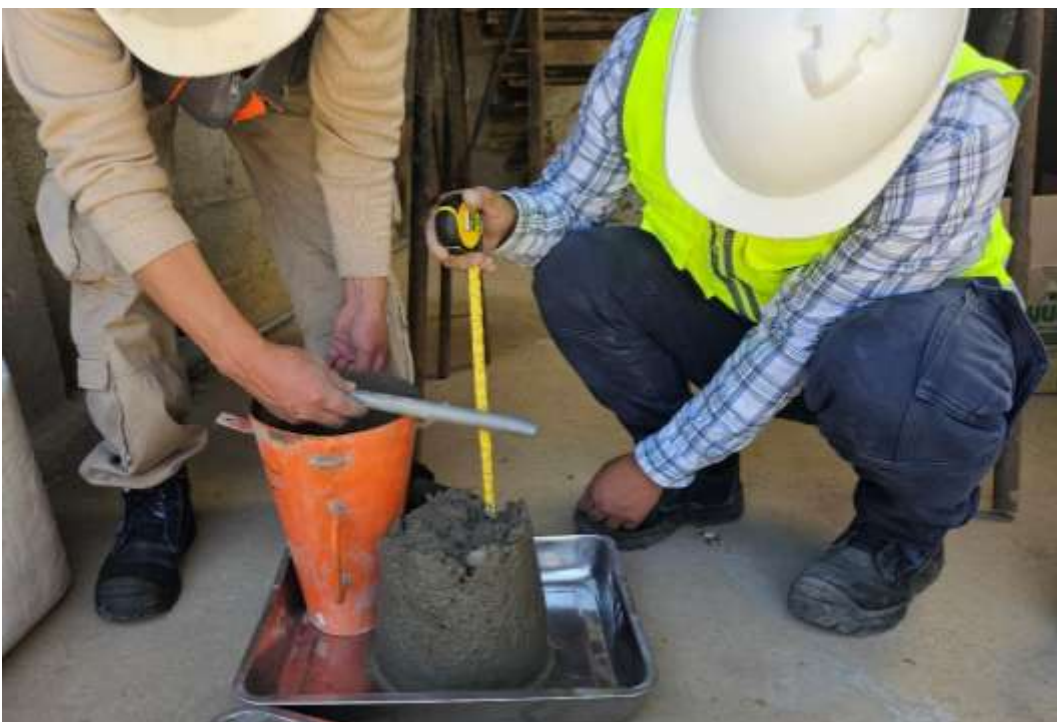
Fotografía 36. Obtenemos el primer asentamiento (Slump) del concreto general para comparar posteriormente con los diseños experimentales.
