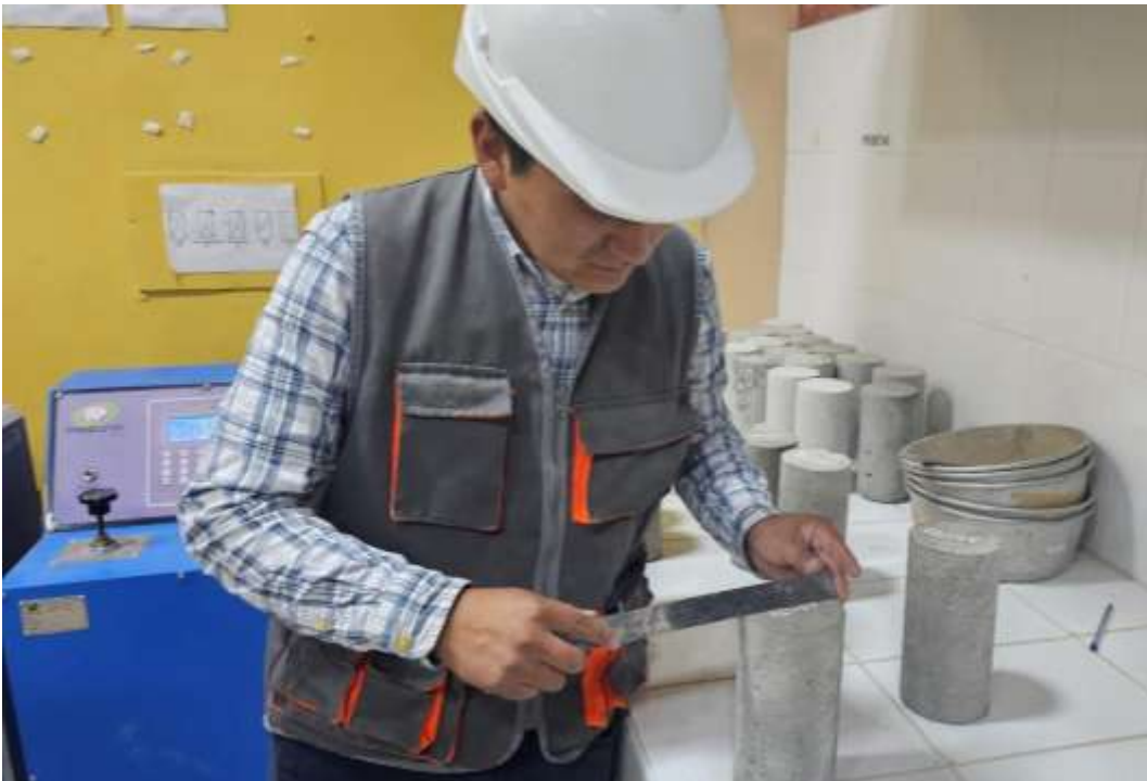
Fotografía 50. Empezamos a medir cada probeta, tanto su altura y su diámetro para hallar el peso unitario.
