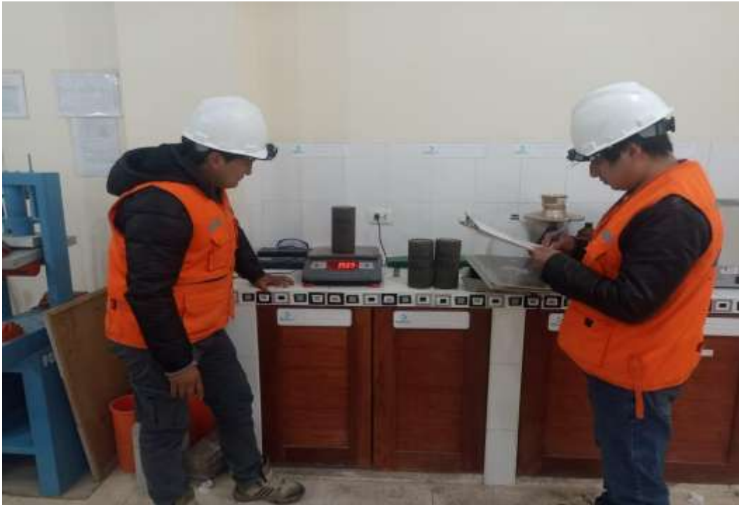
Fotografía 57. En la imagen se muestra el procedimiento de pesado de las probetas, realizado como etapa previa al ensayo de absorción de agua, con la finalidad de evaluar la durabilidad del concreto.
