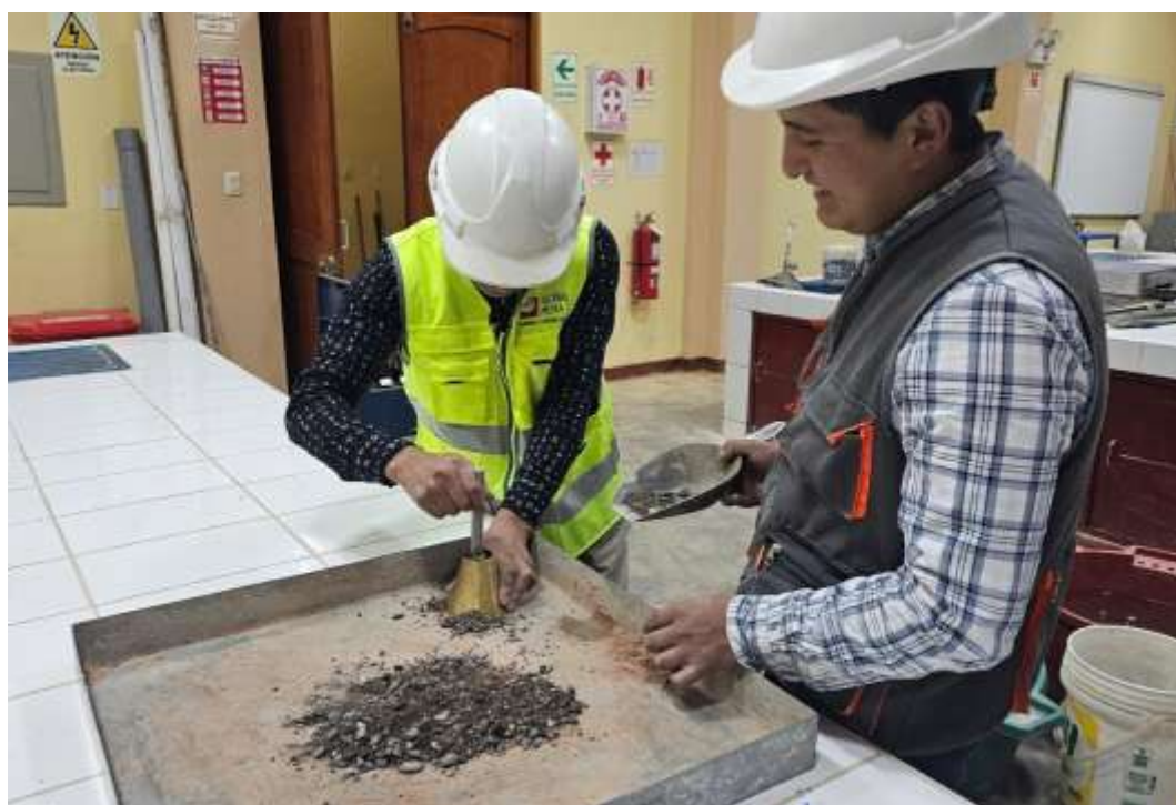
Fotografía 16. Realizamos el ensayo del peso específico y absorción del agregado fino de la cantera Cochamarca con las respectivas normas técnicas vigentes.
