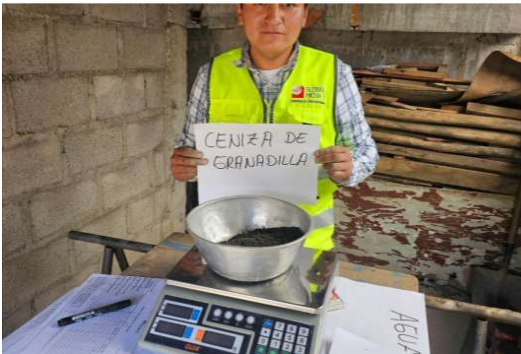
Fotografía 40. Empezamos a pesar cada material; agregado fino, agregado grueso, cemento, agua y para el concreto experimental pesamos la ceniza de cáscara de granadilla.
