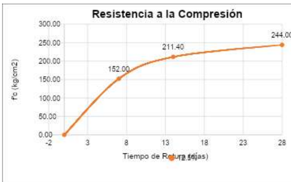
Figura 24. Curva de resistencia 210 kg/cm 2 del concreto experimental (patrón 12.5%)
