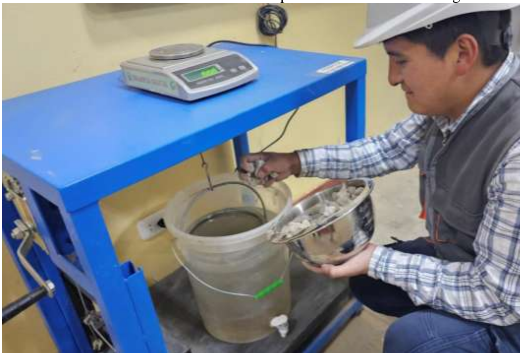
Fotografía 25. Realizamos el ensayo de densidad real y absorción de las cenizas de cáscara
