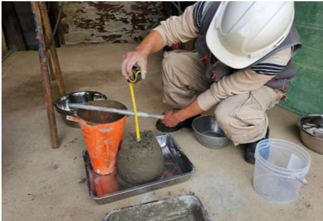
Fotografía 44. Se obtiene el asentamiento (Slump) del concreto experimental (10%, 12.5% y 15%) para comparar con el diseño del patron general.
