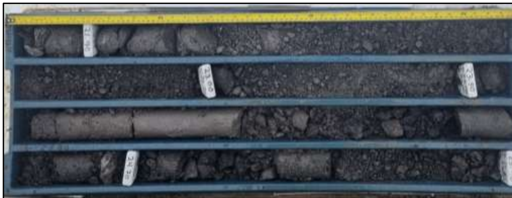
Figura 26. Fotografía RQD = 0 en zonas de falla o con baja dureza.
