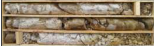
B - Completamente intemperizada/alterada - Se observa remanentes de la textura original y estructuras relicticas de la roca, pero la roca se descompone y es friable.
