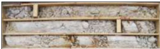
A - Suelo Residual/Zona de Falla - La textura original de la roca se encuentra destruida.
