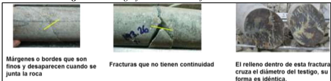
Figura 21. Fotografía. con casos de fracturas mecánicas.
