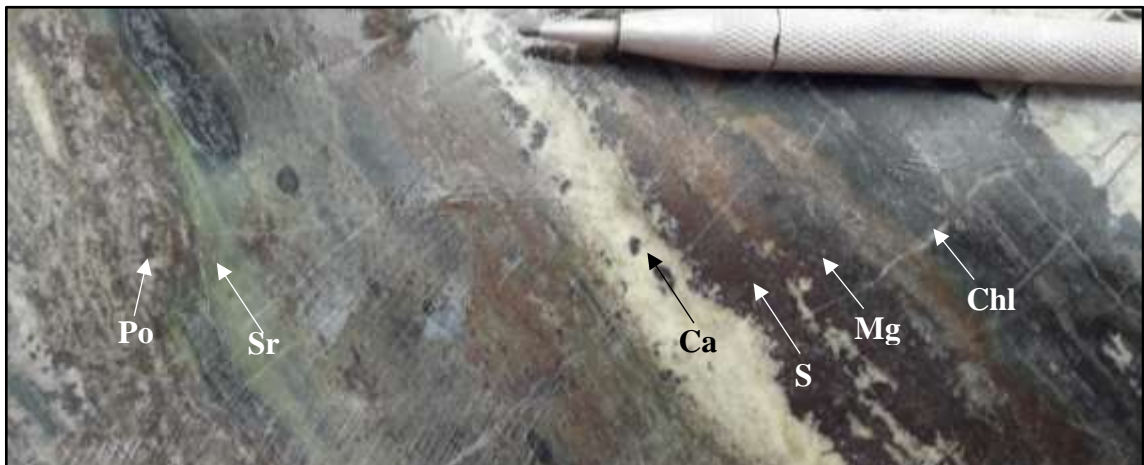
Figura 11. Estadío de mineralización A – Manto Mt-Po-Sp, DDHTPD17003 a 234.7 m, @ 0.1 g/t Au, 0.0 Oz Ag, 0.0 % Pb, 2.7 % Zn, 0.0 % Cu.
