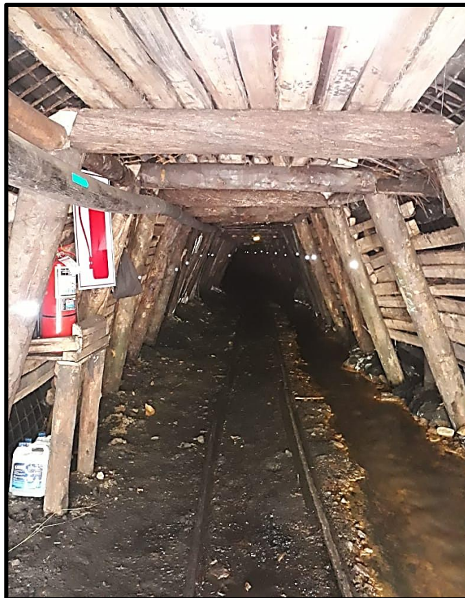
Figura 44 Mina Chilinka, sostenimiento con cimbras.
