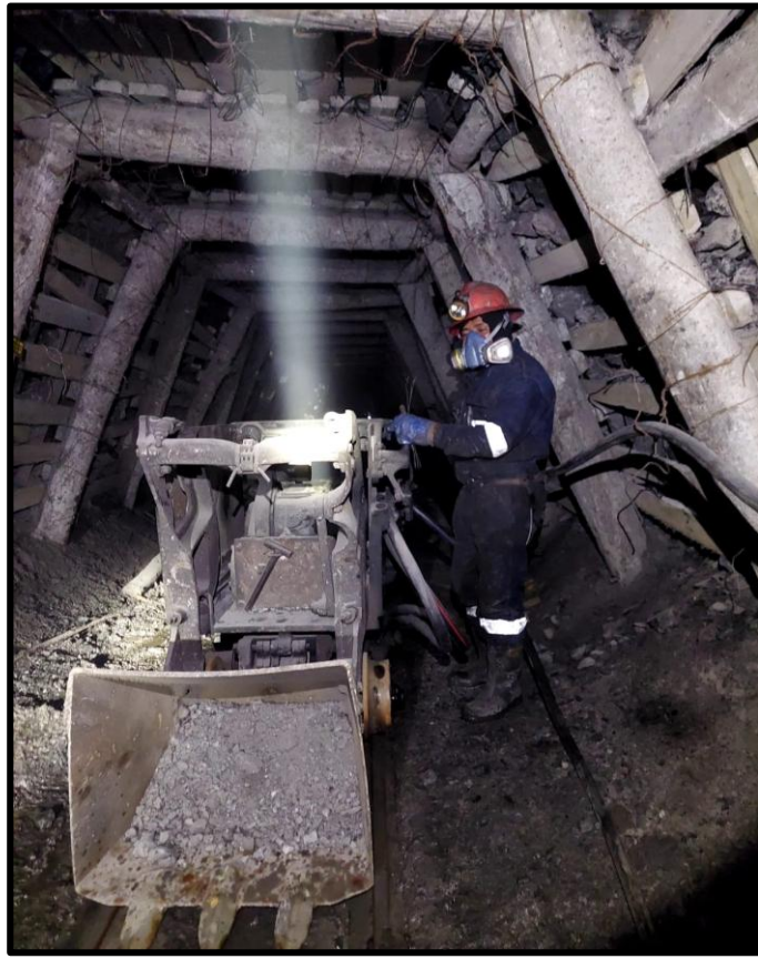
Figura 52 Pala neumática, realizando trabajos en Galería FLANCO.
