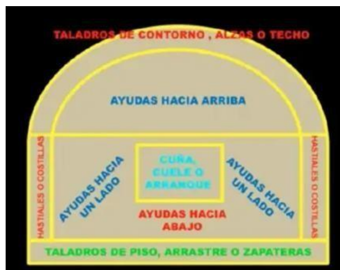
Figura 2. Ubicación de los taladros en perforación de avances
