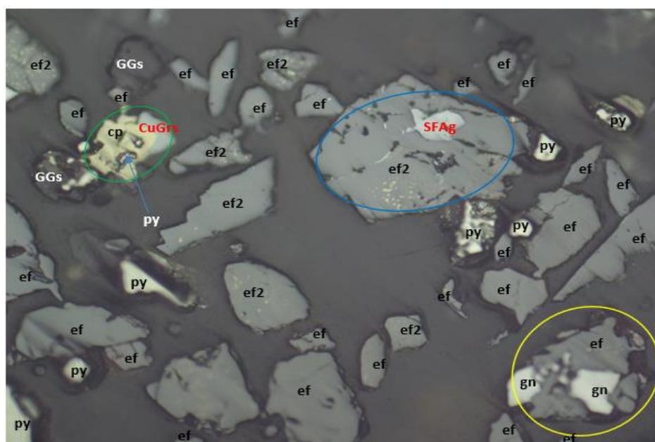
Figura 12 Concentrado ZINC malla + 200 (Metabisulfito)
