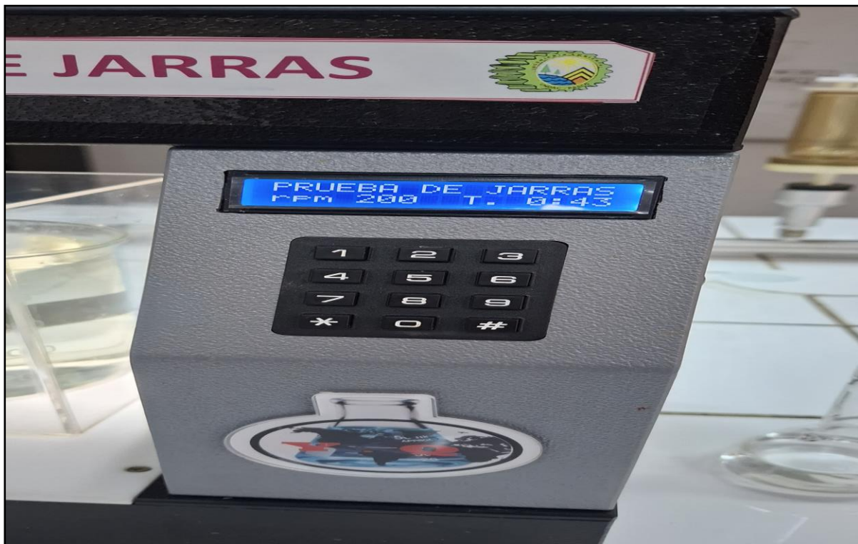
Imagen 004: Control del tiempo y manejo del equipo de prueba de jarras
