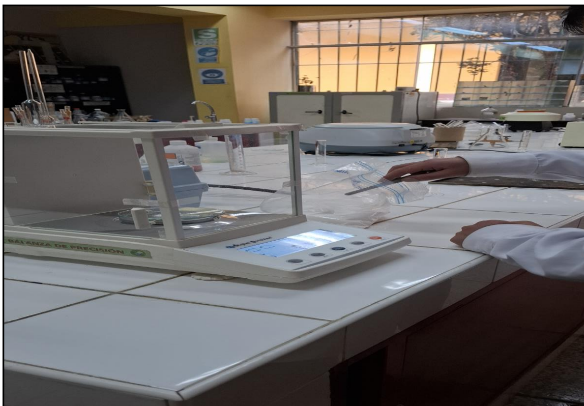
Imagen 9. Pesado de 0.5 mg/L del floculante Poliacrilamida
