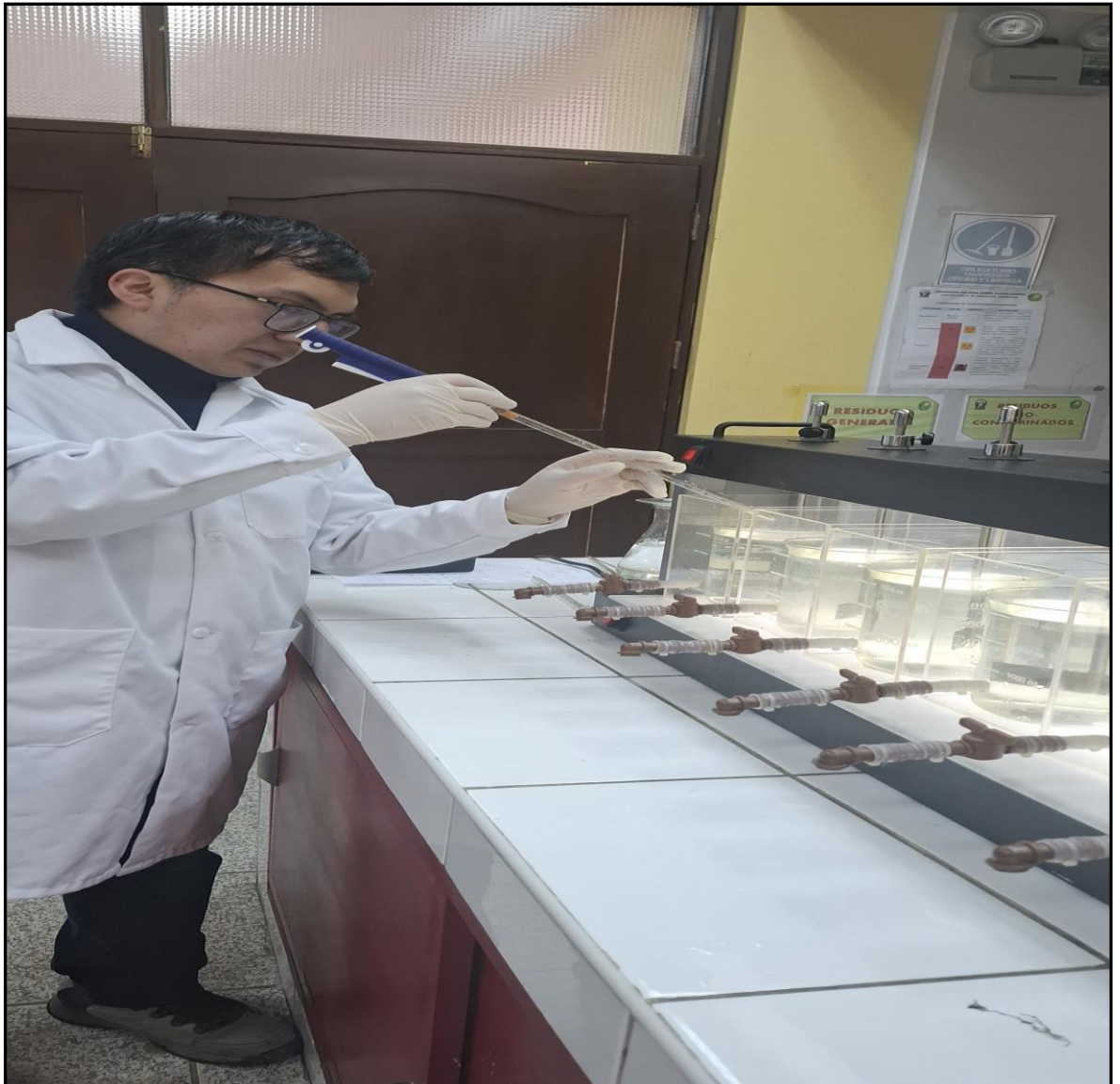
Imagen 12. Dosificación de diferentes dosis de Poliacrilamida
