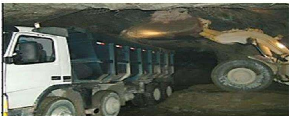
Figura 28. Carguío y Transporte de Mineral
