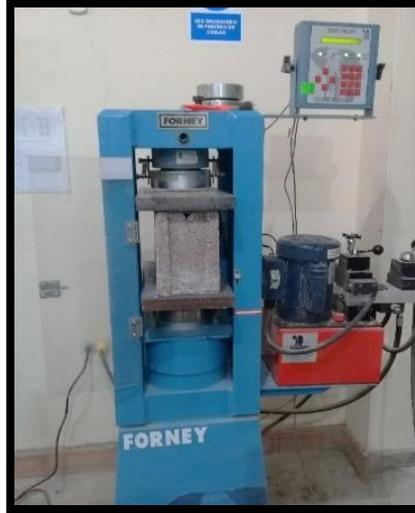
*Figura 9 - Ensayo de Compresión Axial en Bloques de Concreto*
