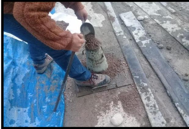
*Colocando la muestra en el molde para la determinación del asentamiento de la mezcla*
