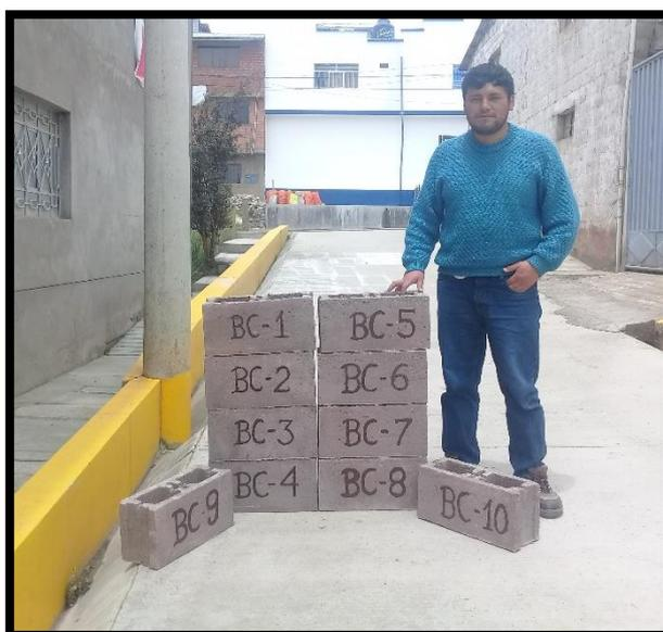
*Muestreo de unidades de Bloques de Concreto con Ceniza de Cal, 10 unidades para Variación Dimensional y Alabeo, 5 para Resistencia a Compresión y 5 para Absorción RNE Norma E.070*
