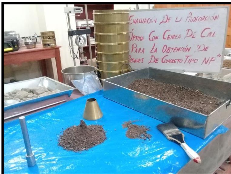
Prueba de Humedad Superficial para la determinación de la muestra en condición Saturado Superficialmente Seco
