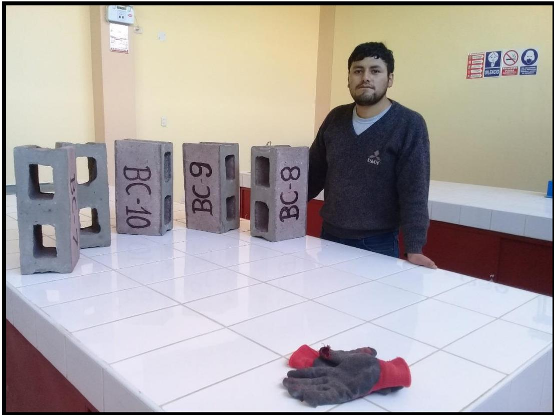
*Foto N°16 - Muestreo de Unidades de Bloques de Ceniza de Cal 2 Refrentadas*
