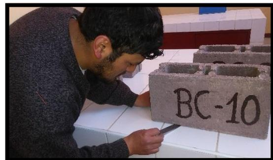
**ENSAYO DE ALABEO EN BLOQUES DE CONCRETO ELABORADOS CON LA
