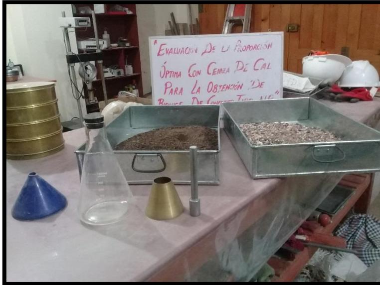
Procedimiento de Ensayo de Peso Especifico y Absorción de Ceniza de Cal 1, 2 y Arena Shotcrete
