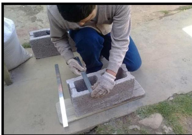
**Figura 7** - Ensayo de Variación Dimensional en Bloques de Concreto
