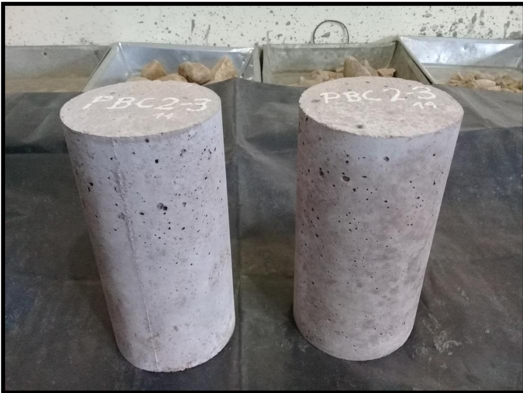
*Foto N°10 - Muestras de Probetas Cilíndricas 28 días*
