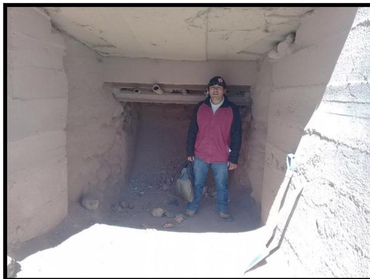
**Figura 17** - Parte inferior de Hornos Artesanales donde se obtiene Ceniza de Cal
