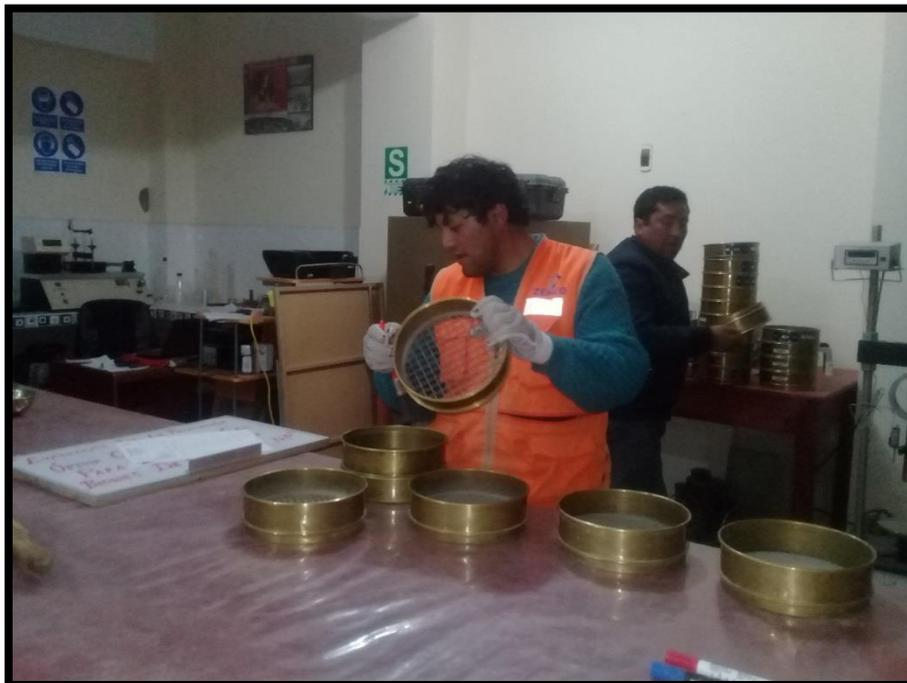
*Foto N°2 - Ensayo de Granulometría de Agregados*
