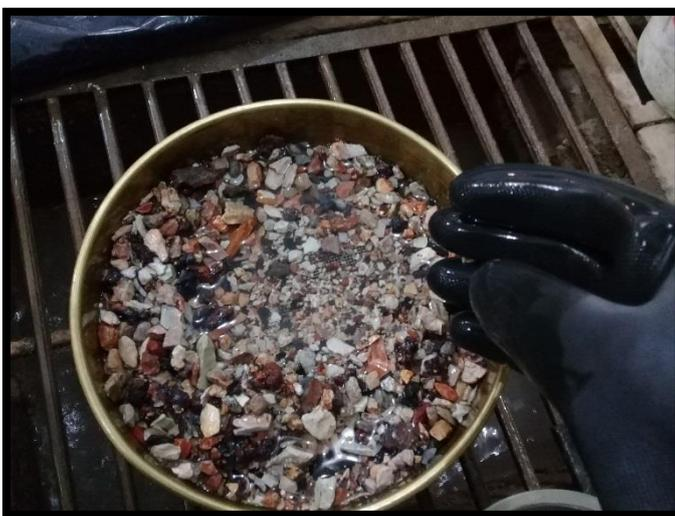
*Procedimiento de Lavado de Agregados con agua para la obtención del porcentaje de finos que pasa el tamiz N° 200*
