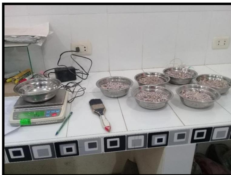
*Peso de las muestras secas para la determinación del Peso Específico, Absorción y Contenido de Humedad de los Agregados*
