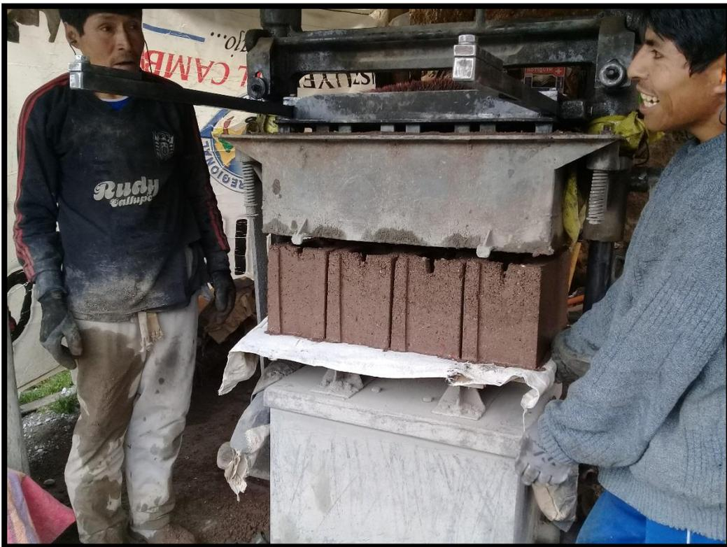
*Foto N°15 - Desmolde de las Unidades Vibro-Compactadas*
