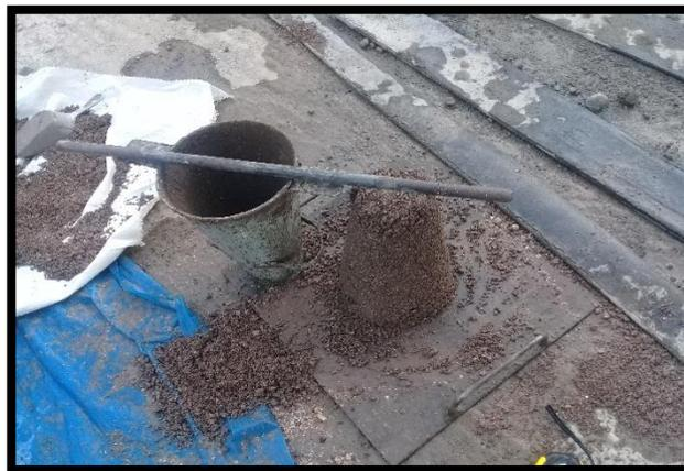
*Retirado el molde de la muestra, lista para realizar la medición del asentamiento de la mezcla*
