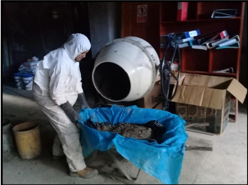
*Foto N°8 - Obtención de Muestras de Mezclas Experimentales*
