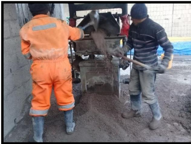
*Llenado con mezcla del molde sobre la máquina vibro compactadora, generalmente hasta la mitad para seguidamente aplicar la vibración*
