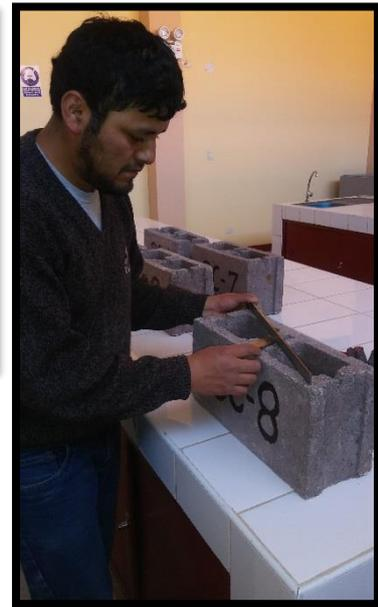
*Ensayo de Alabeo en Bloques de Concreto*
