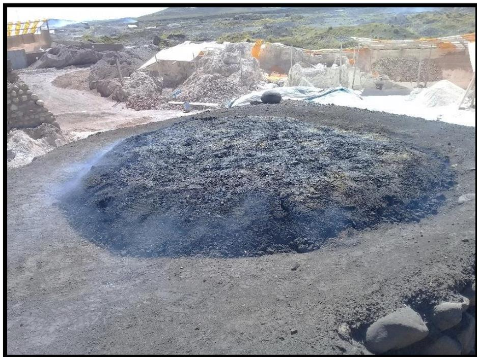
**Figura 28** - Proceso de Cocción entre 900° y 1000° - Capa de Carbón en la parte superior de Horno Artesanal
