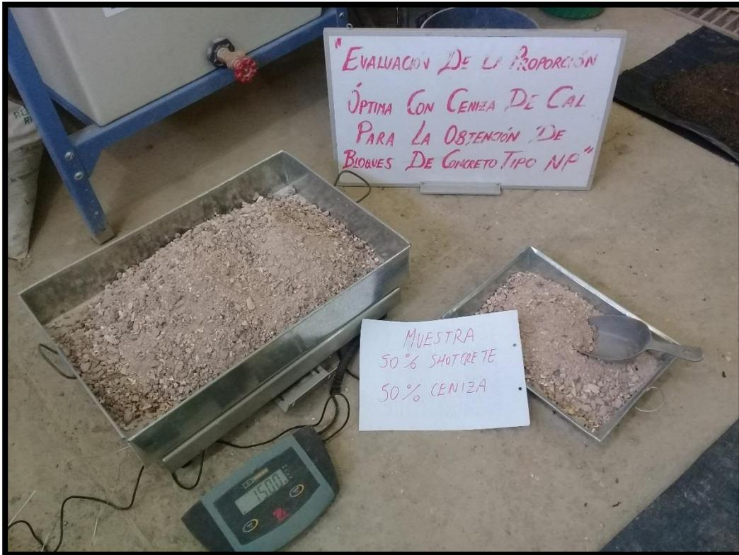
Foto N°5 - Peso Unitario Compactado Combinación de Agregados
