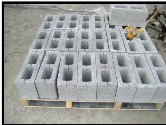
**Figura 4 - Bloques de Concreto Industriales**
