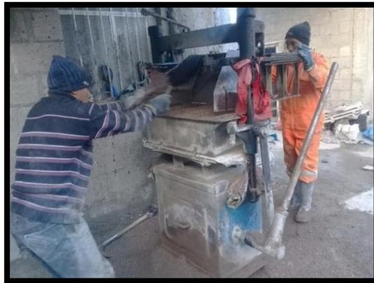
**Figura 1** - Sistema de Vibro-Compactación
