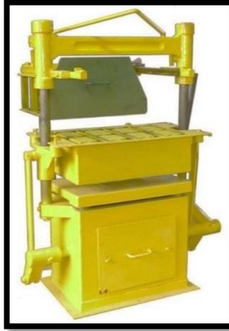
**Figura 6** - *Máquina RosaCometa comúnmente usado para la fabricación semi industrial de Bloques de Concreto en la ciudad de Cerro de Pasco*
