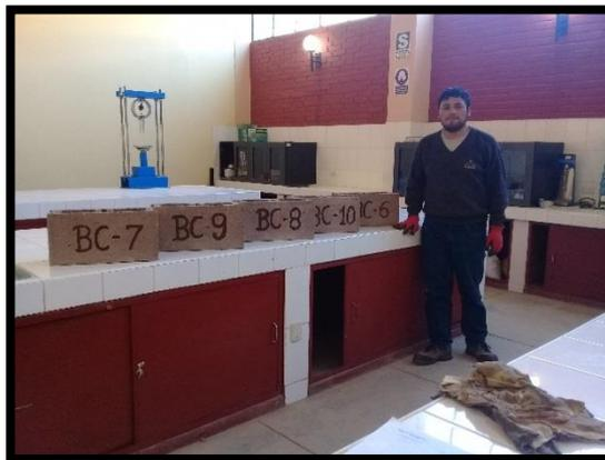
*Preparación de la muestra de 10 unidades para el ensayo de Variación Dimensional en Bloques de Concreto, elaborados con la proporción 1:6 y 1:7*
