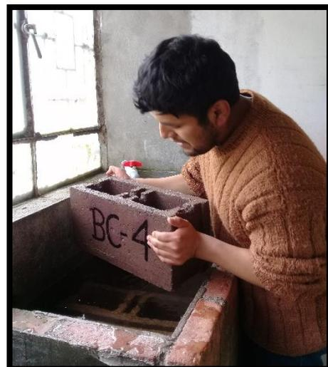
En las imágenes anteriores se puede observar el registro de los pesos secos y la saturación de las unidades en una poza de agua (arriba), también el retiro de las unidades de la poza de agua después de 24 horas y el registro del peso saturado (abajo).
