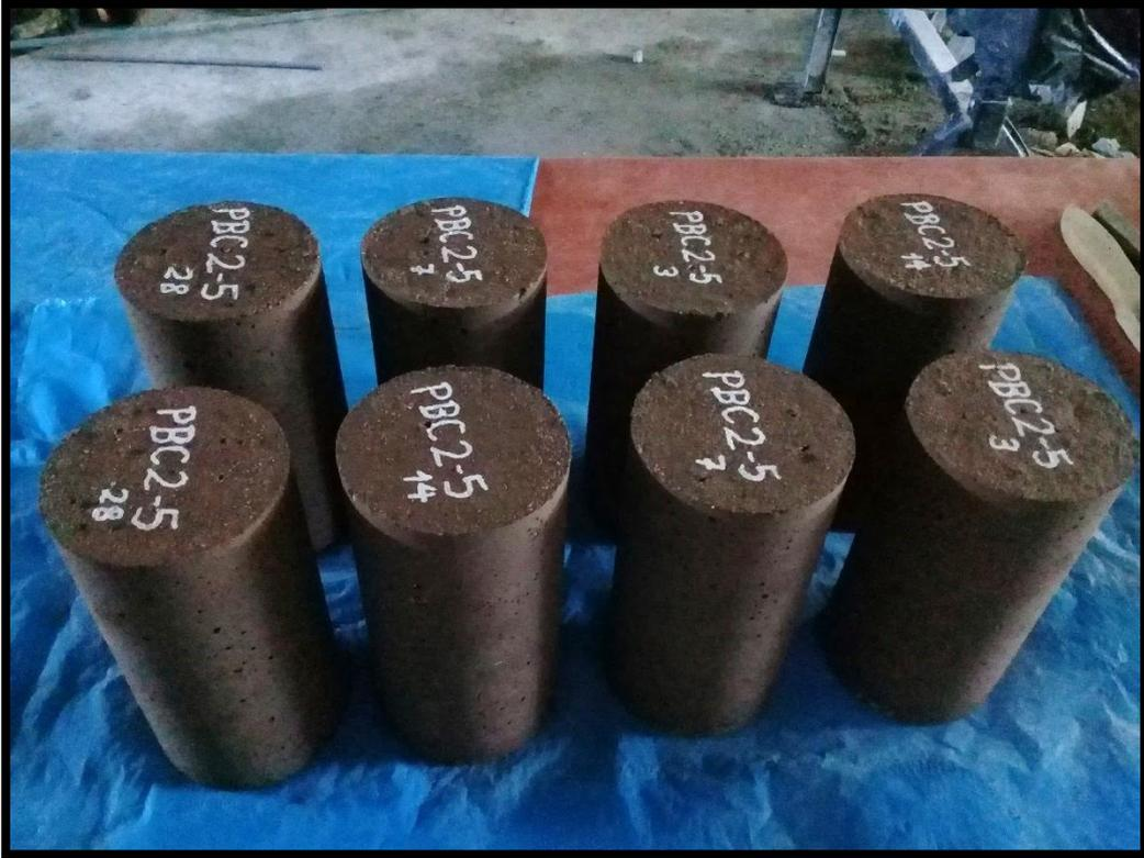
*Foto N°9 - Muestras de Probetas Cilíndricas Fraguadas*
