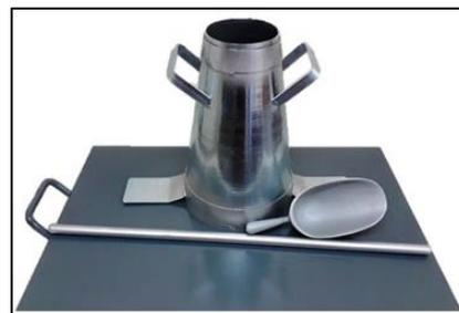
*Materiales empleados para ensayo de la medición del asentamiento*
