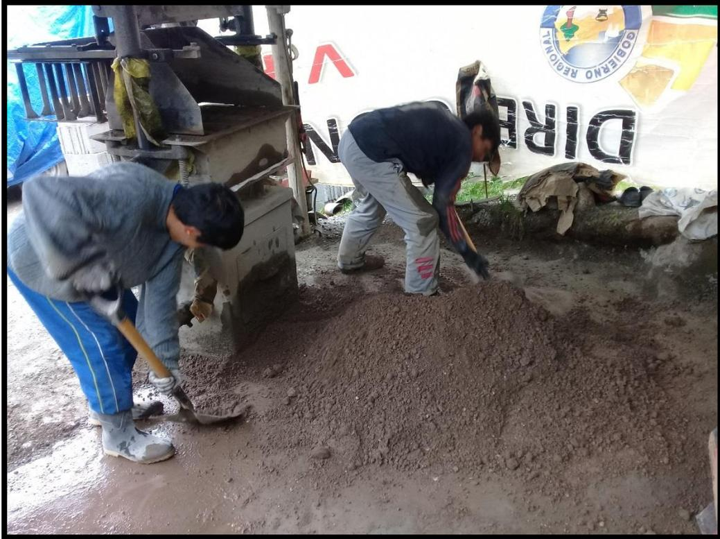
*Foto N°14 - Mezclado de Materiales Fabricación de Bloques de Concreto*
