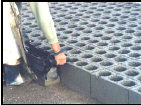
**Figura 3 - Bloques de Concreto Artesanales**
