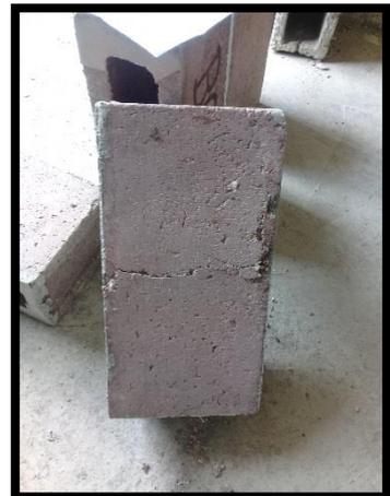
A continuación se presenta los resultados del cálculo de la resistencia característica a compresión de la unidad de bloque de concreto elaborado con Ceniza de Cal 2, con la proporción 1:10
