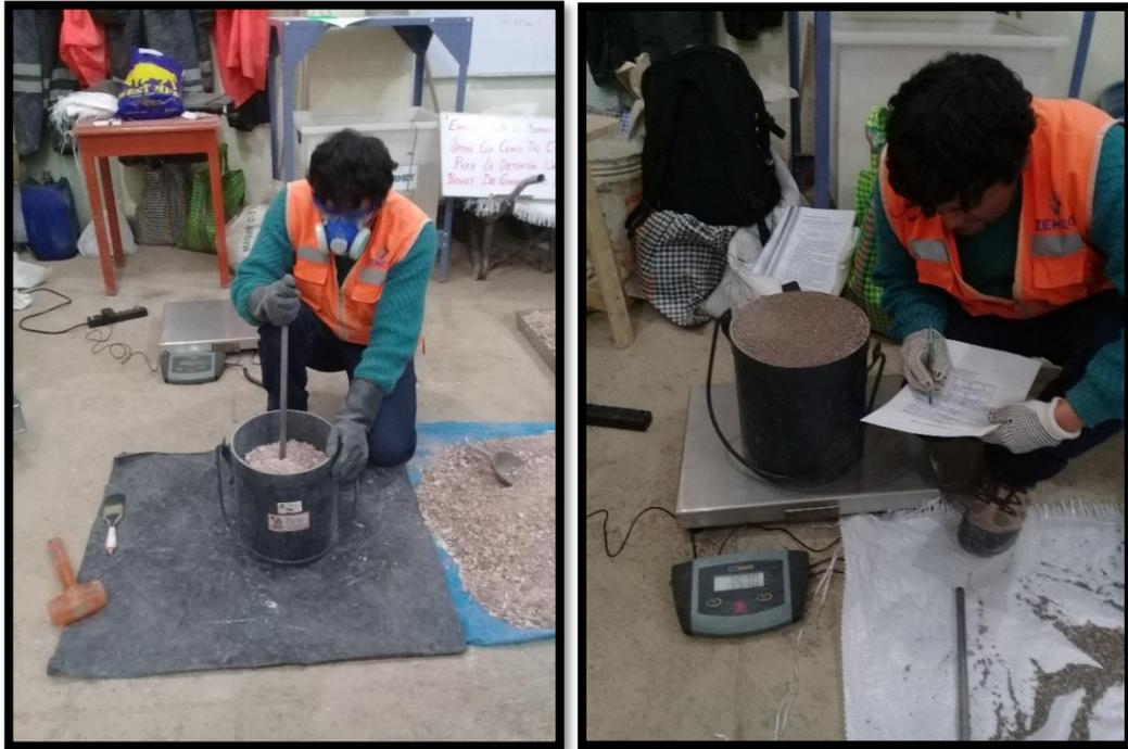
*Procedimiento del Ensayo de Peso Unitario Suelto y Compactado de Ceniza de Cal 1, 2 y Arena Shotcrete*
