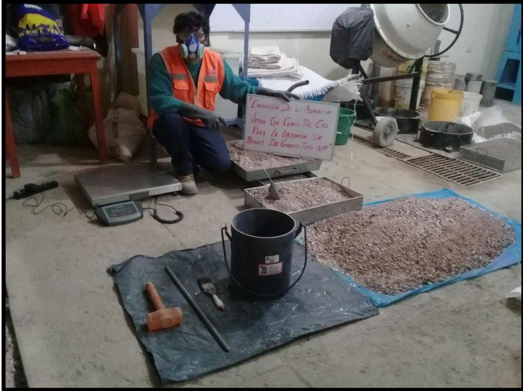
*Foto N°3 - Ensayo de Peso Unitario Suelto y Compactado de Agregados*
