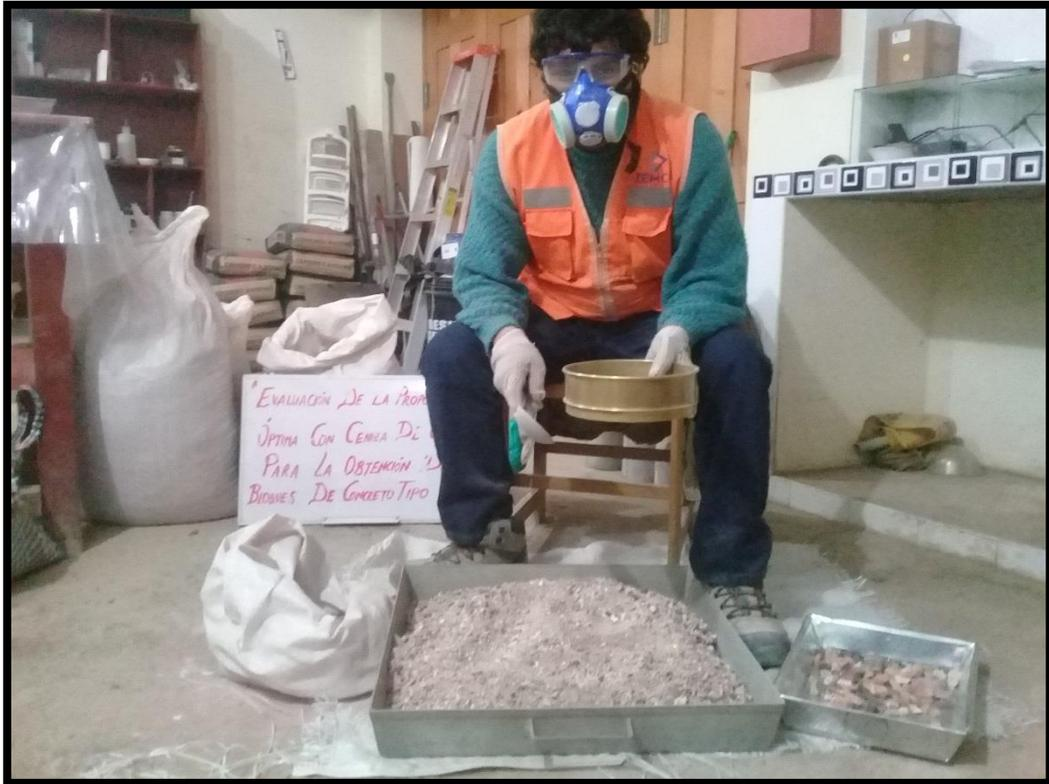
*Foto N°4 - Proceso de Tamizado (zarandeado) de Agregados*
