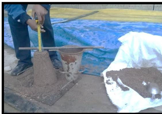
**Figura 5 - Revenimiento (slump) de la mezcla para Bloques de Concreto**
