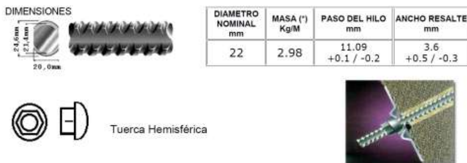
Figura 25 Características de los Pernos Helicoidales
