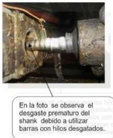
Figura 78 Desgaste prematuro del Shank
