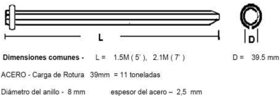
Figura 21 Características de los Pernos de fricción Split Set
