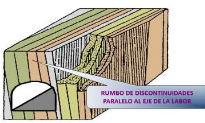
Figura 9 Orientación desfavorable de las discontinuidades respecto de las labores
