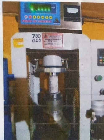
Imagen N°08. Ensayo de compresión de testigos diamantinos
