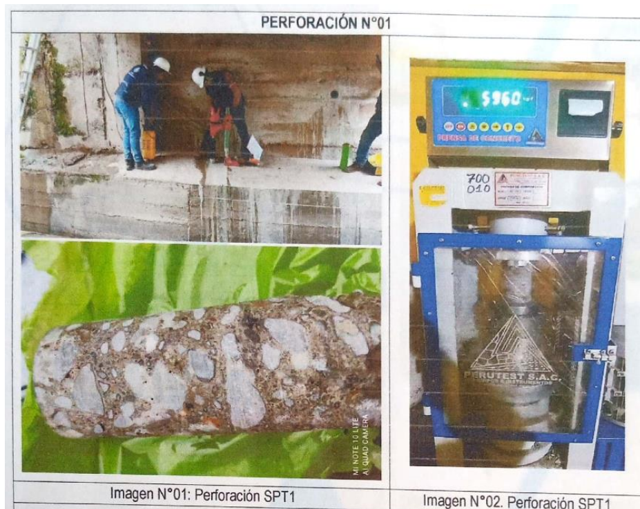
Ilustración 3: Verificación de las condiciones mecánicas de la estructura
