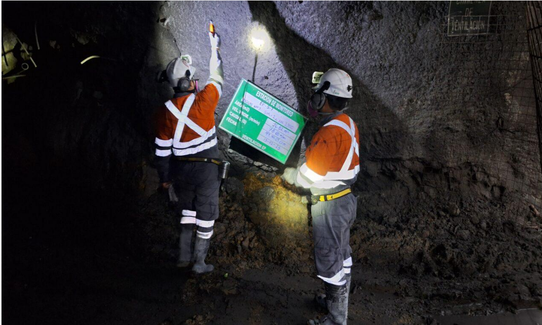
Fotografía 3: Verificación de parámetros de ventilación en estación de monitoreo de gases en interior mina
