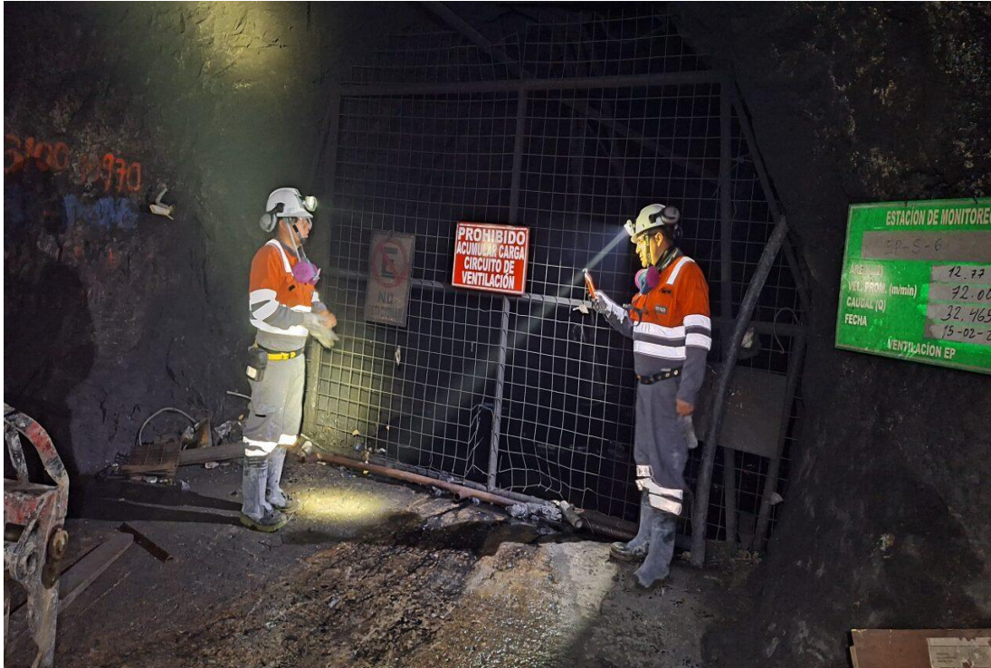
Fotografía 5: Evaluación de condiciones de ventilación en reja de control de circuito, antes del ingreso a zona de operación
