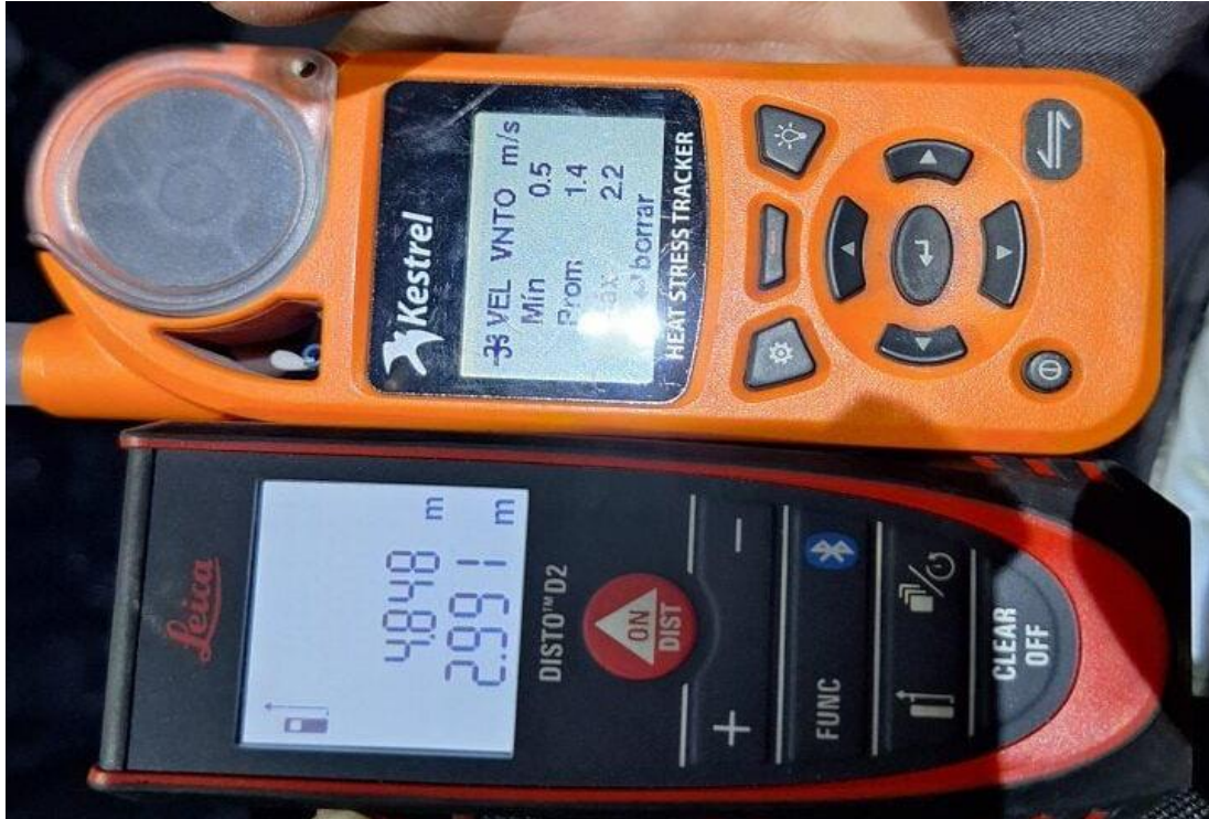
Fotografía 9: Equipos de medición utilizados en el estudio: distanciómetro láser y medidor ambiental portátil (Kestrel)
