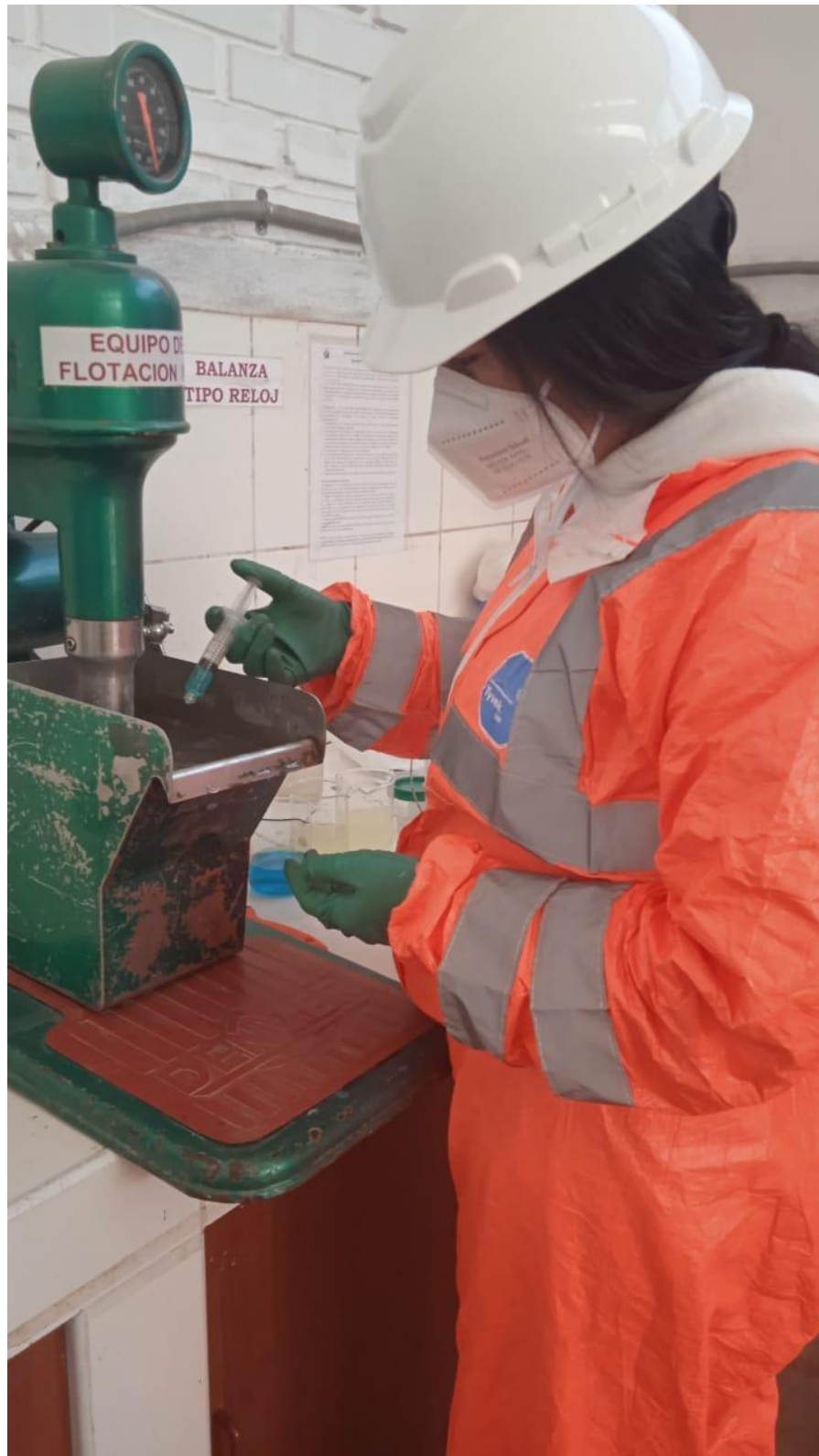
Figura 24 Adición del \text{CuSO}_4 - para la activación de los sulfuros
