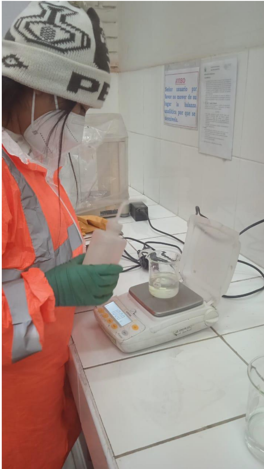
Figura 17 Preparación de reactivos xantato Z6 (xantato amílico de potasio)
