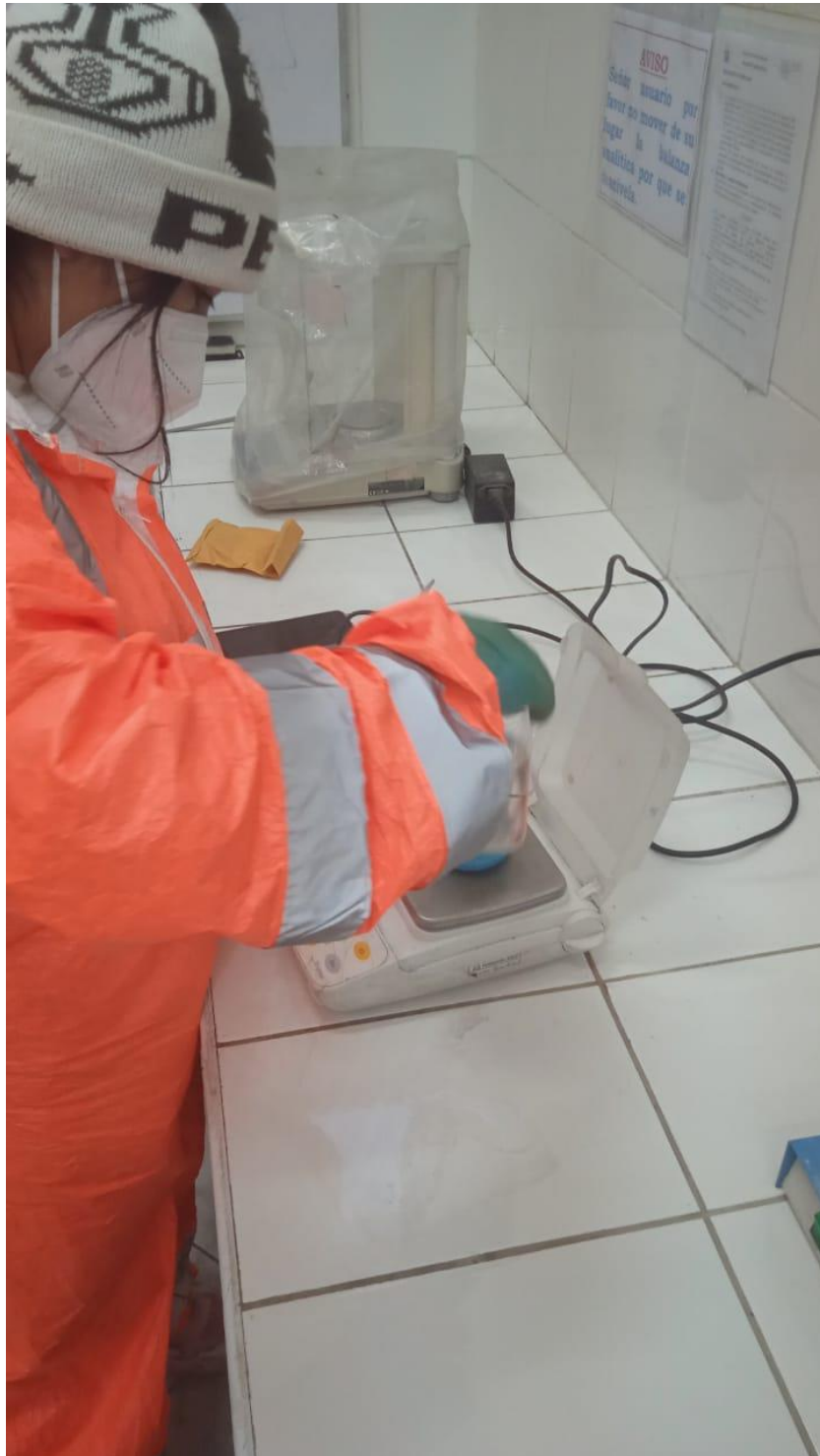
Figura 18 Preparación de reactivos sulfato de cobre ( \text{CuSO}_4 )
