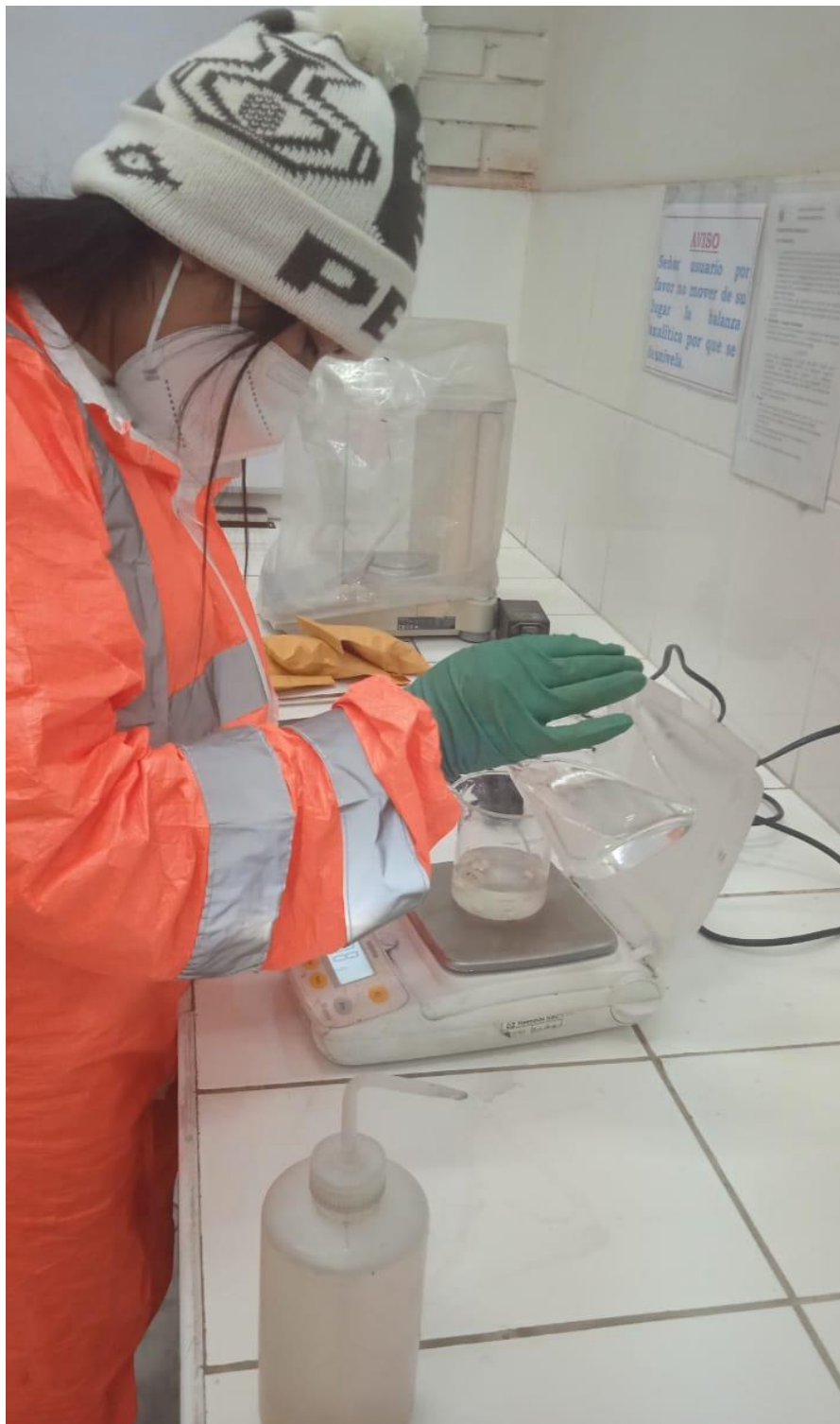
Figura 19 Preparación de reactivos xantato Z11 (xantato isopropílico de sodio)
