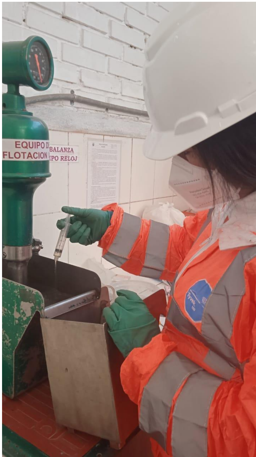
Figura 23 Adición del Z6 para coleccionar partículas
