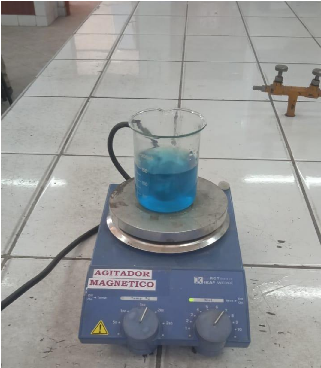
Figura 20 Dilución del sulfato de cobre ( \text{CuSO}_4 )
