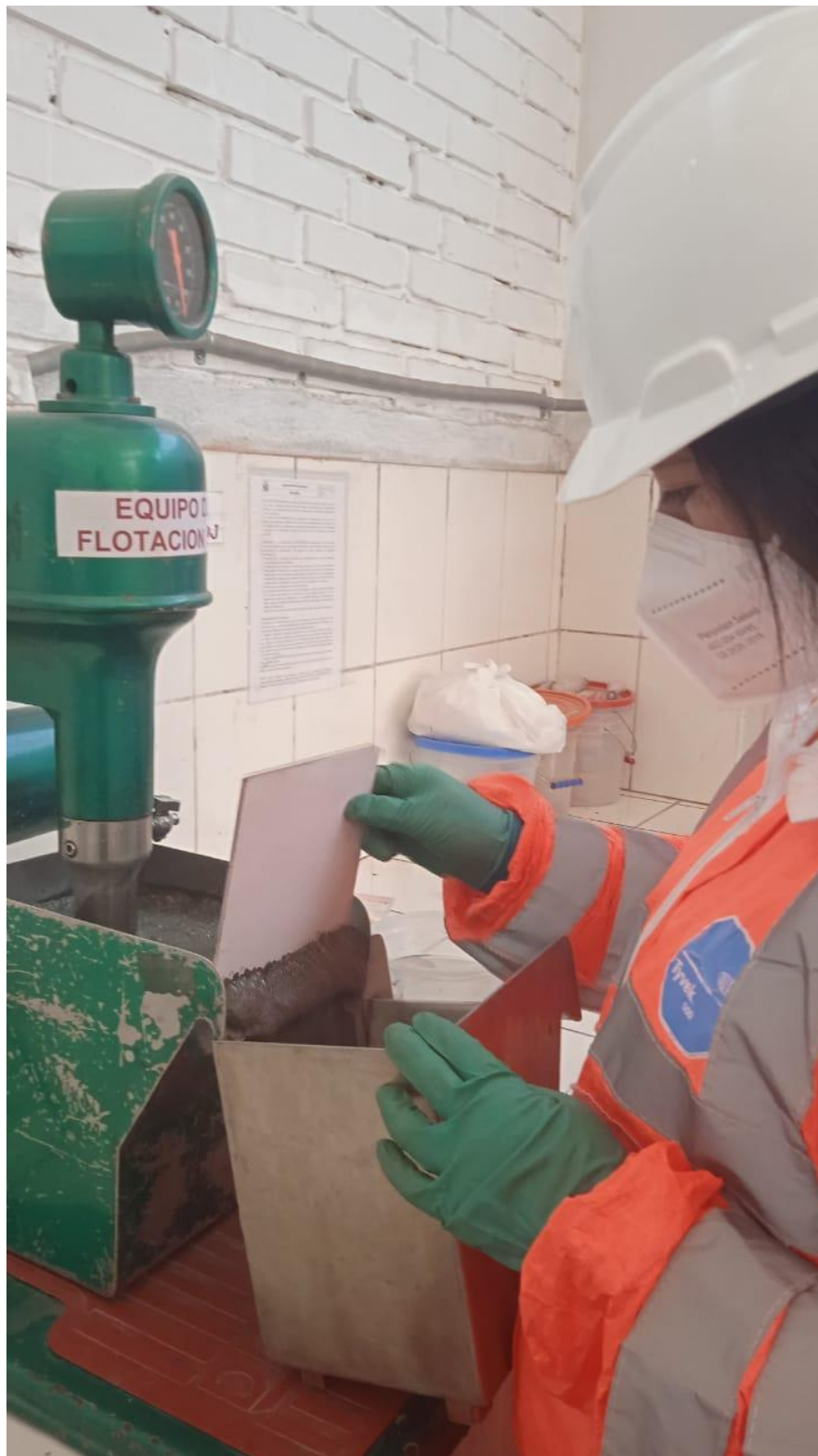
Figura 25 Obtención del concentrado pirita - arsenopirita
