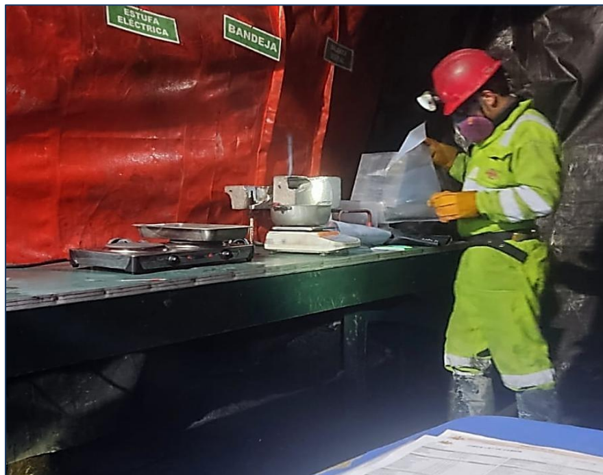
Figura 13. Realización de ensayos de humedad en cocina
