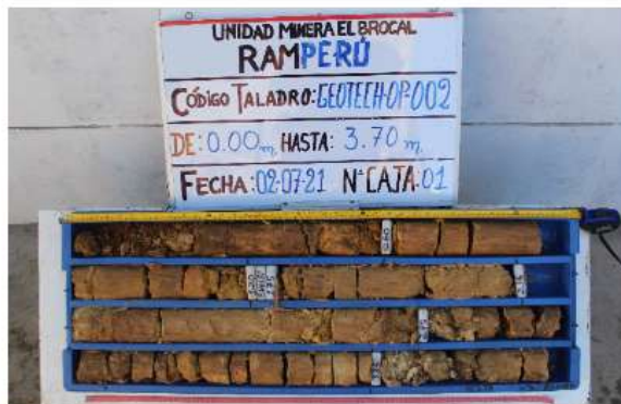
Foto de la primera caja Geotech_OP_002
