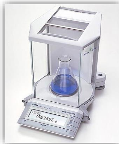
Balanza analítica de cuatro cifras decimales (Mettler Toledo AG 204)
