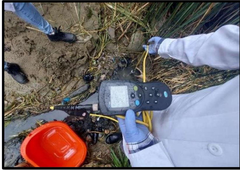
Figura 35. Toma de datos de temperatura y pH con el multiparámetro.
