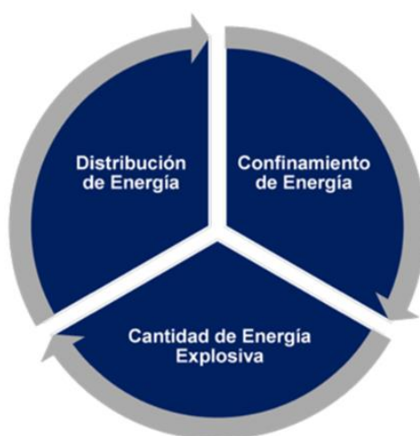
Figura 6. Parámetros que afectan al rendimiento de una voladura.
