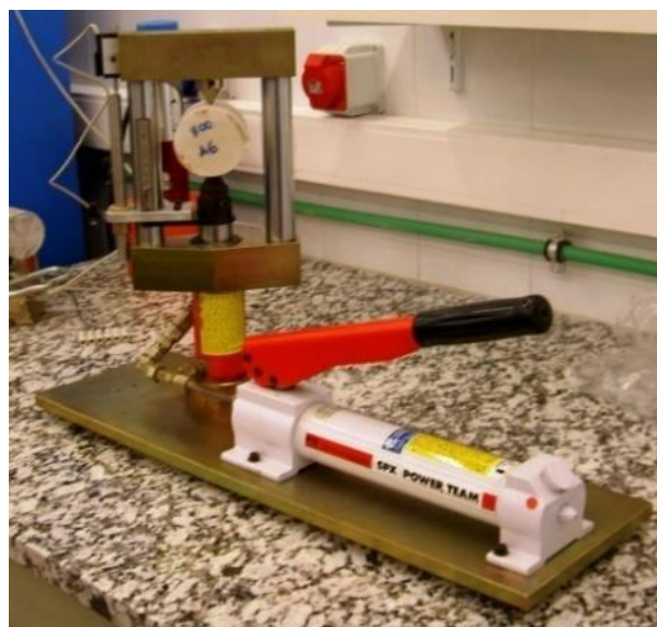
Figura 1. Ensayo de Carga Puntual
