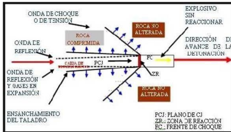
Figura 10 Mecanismo del fracturamiento del macizo rocoso
