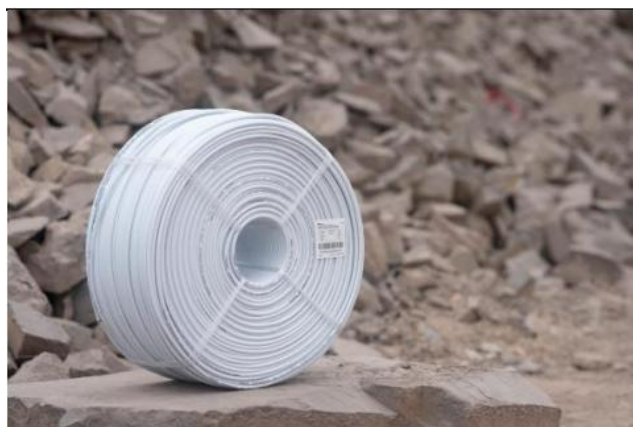
Figura 15 Muestra de la mecha de seguridad
