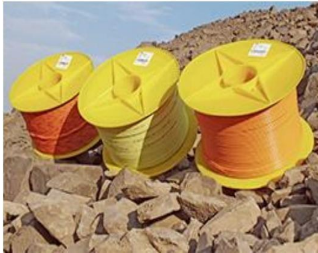
Figura 18 Muestra del cordón detonante
