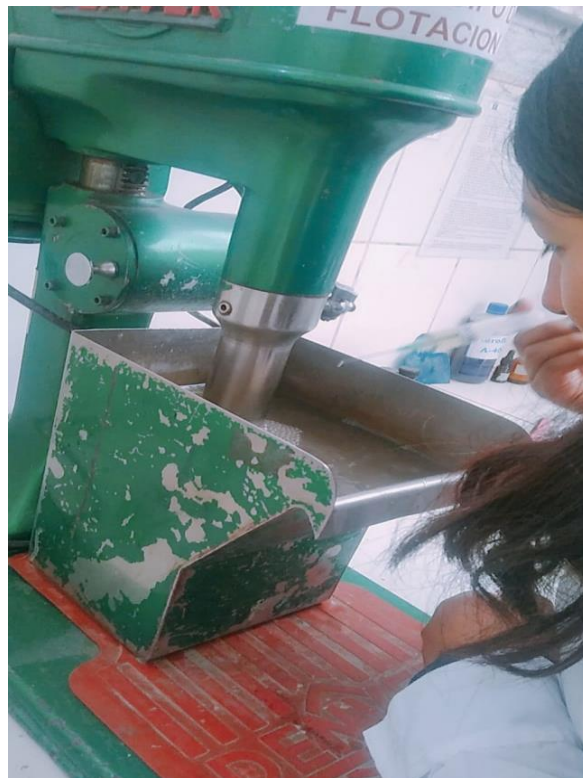
Fotografía 6. Acondicionamiento del mineral
