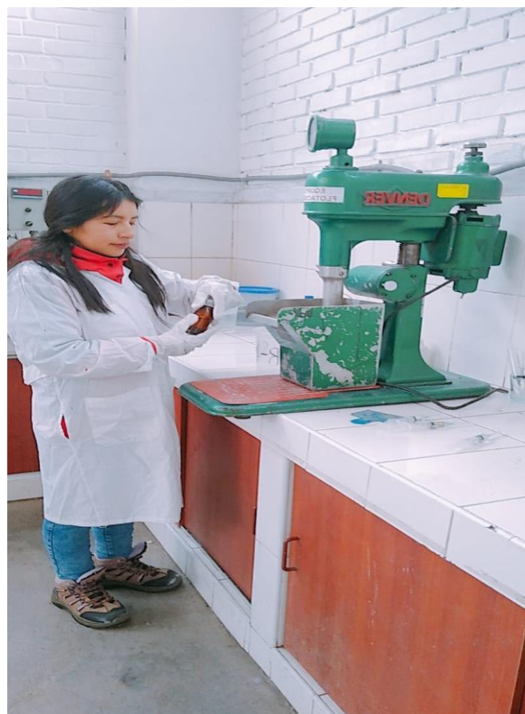
Fotografía 8. Dosificación de espumante
