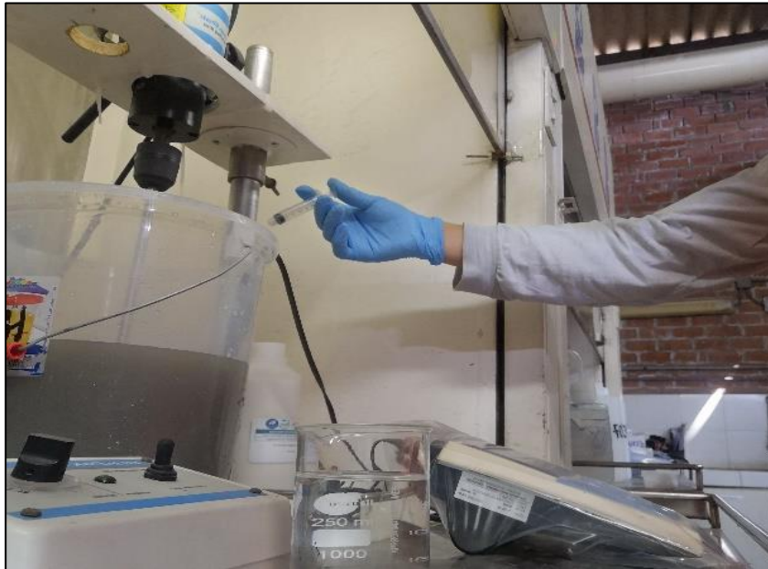
Fotografía 9: Dosificación de lechada de cal.
