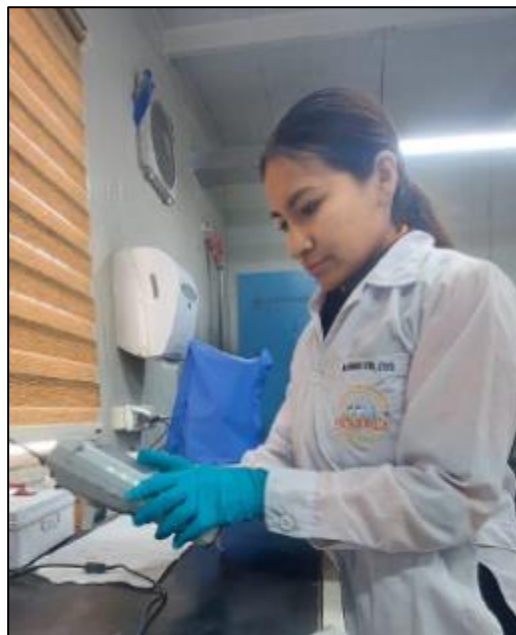
Fotografía 13: Medición de turbidez de la solución clarificada.
