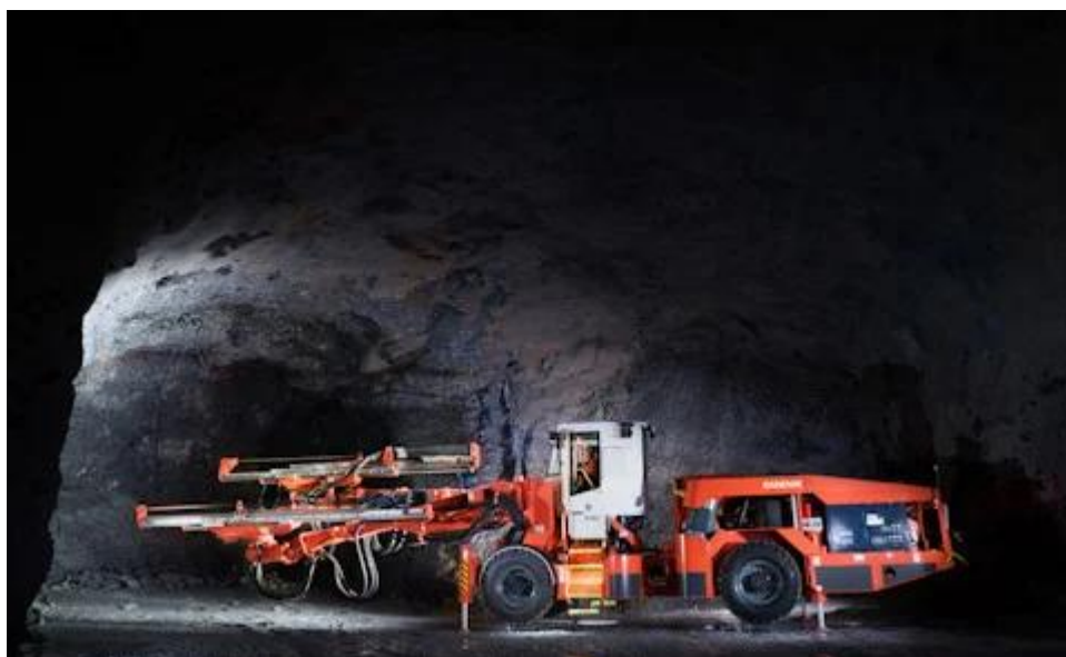
Figura 2. Perforación con jumbo electrohidráulico.
