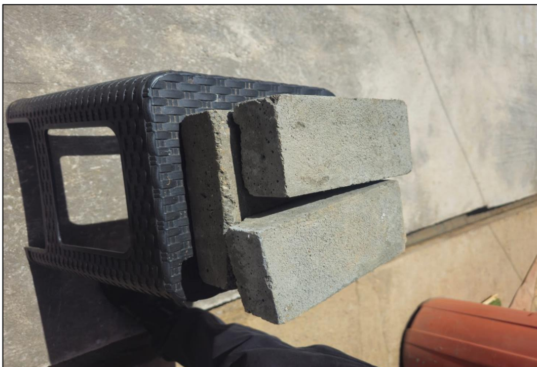
Fotografía 23. Transcurridas 24 horas del vaciado y fraguado inicial, los adoquines de concreto fueron desmoldados y sometidos al proceso de curado, con el fin de garantizar el adecuado desarrollo de sus propiedades mecánicas.
