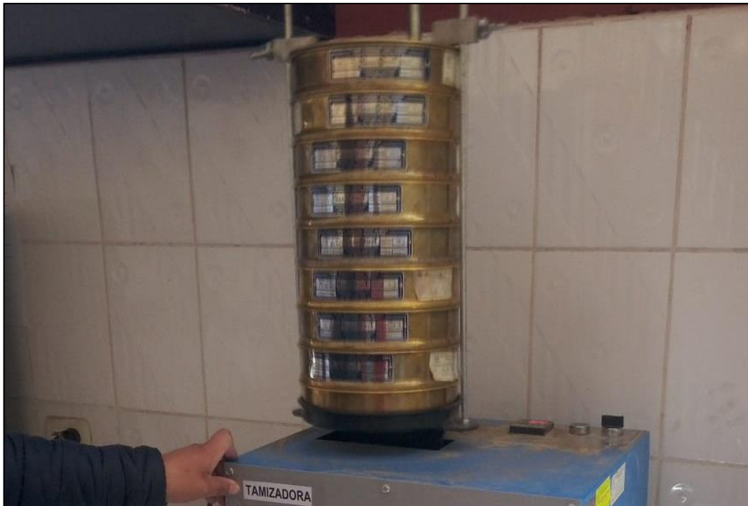
Fotografía 3. Tamizamos el agregado grueso, fino y relave minero para obtener las cantidades de agregados por tamiz para el ensayo de granulometría y obtener el módulo de finura.
