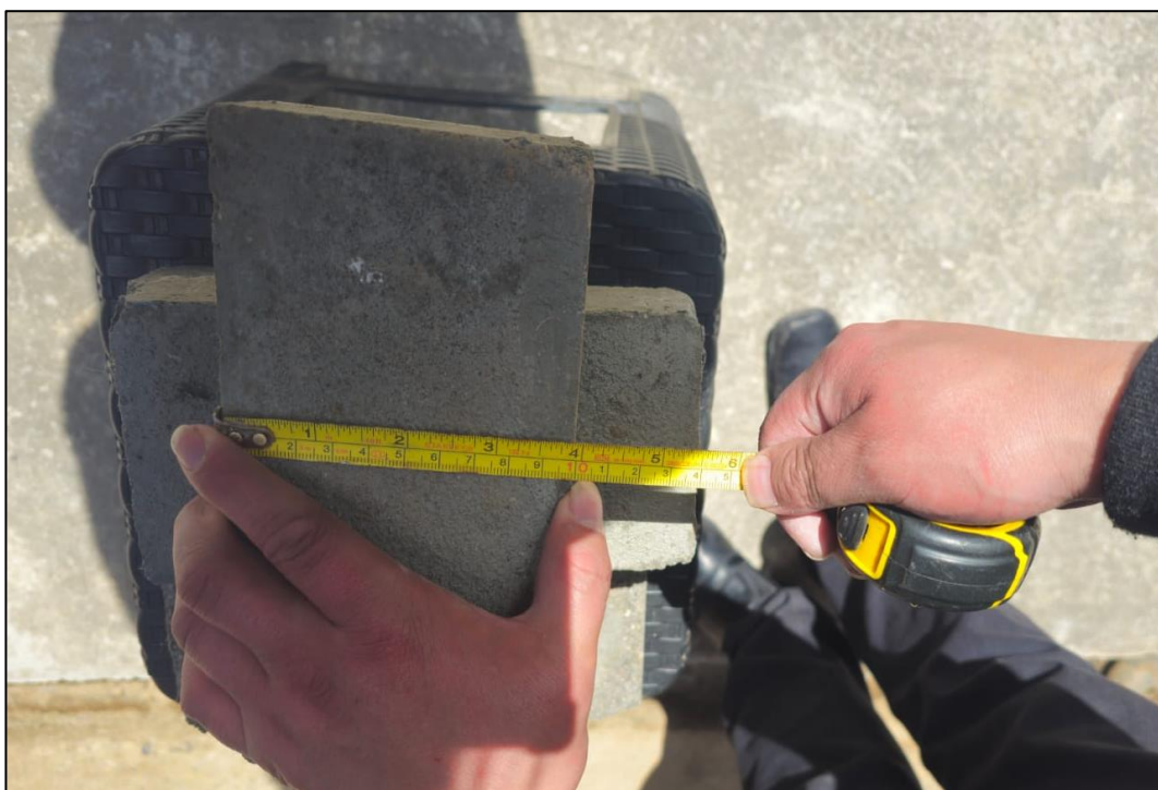
Fotografía 25. Se procedió a realizar la medición de las dimensiones del adoquín (altura, largo y ancho) utilizando instrumentos de precisión, con el propósito de determinar su volumen geométrico. Posteriormente, se relacionó este valor con el peso obtenido en balanza digital, permitiendo así calcular el peso unitario del adoquín, parámetro que contribuye a evaluar su compacidad y calidad estructural.
