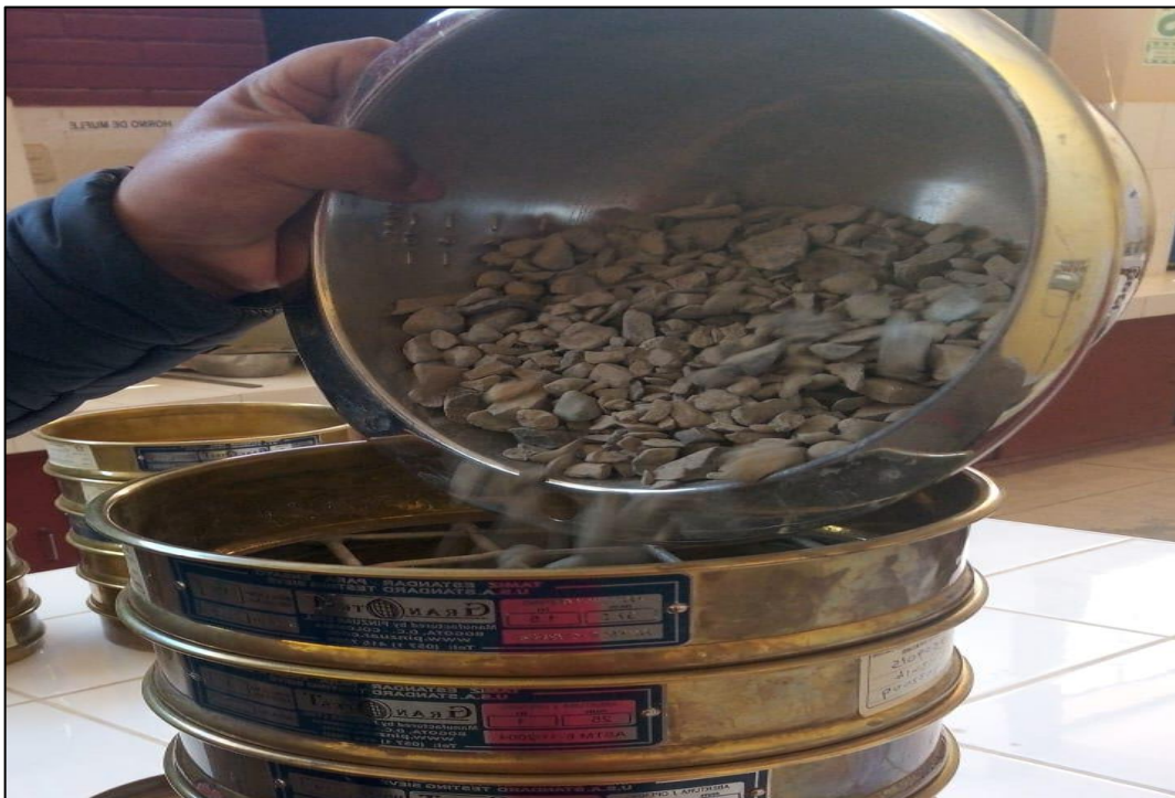
Fotografía 2. Se empieza a realizar el ensayo de granulometría según las normas técnicas vigentes para el agregado fino, grueso y relave minero después del cuarteo correspondiente.
