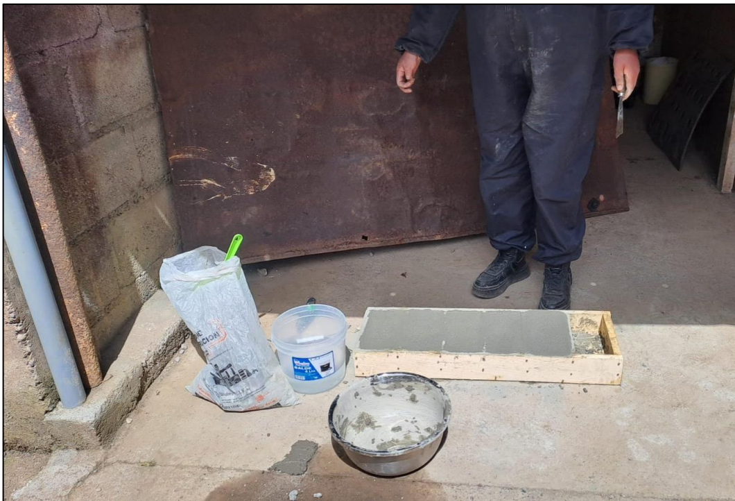
Fotografía 22. Empezamos a llenar los moldes de 10 cm x 20 cm x 6 cm con el concreto experimental mezclado para obtener adoquines y hacer posteriormente los ensayos de compresión.
