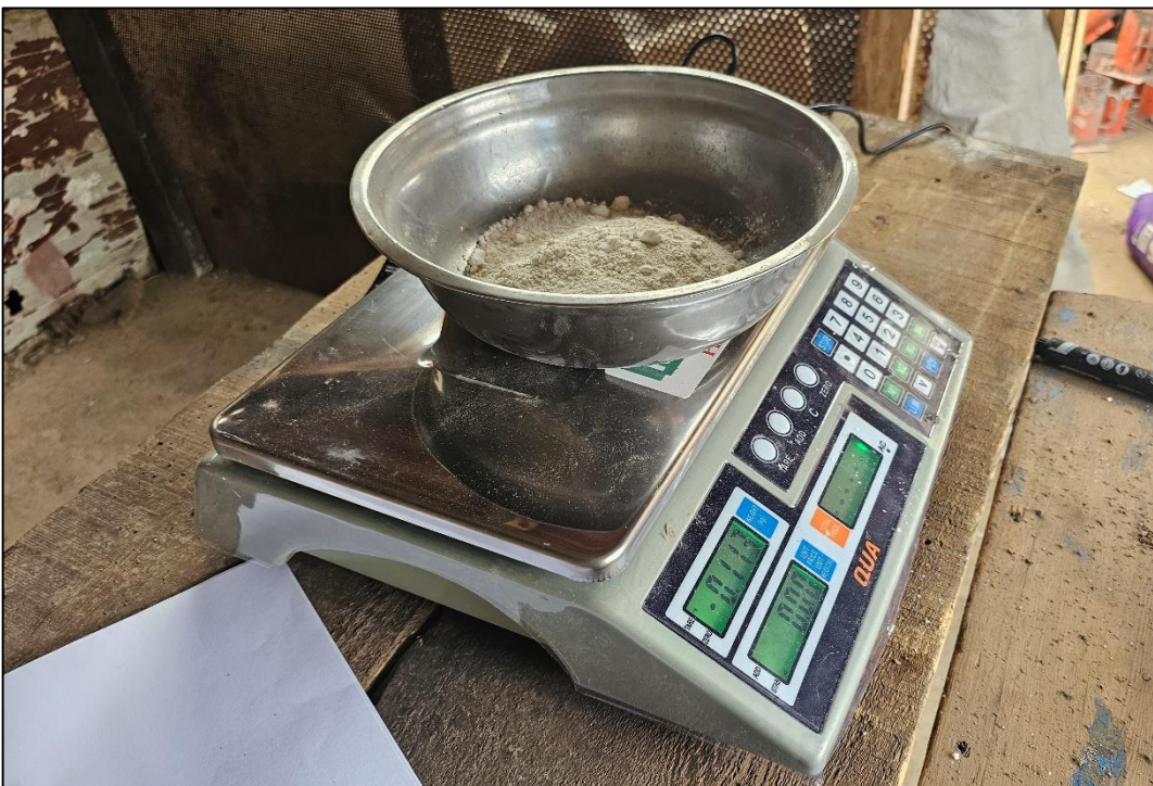
Fotografía 18. Empezamos a pesar cada material; agregado fino, agregado grueso, cemento, agua y para el concreto experimental pesamos la cal.
