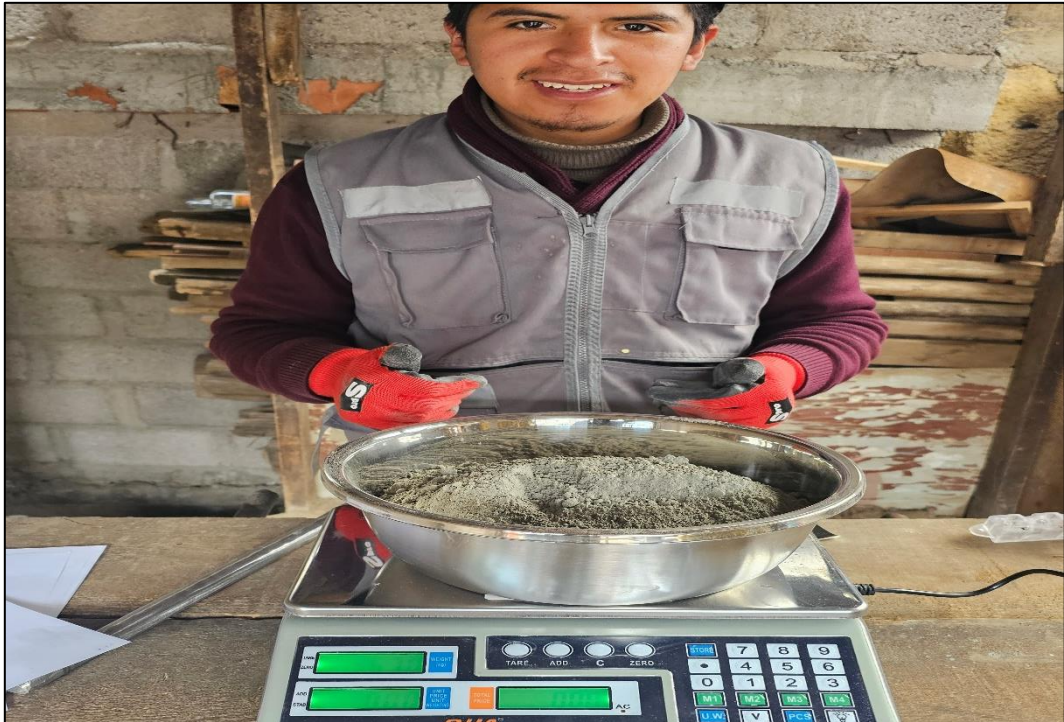
Fotografía 9. Empezamos a pesar cada material; agregado fino, agregado grueso, cemento, agua y para el concreto experimental pesamos el relave minero.
