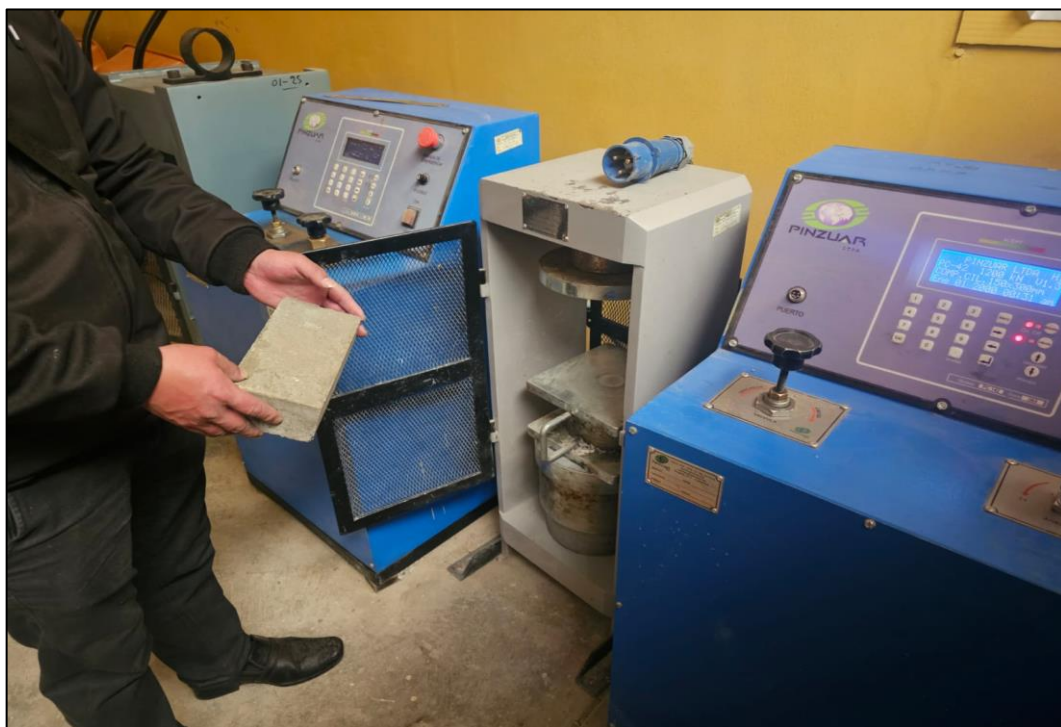
Fotografía 29. Preparamos los adoquines generales y experimentales para realizar los ensayos de compresión y así obtener la resistencia de cada adoquín.
