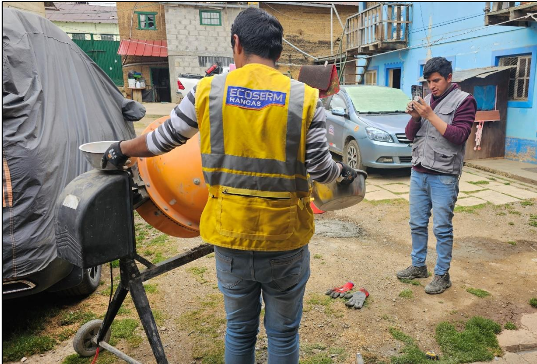
Fotografía 19. Realizamos la mezcla del concreto experimental reemplazando una proporción del cemento por cal (5%, 10% y 15%), y agregado fino por relave minero (30%, 40% y 50%), para comparar con el diseño patron (B, C, D, E y F).
