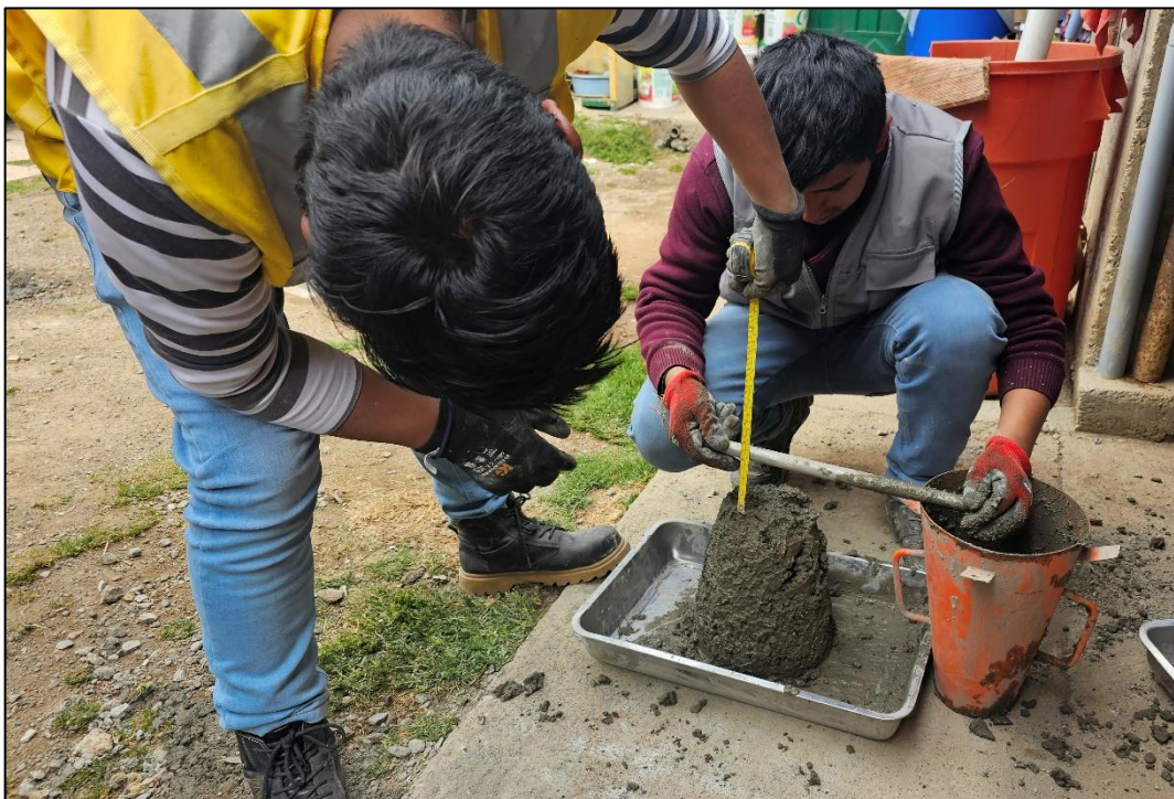
Fotografía 20. Realizamos el ensayo del cono de abrams para obtener el asentamiento (Slump) del concreto experimental, patron B, C, D, E y F.
