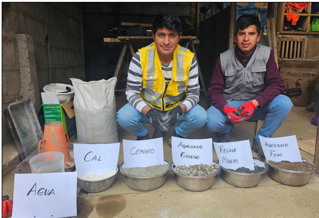
Fotografía 6. Después de obtener los resultados de las propiedades físicas de cada agregado y del relave minero empezamos a realizar los diseños de mezcla del concreto tradicional y experimental y realizamos cada mezcla de concreto empezando con el patron A (tradicional).
