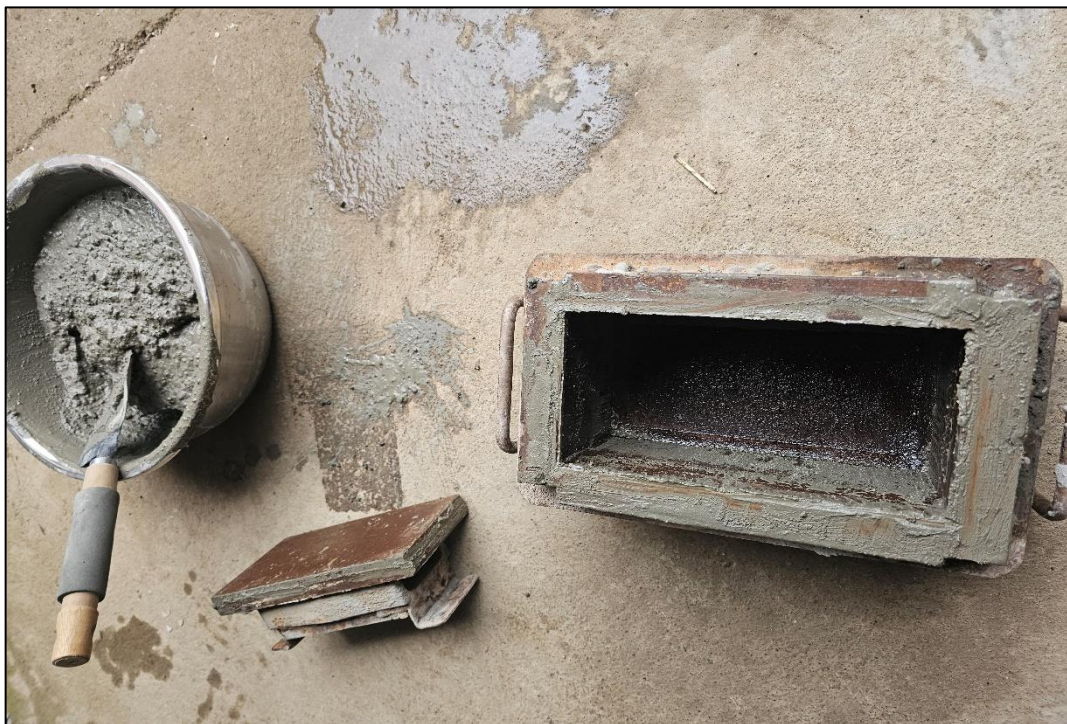
Fotografía 16. Se procedió al llenado de los moldes con dimensiones de 10\text{ cm} \times 20\text{ cm} \times 6\text{ cm} utilizando la mezcla correspondiente al patrón A, con el propósito de obtener los adoquines que posteriormente serían empleados en el ensayo de resistencia a la compresión.
