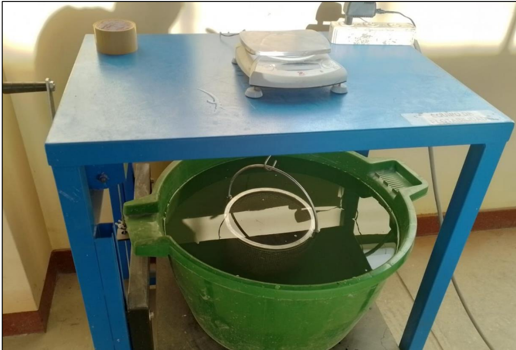
Fotografía 5. Realizamos el ensayo del peso específico y absorción del agregado grueso de la cantera Cochamarca con las respectivas normas técnicas vigentes.
