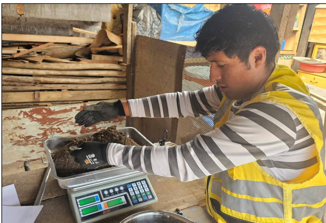
Fotografía 8. Empezamos a pesar cada material; agregado fino, agregado grueso, cemento, agua y para el concreto experimental pesamos el relave minero.
