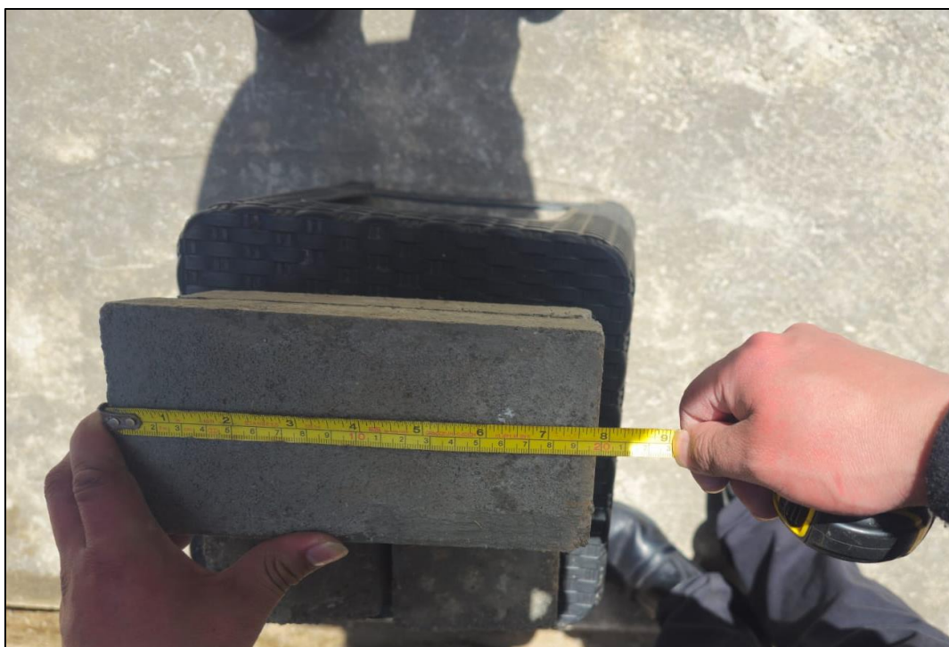
Fotografía 24. Se procedió a realizar la medición de las dimensiones del adoquín (altura, largo y ancho) utilizando instrumentos de precisión, con el propósito de determinar su volumen geométrico. Posteriormente, se relacionó este valor con el peso obtenido en balanza digital, permitiendo así calcular el peso unitario del adoquín, parámetro que contribuye a evaluar su compacidad y calidad estructural.
