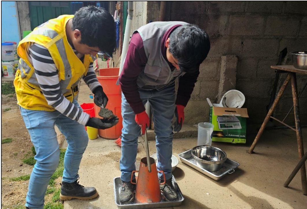
Fotografía 13. Empezamos a realizar el ensayo de asentamiento para obtener el Slump del patron A de la mezcla de diseño correspondiente.
