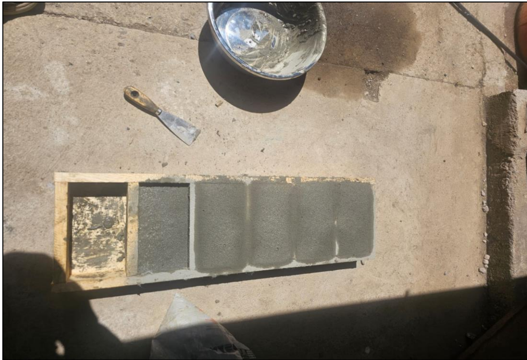
Fotografía 21. Se procedió al llenado de los moldes de 10 cm × 20 cm × 6 cm con el concreto experimental preparado, con la finalidad de obtener los adoquines destinados a los ensayos posteriores de resistencia a la compresión.
