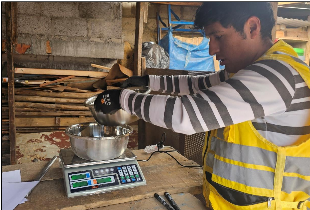
Fotografía 10. Empezamos a pesar cada material; agregado fino, agregado grueso, cemento, agua y para el concreto experimental pesamos el relave minero.
