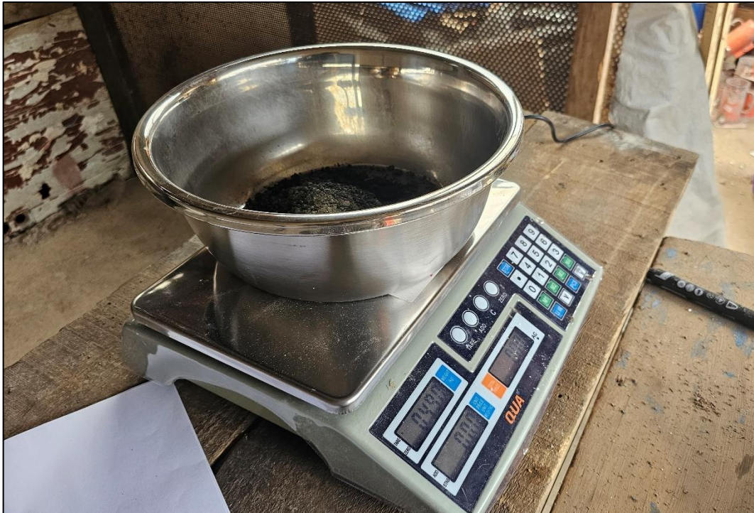
Fotografía 17. Empezamos a pesar cada material; agregado fino, agregado grueso, cemento, agua y para el concreto experimental pesamos el relave minero.
