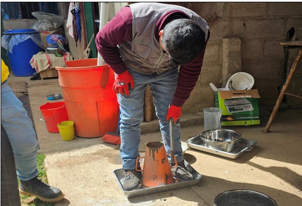
Fotografía 14. Empezamos a realizar el ensayo de asentamiento para obtener el Slump del patron A de la mezcla de diseño correspondiente. Se realiza los 25 golpes por capa según las normas vigentes.
