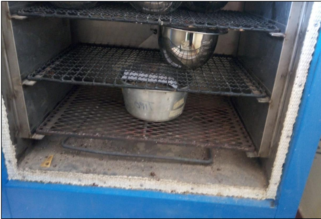
Fotografía 1. Se realiza el secado en el horno por 24 horas aproximadamente de los agregados grueso, finos y relave minero extraídos de la cantera Cochamarca para realizar los ensayos correspondientes de acuerdo a norma.
