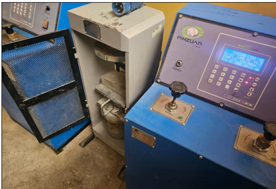
Fotografía 30. Se prepararon los adoquines generales y experimentales con el propósito de someterlos a los ensayos de compresión, con el fin de determinar la resistencia específica de cada unidad.
