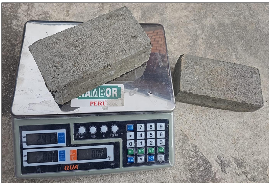
Fotografía 27. Cada adoquín fue pesado en estado seco y posteriormente en estado saturado, con el objetivo de determinar tanto la absorción de agua como el peso unitario.
