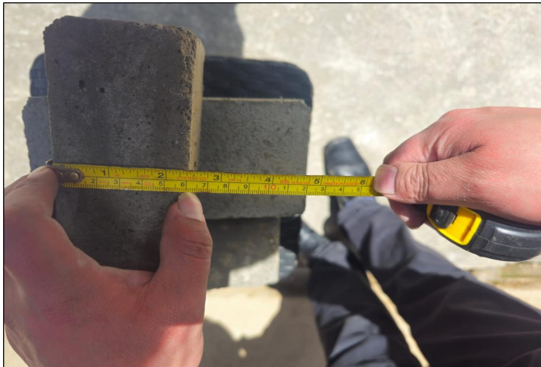
Fotografía 26. Se procedió a realizar la medición de las dimensiones del adoquín (altura, largo y ancho) utilizando instrumentos de precisión, con el propósito de determinar su volumen geométrico. Posteriormente, se relacionó este valor con el peso obtenido en balanza digital, permitiendo así calcular el peso unitario del adoquín, parámetro que contribuye a evaluar su compacidad y calidad estructural.
