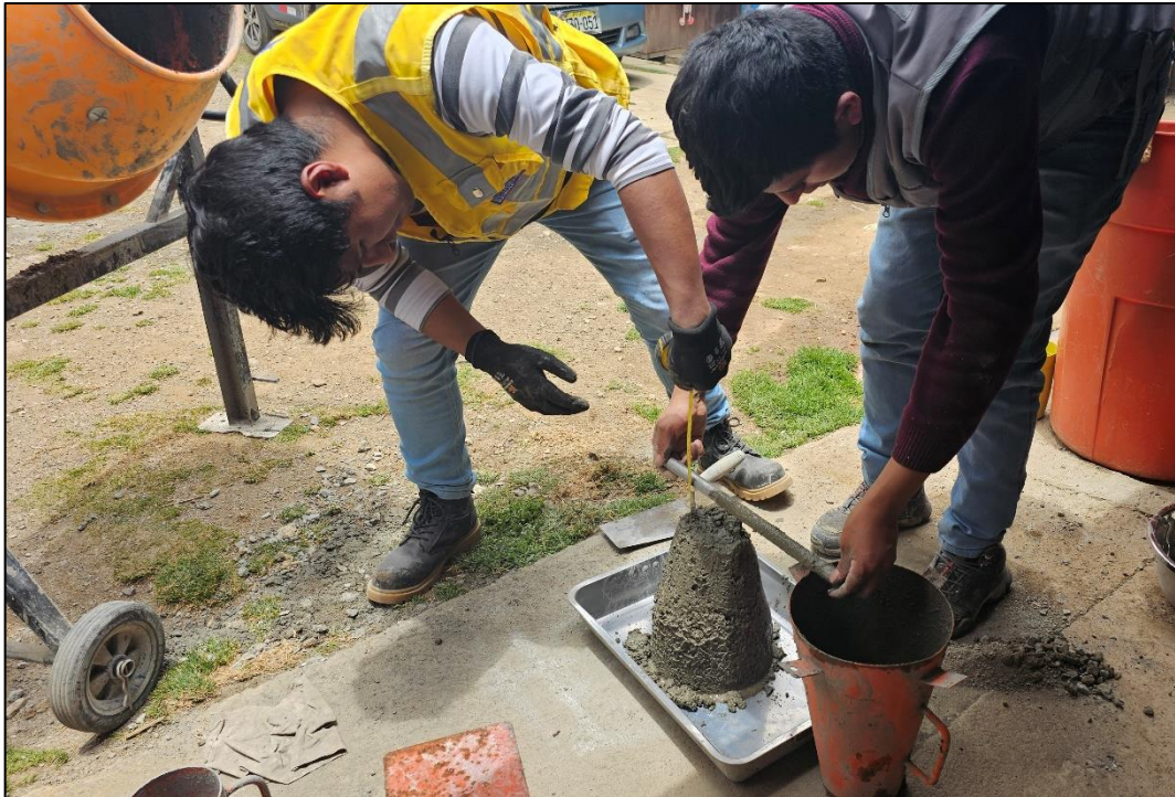
Fotografía 15. Obtenemos el primer asentamiento (Slump) del patron A para comparar posteriormente con los diseños experimentales.
