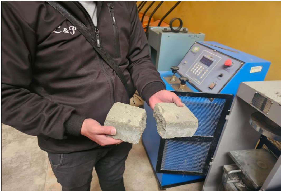
Fotografía 31. Se elaboraron los adoquines generales y experimentales con el objetivo de realizar ensayos de compresión, permitiendo así establecer la resistencia particular de cada uno.
