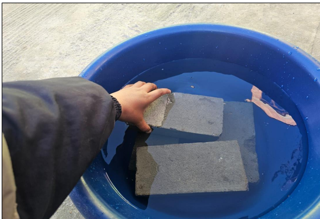
Fotografía 28. Los adoquines fueron sometidos a un proceso de curado controlado, con la finalidad de estabilizar sus propiedades y posteriormente realizar el ensayo de absorción de agua, que permite determinar la capacidad del material para retener humedad y evaluar su grado de porosidad.
