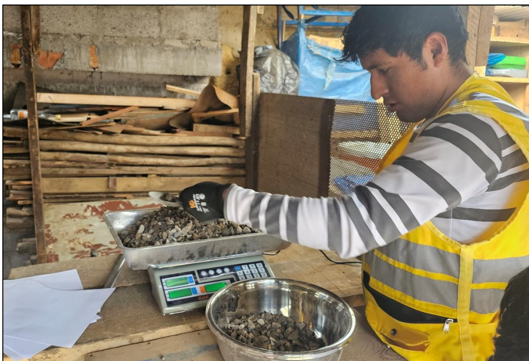
Fotografía 7. Empezamos a pesar cada material; agregado fino, agregado grueso, cemento, agua y para el concreto experimental pesamos el relave minero.
