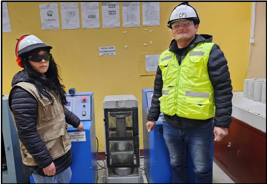
Fotografía 19. Ubicación de las probetas en la máquina de compresión con todas las precauciones correspondientes.
