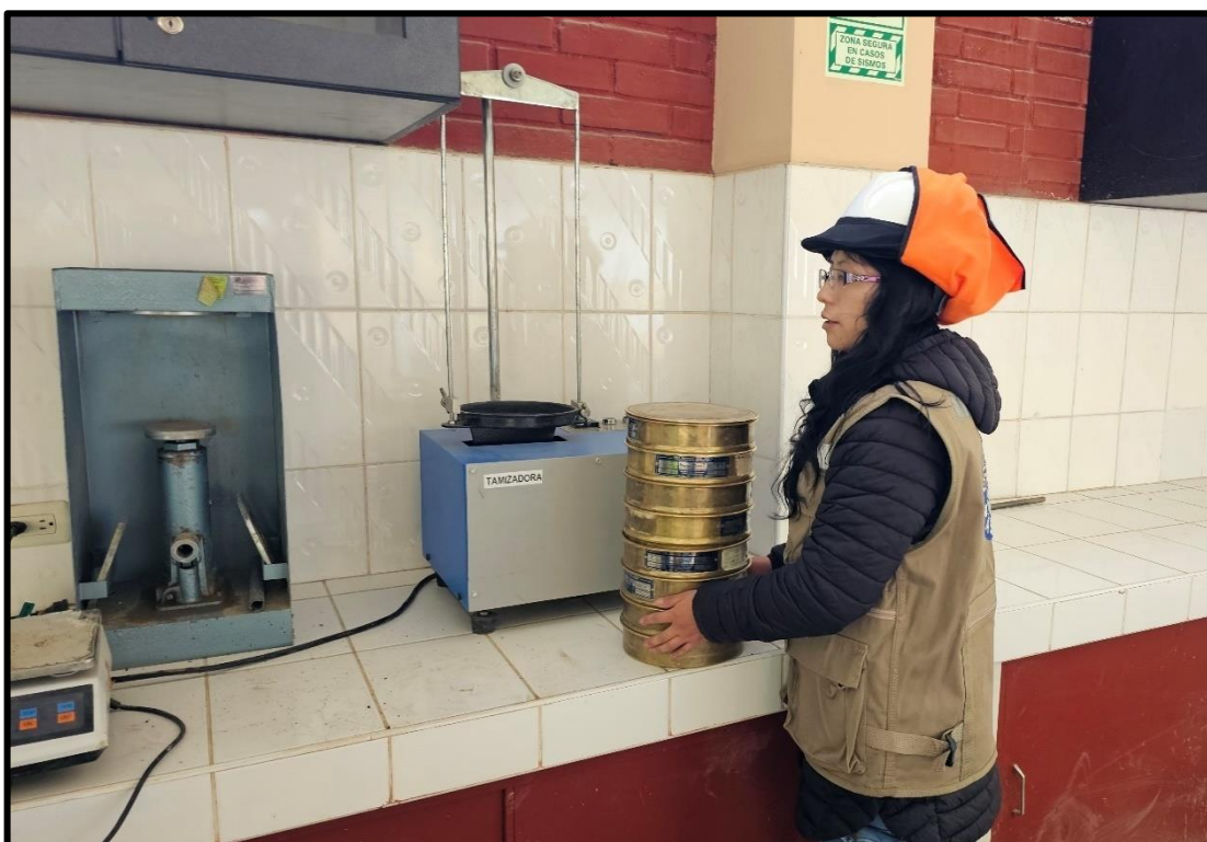
Fotografía 6. Llevada de los agregados y del ladrillo triturado a la tamizadora.
