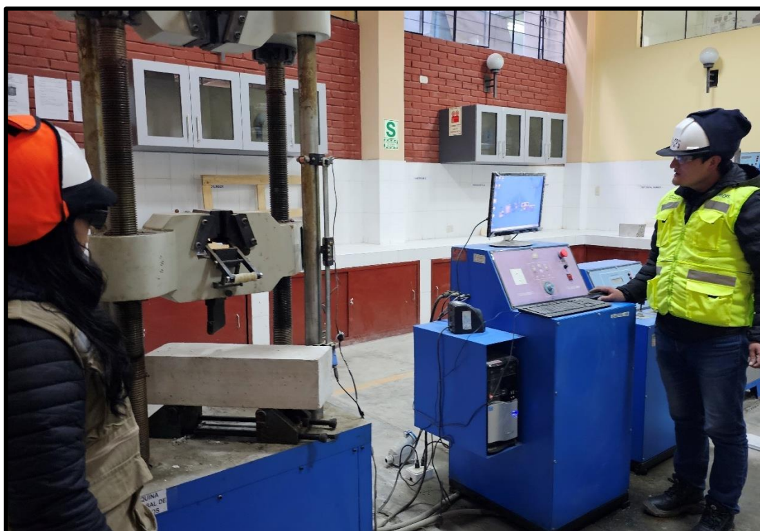
Fotografía 26. Manejo de la máquina para el ensayo de flexión del concreto natural y experimental.
