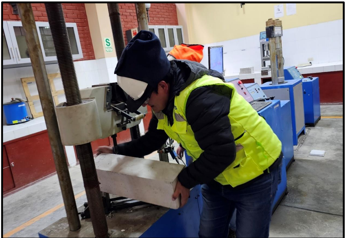
Fotografía 24. Ubicación de la viga en la máquina para el ensayo de la resistencia a la flexión.
