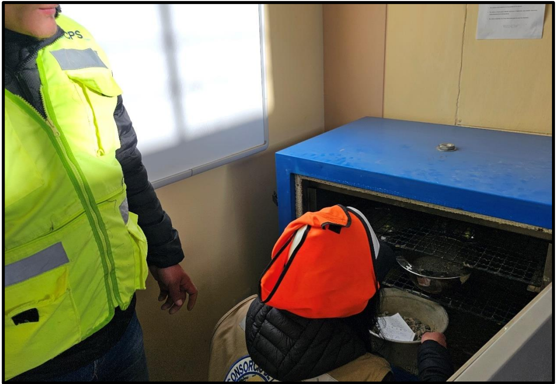
Fotografía 3. Se saca los agregados del horno y se deja reposar por una hora para poder empezar a realizar los ensayos respectivos.
