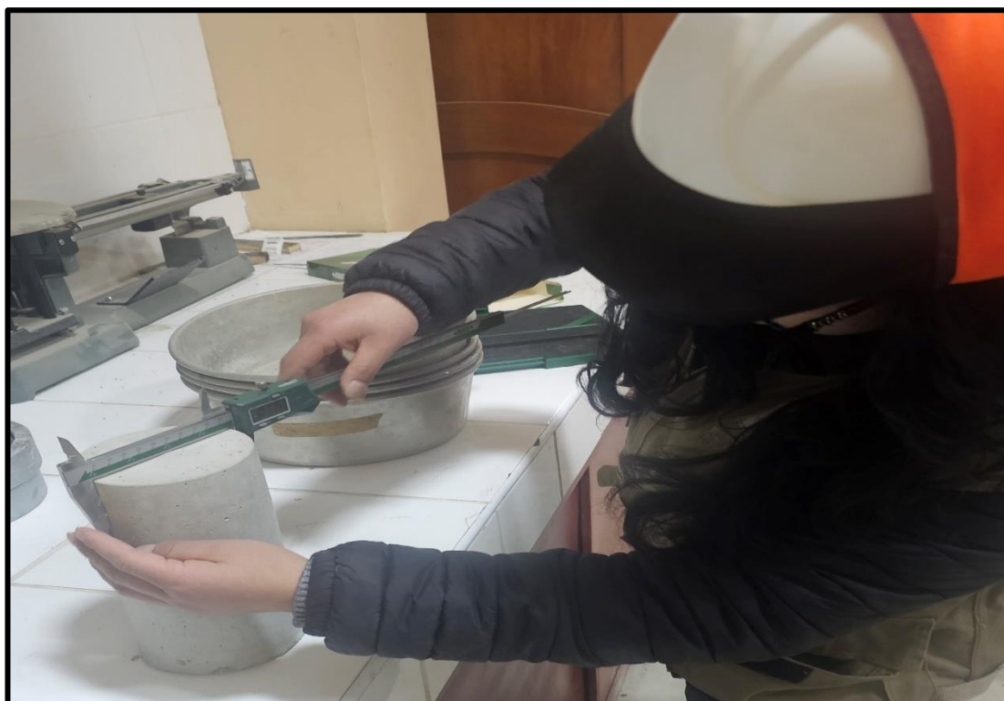
Fotografía 14. Medida del diámetro de la probeta para el peso unitario.
