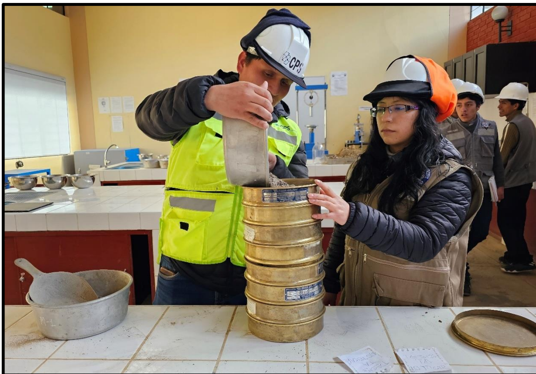
Fotografía 5. Se echa los Agregados (finos y gruesos) y el ladrillo triturado en los tamices según las normas respectivas.
