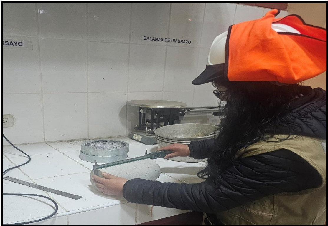
Fotografía 15. Media de la altura de la probeta para el peso unitario.
