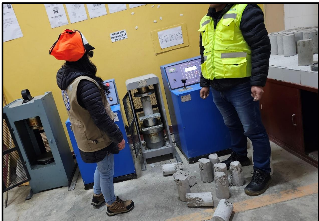
Fotografía 22. Rotura de probetas con el ensayo de resistencia a la compresión.
