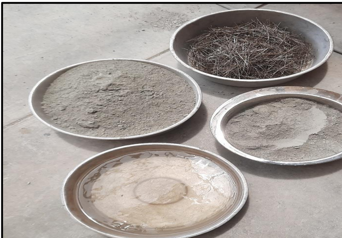
Fotografía 12. Se pesan los materiales para realizar las probetas del concreto natural y los concretos experimentales.
