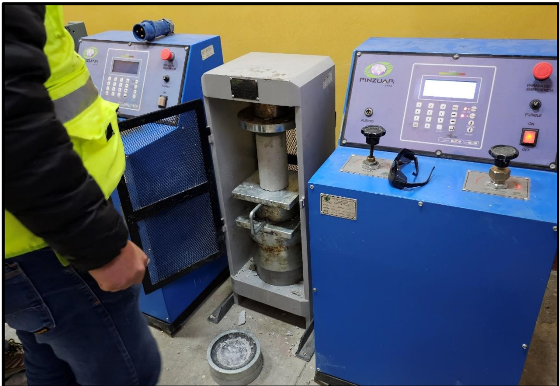
Fotografía 18. Ubicación de las probetas en la máquina de compresión.
