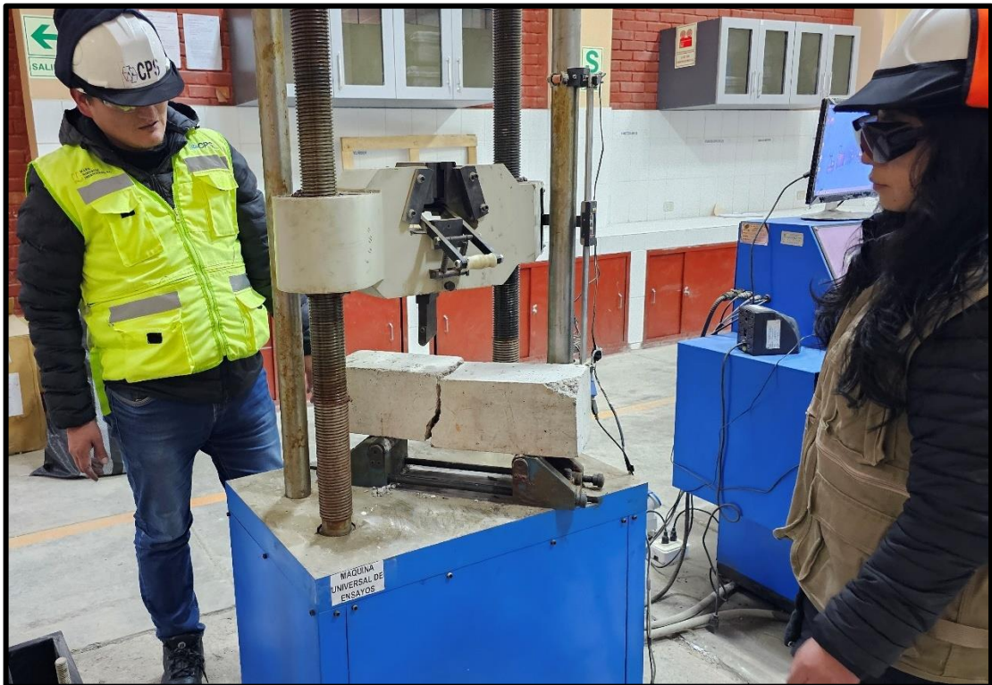
Fotografía 28. Módulo de rotura de la viga en la maquina universal de ensayos.
