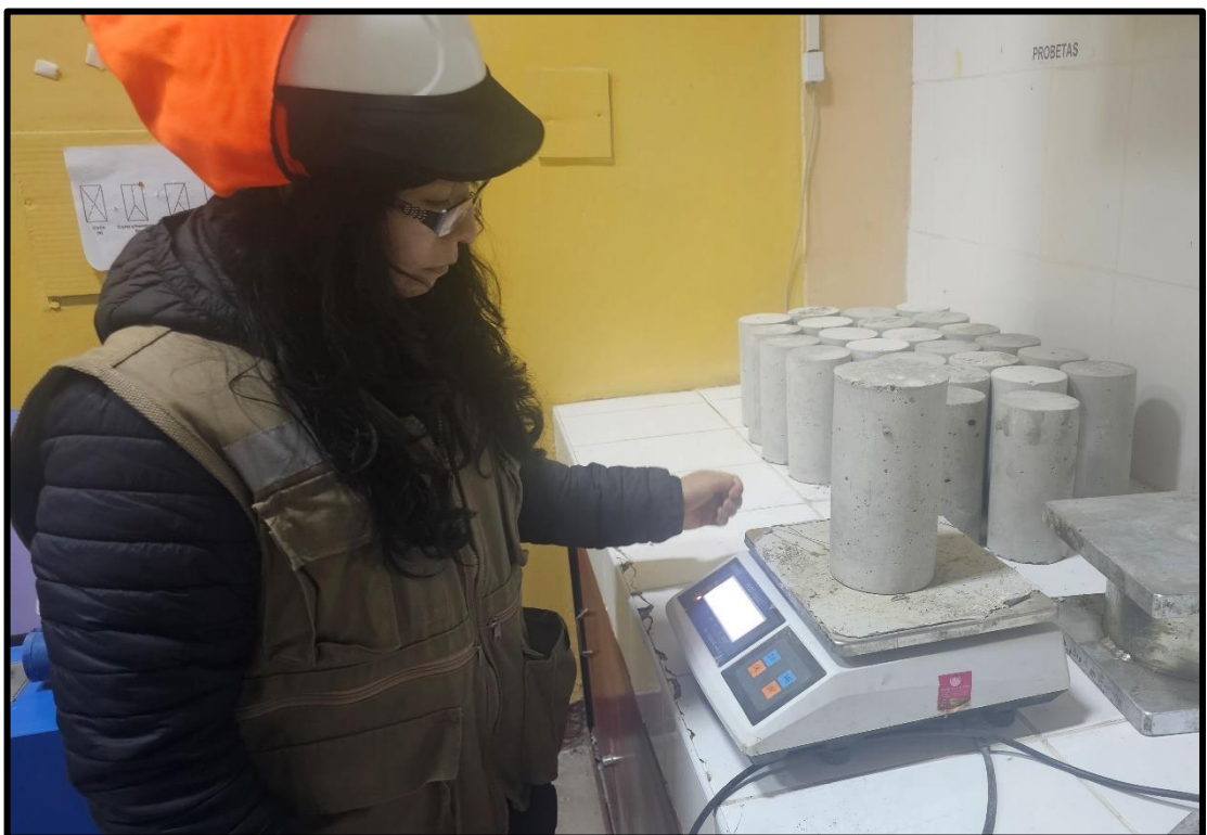
Fotografía 16. Peso de cada probeta para hallar el peso unitario.
