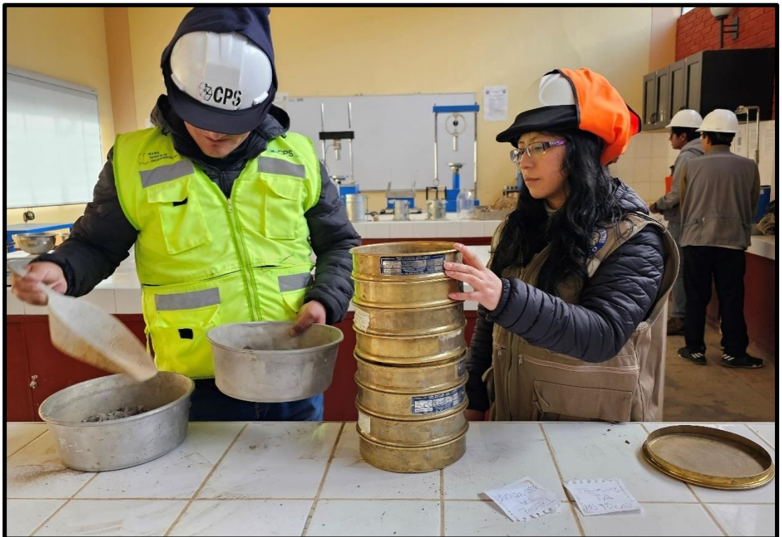
Fotografía 4. Se inicia con el ensayo granulométrico de cada agregado y del ladrillo triturado.
