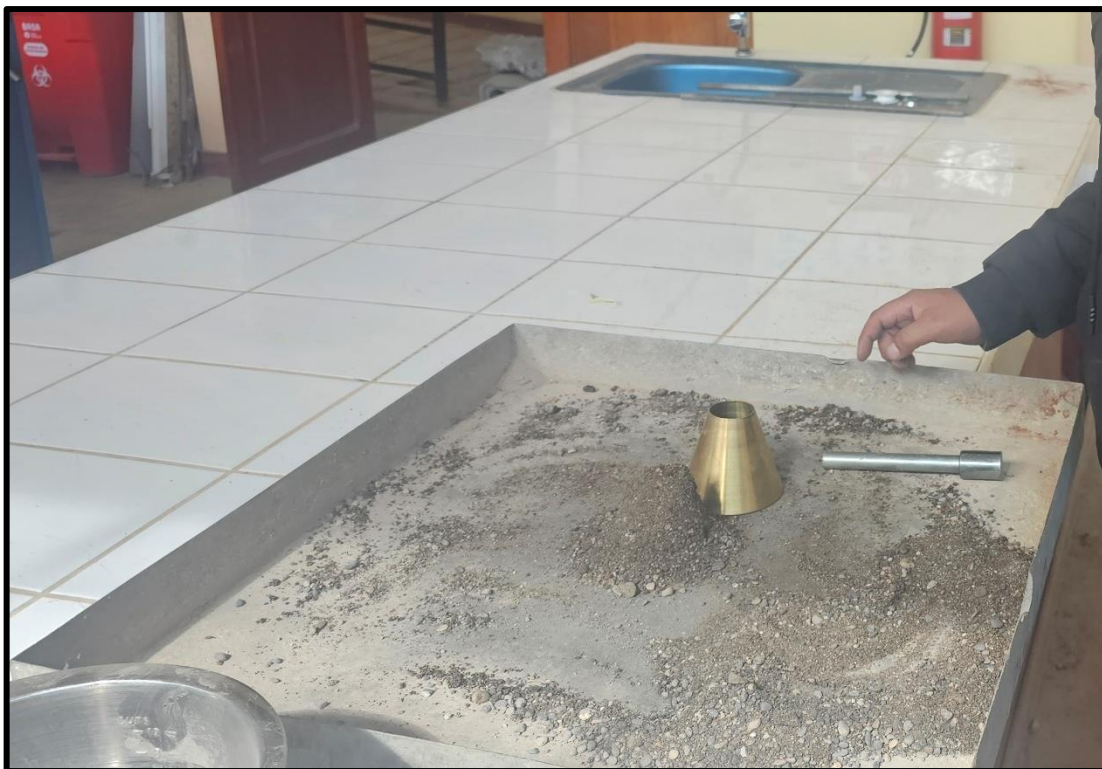
Fotografía 11. Se observa el resultado del cono para el peso específico y absorción de los agregados y del ladrillo triturado.
