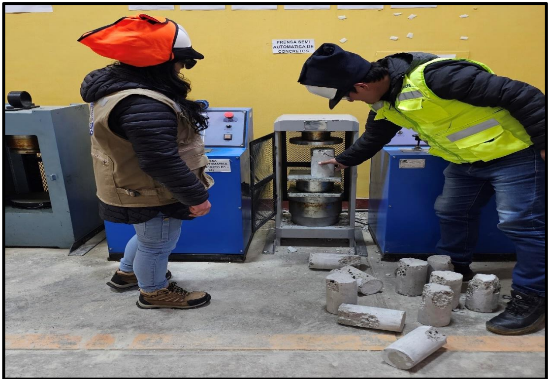
Fotografía 21. Resultado de la rotura de las probetas con los cortes según las normas.
