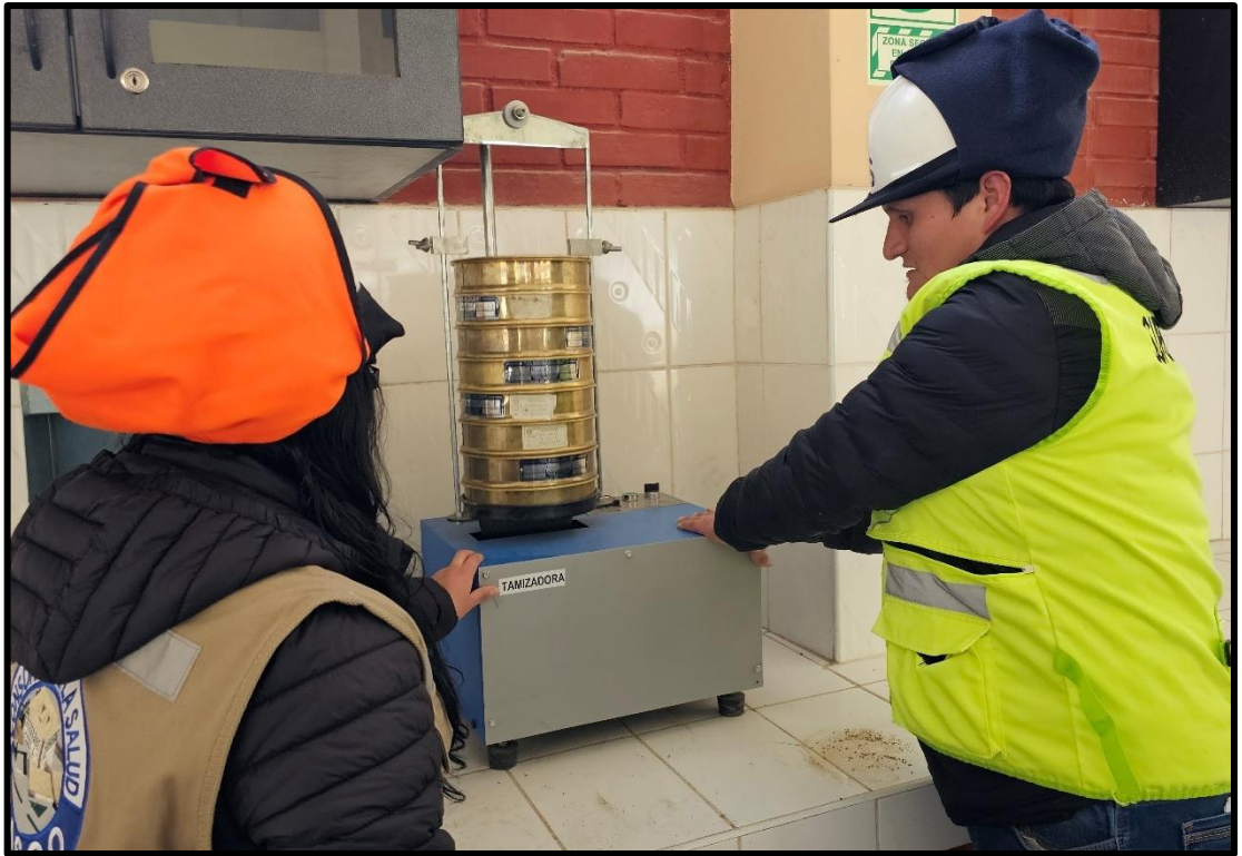
Fotografía 7. Se realiza el tamizado de cada uno de los agregados y del ladrillo triturado.
