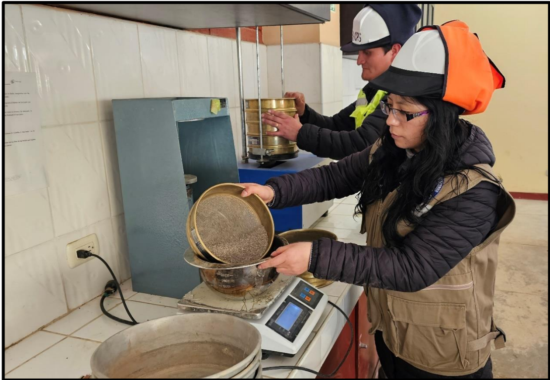
Fotografía 9. Se empieza a pesar por tamiz a los agregados y a ladrillo triturado.
