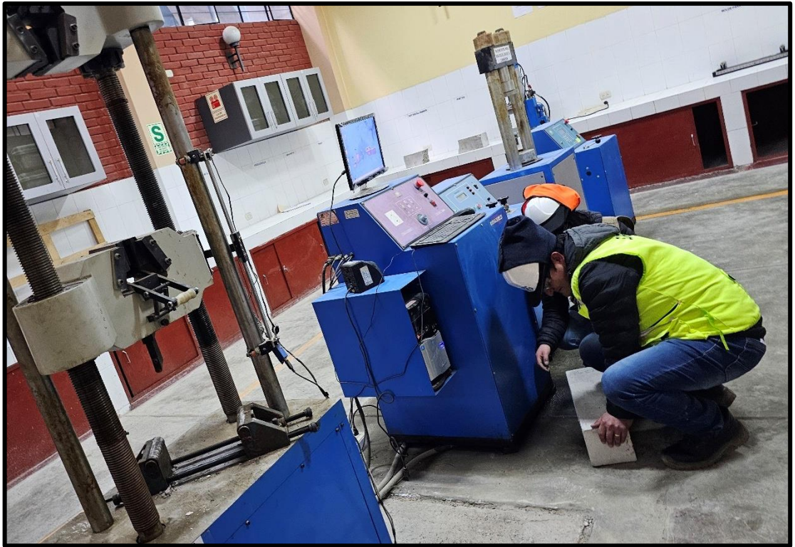
Fotografía 23. Preparación de la viga para el ensayo a la resistencia a la flexión.
