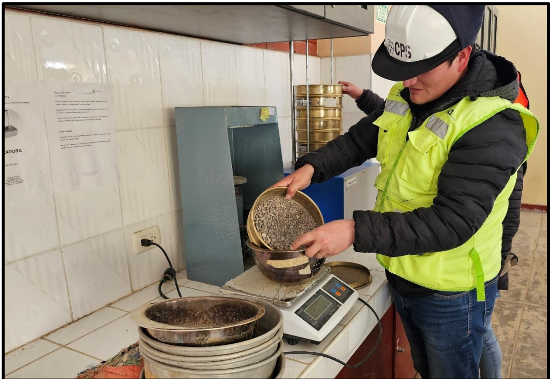
Fotografía 8. Se empieza a tamizar cada tamiz para el ensayo granulométrico.
