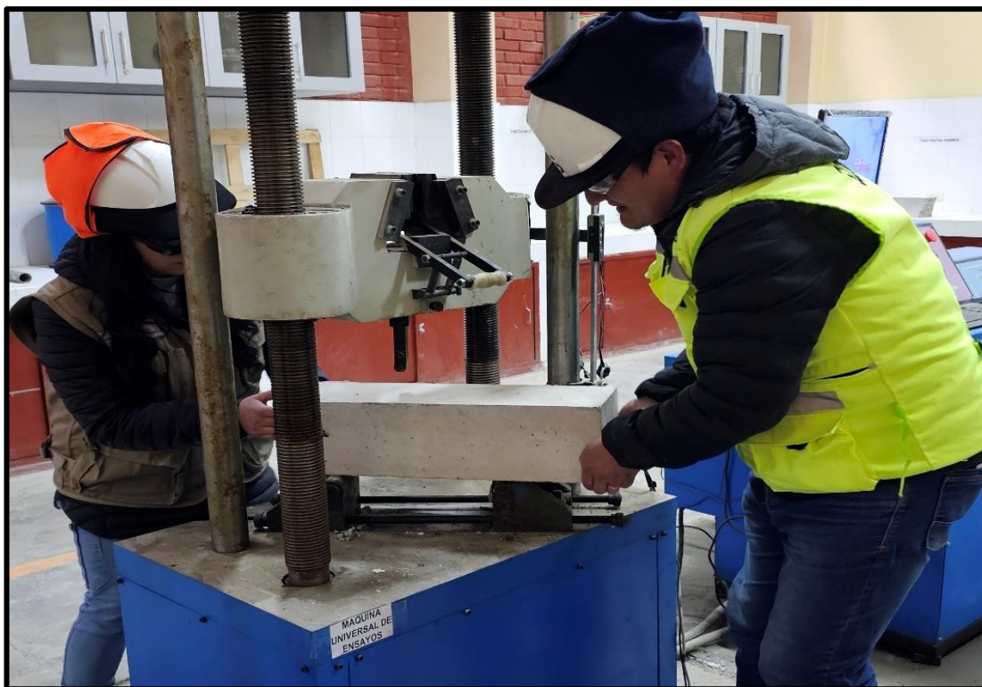
Fotografía 25. Ubicación de la viga en la máquina para el ensayo de la resistencia a la flexión.
