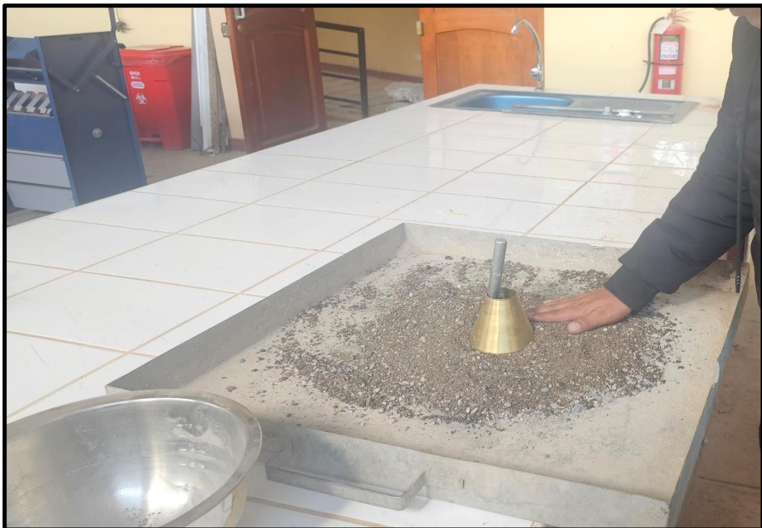
Fotografía 10. Se realiza el ensayo de peso específico y Absorción de los agregados y del ladrillo triturado.
