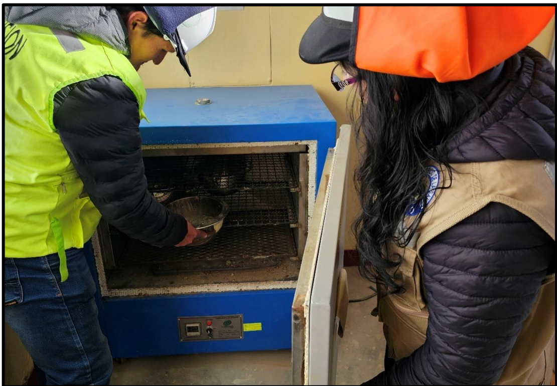
Fotografía 2. Los agregados se llevan al horno para su respectivo secado durante 24 horas para realizar los ensayos.
