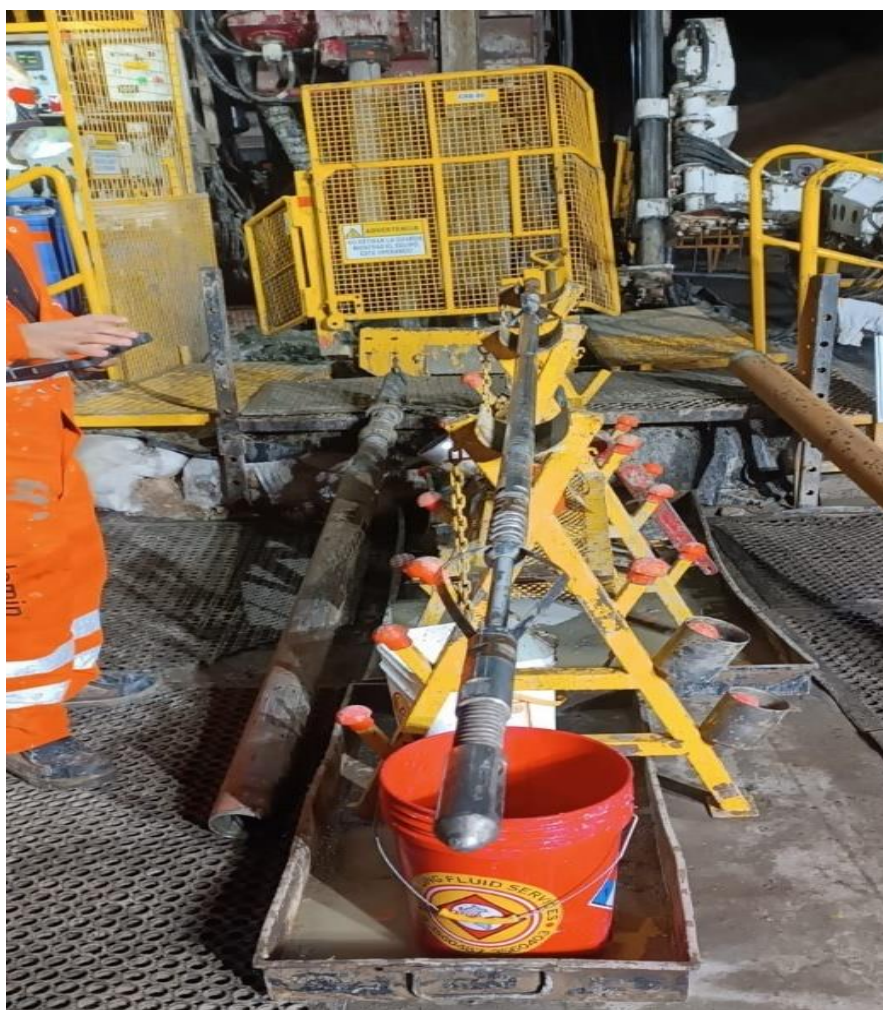
Figura 63. Vista del proceso de medición de los sondajes con el quipo ya instalado en la máquina de perforación así también supervisando el contómetro
