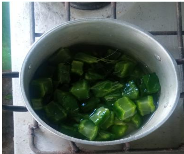
Figura 22 Comprobando la Viscosidad del Mucilago de Cactaceae
