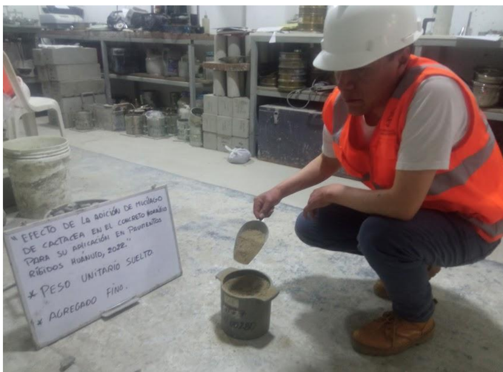
Imagen 6. Ensayo del peso unitario suelto del agregado fino
