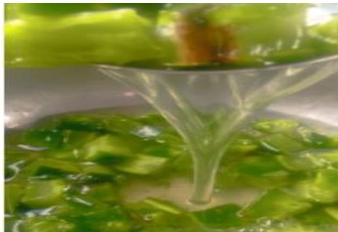
Figura 22 Comprobando la Viscosidad del Mucilago de Cactaceae
