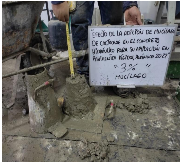
Figura 27 Fabricación y Medición del Asentamiento
