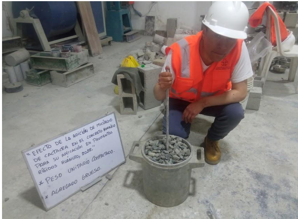
Imagen 11: Ensayo del peso unitario compactado del agregado grueso
