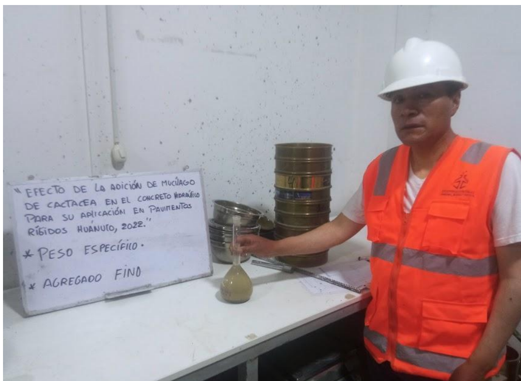
Imagen 5. Ensayo del peso específico del agregado fino
