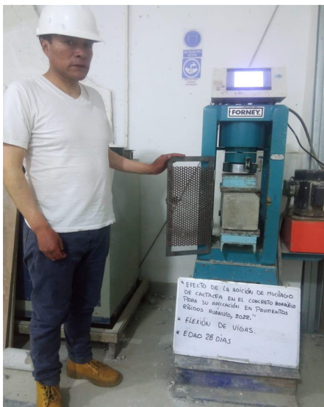
Figura 30 Ensayo de Resistencia a la Flexión
