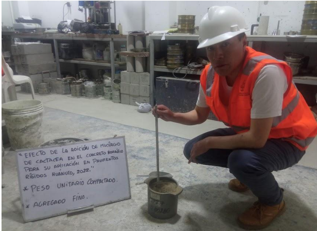
Imagen 7. Ensayo del peso unitario compactado del agregado fino
