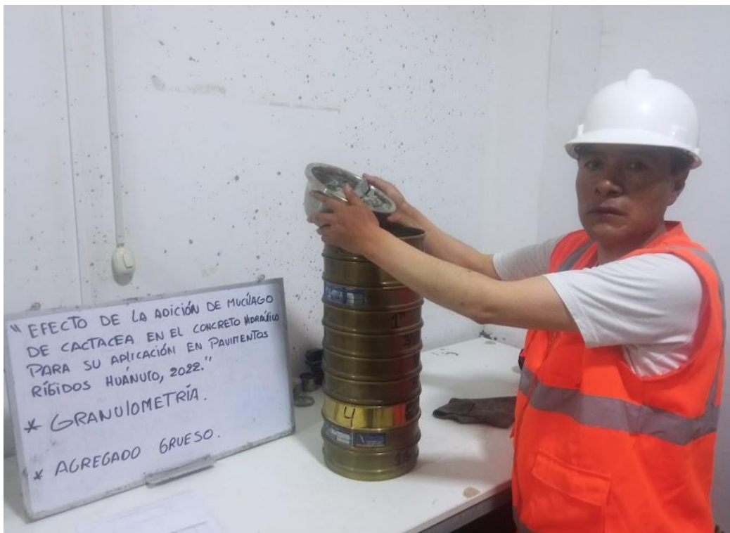
Imagen 8. Ensayo de granulometría del agregado grueso
