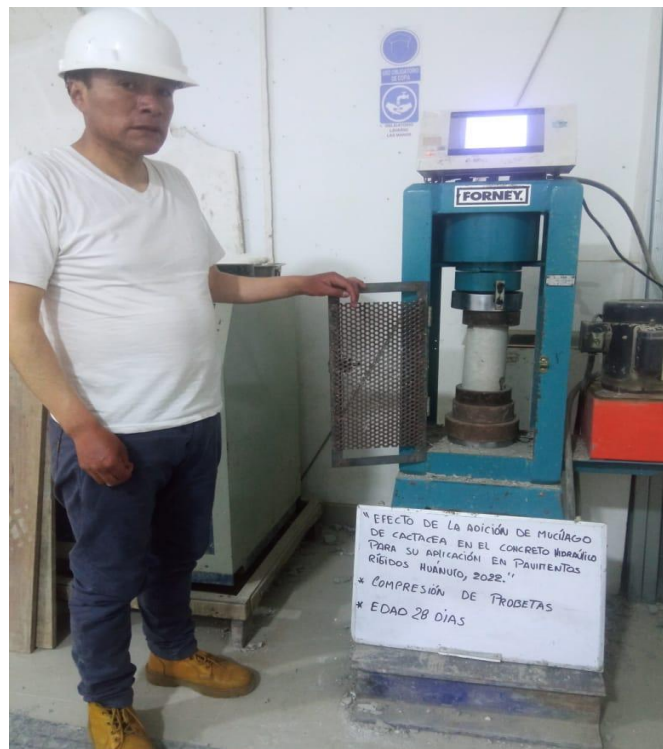
Figura 29 Ensayo de Resistencia a la Compresión
