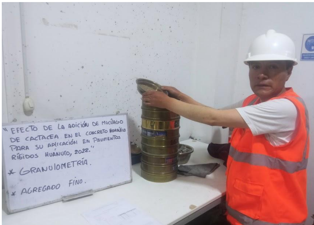
Imagen 4. Ensayo de granulometría del agregado fino
