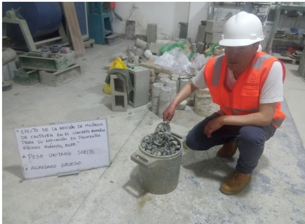
Imagen 10: Ensayo del peso unitario suelto del agregado grueso
