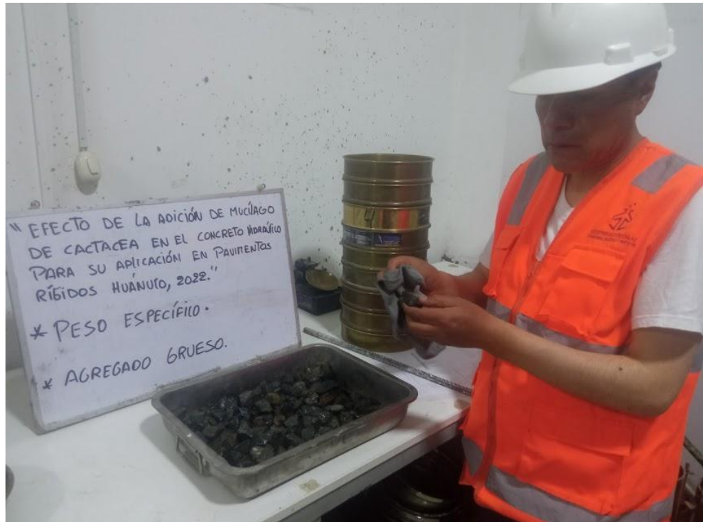
Imagen 9: Ensayo del peso específico del agregado grueso
