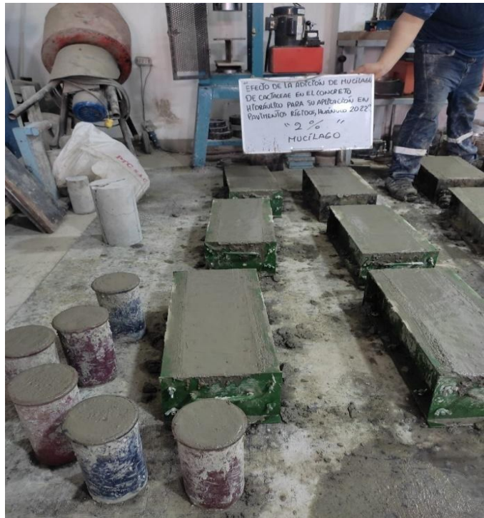
Figura 28 Fabricación de Probetas Cilíndricas de 10 cm x 20 cm y Probetas Prismáticas de 15 cm x 15 cm x 50 cm
