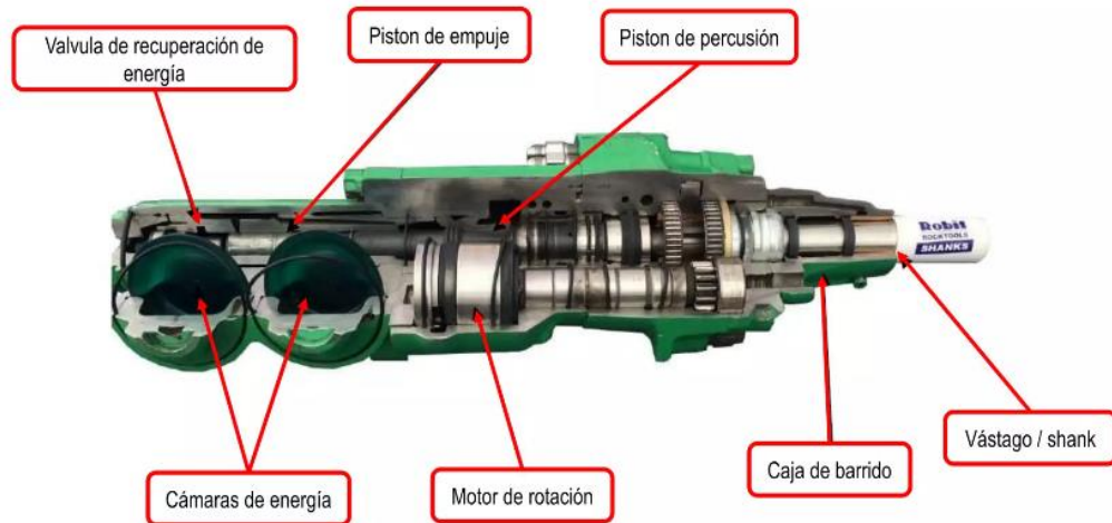
Figura 1: Partes principales de perforadora hidráulica jumbo frontonero
