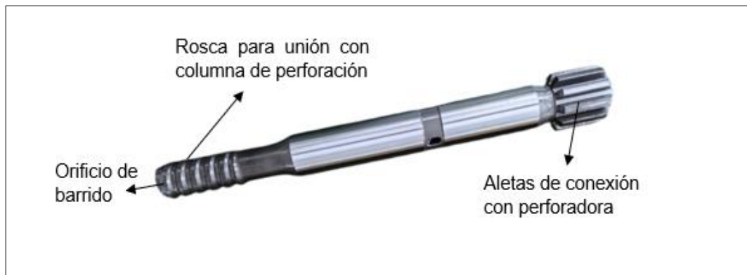
Figura 6: Shank adapter (adaptador de culata)
