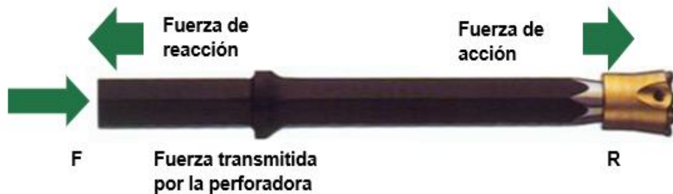
Figura 14: Fuerza transmitida de la perforadora hacia la barra y broca
