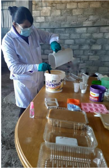
Preparado del agua con la soda caustica según las indicaciones por cada muestra.
