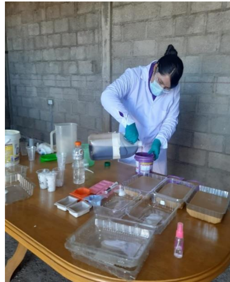
Al preparado de la soda caustica añadir aceite residual según las indicaciones por cada muestra.
