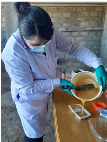
Mezclado del preparado de soda caustica con aceite residual hasta que se homogenice, batir 20 min aproximadamente y luego vaciar a los moldes.
