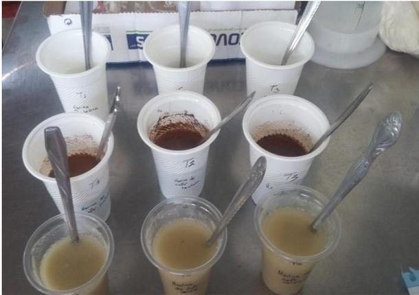
**Foto 05.** Preparación de muestras diluidas de las harinas para la determinación de pH e índice de acidez.
