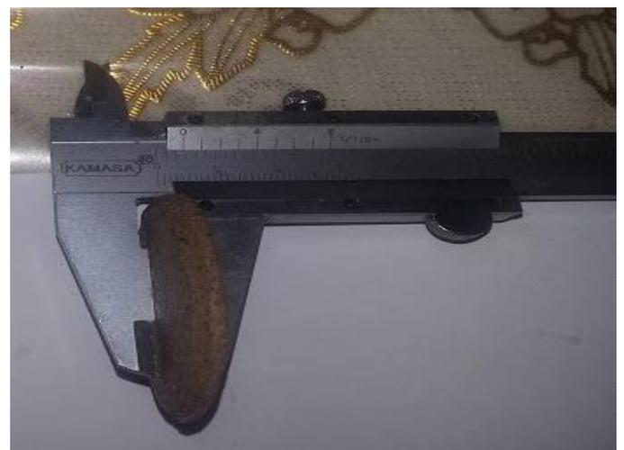
**Foto 24.** Medición del espesor de las galletas dulces.
