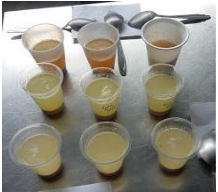
**Foto 20.** Homogenizado de las muestras de galletas para la determinación de pH e índice de acidez.
